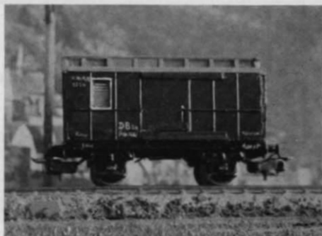
Abb. 5. Auch dieser Nebenbahn-Pack-Postwagen scheint seine Herkunft der Firma „Free & Lance“ zu verdanken: Herr Rothärmel aus Ulm baute ihn nach dem Motto „nur nichts umkommen lassen“ aus einem Märklin-Fahrgestell und den beim Bau des zweiachsigen Postwagens nach MIBA 11/XIV übrig gebliebenen Teilen des Liliput-Postwagens.
