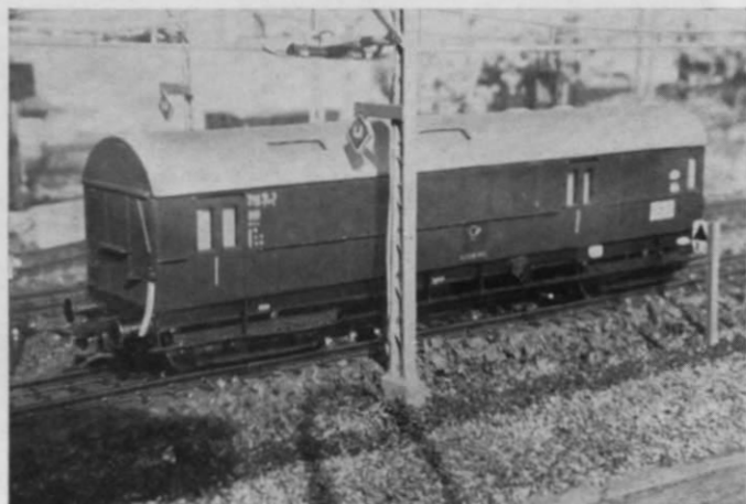
Abb. 4. Herrn P. Fuchs aus Berlin störte der oldtimerische Dachaufsatz des Liliput-Postwagens, wenn er diesen zusammen mit einem Zug aus Kitmaster-B4yge-Umbauwagen fahren ließ. Deshalb verpaßte er dem Liliput-Wagen ein Kitmaster-Dach und ließ auch das Bremserhaus weg — und der freilich etwas nach freelance aussehende Postwagen fügt sich jetzt recht gut in den Umbauwagen-Zug ein.
