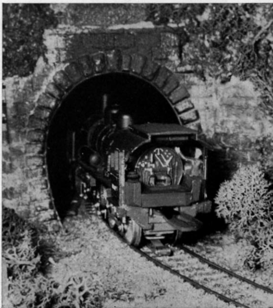
Abb. 1. Der Bleiballast im Führerstand ist deutlich zu erkennen. Auf dem Bleiklotz an der rechten Wand „sitzt“ die Dame ... pardon! — der Lokführer ohne Unterleib. Unter dem Führerstand ist der angebaute Mittelschleifer zu sehen.
