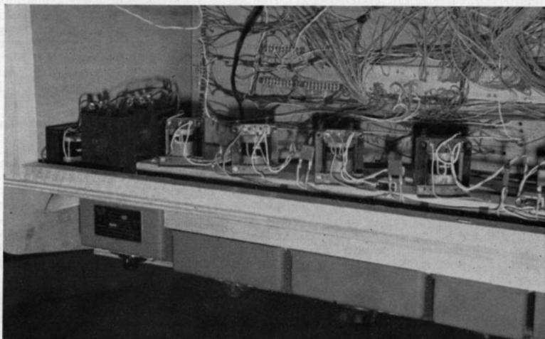
Abb. 4. Unter dem Gleisbild-Stelltisch und den Fahrtrafos befindet sich genügend Raum für die gegenseitige Verstrippung aller Schaltelemente: Die Anschlüsse zu den Relais usw. sind durch die senkrechte Montage-Zwischenwand hindurch geführt, was die Übersicht über die Relais (Abb. 3) nur verbessert. Vorn am Rand einige Conrad-Anpaßtrafos und rechts davon kräftige Selengleichrichter zur Versorgung der Relais mit Gleichstrom. Aus diesem Bild ist auch zu entnehmen, daß der in Abb. 1 scheinbar vorhandene Drahtverhau doch nicht ganz so schlimm ist, ja sogar eine gewisse Ähnlichkeit mit „kommerziellen“ Verteiler-Schaltungen aufweist.
