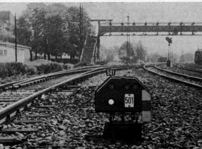
Abb. 1. Fast wie ein Pilz, der gerade die Erdoberfläche durchstoßen hat, wirkt das Zwergsignal, das hier im Bahnhof Plochingen nicht nur als Gleissperrsignal (Sh 0/Sh 1) dient, sondern durch das im Augenblick der Aufnahme gezeigte Signalbild – nur die untere weiße Lampe leuchtet – das Bahnpersonal darauf hinweist, daß der nachfolgende Gleisabschnitt zur Zeit nicht vom Stellwerk überwacht wird, daß folglich keine Zugfahrt zu erwarten ist und daß Rangierfahrten unter Beachtung der notwendigen Vorichtsmaßregeln freizügig durchgeführt werden können. Die an der rechten Seite des Signalkastens befindliche Bake (weiß-rot-weiß) bedeutet, daß dieses Signal vom Stellwerk aus bedient wird, im Gegensatz zu den „zugbedienten“ (automatischer Streckenblock usw.), die auf der linken Seite des Kastens eine gelb-schwarz-gelbe Bake haben.
