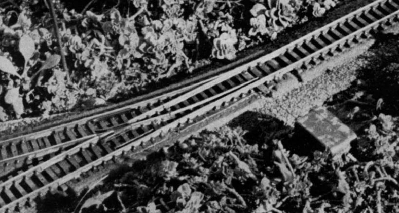
Abb. 3. Eine der im Freien installierten Fleischmann-Handweichen. Der Redlin-Antrieb ist in der rechts neben dem Gleis erkennbaren Plastikschachtel (mit Tarnanstrich) wasserdicht „verpackt“.
