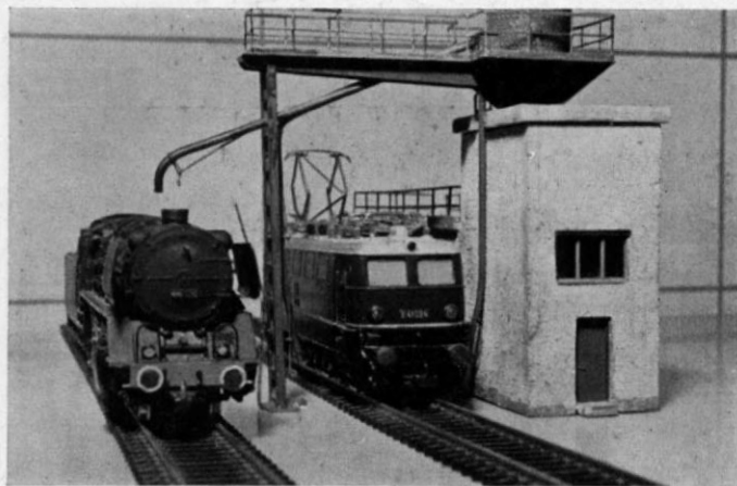
Abb. 7. Auf dem Gleis unter der Brücke werden El-loks, Dieselloks und Triebwagen besandet, auf dem Gleis links neben der Brücke dagegen Dampfloks.
