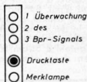
Abb. 4. So etwa könnte das Bremsprobe-Bedienungsfeld am Schaltpult aussehen. Die Kontroll-Lampen 1-3 sind den entsprechenden Lampen des Signals parallel geschaltet. Die Merklampe entspricht der Kontroll-Lampe L in Abb. 3 (Vorschlag Siepert).
