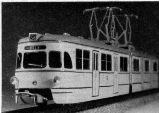
Abb. 3. Ein Großraum-Straßenbahn-Gelenkzug, dessen Köpfe einschließlich Lampenansätze Herr K. Hilscher, Ulm, nach seiner Cellon-Tiefziehmethode hergestellt hat. Derartig abgerundete Fahrzeugköpfe aus Metall oder einem anderen Material in „herkömmlicher“ Weise herzustellen, dürfte den meisten unter uns wohl große Schwierigkeiten bereiten; es sei denn, sie sind von Beruf „Blechpatscher“. (Schön wäre es, wenn man sich auch die zerbeulten Kotflügel seiner Wirtschaftswunder-Familienschaukel auf diese billige Art und Weise selbst reparieren könnte.)
