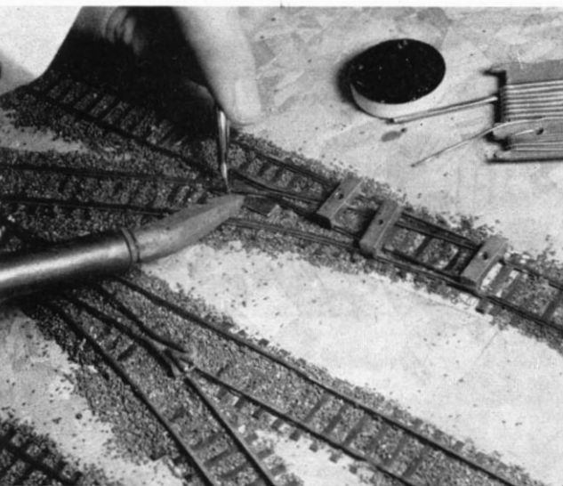
Abb. 6 Unter die Radlenker-Enden der Flügelschienenstücke ist ein 0,3 mm-Ms-Blech zu schieben, auf dem die Profilstücke festgelötet werden. Das gleiche geschieht mit der Herzstückspitze, die man entweder aus Vollmaterial aussägt oder aus zwei entsprechend angespitzten Profilstücken zusammensetzt. Wichtig ist, daß der Winkel des Herzstückes genau stimmt. Nach dieser Prozedur hat man dann eine zusammenhängende Zungen-Flügelschienen-Herzstück-Einheit, die man bequem herausnehmen kann. Die überstehenden Blechteile sägt man ab und trennt schließlich auch das Herzstück samt seinen Radlenkern von den Flügelschienen. Man erhält dann eine — elektrisch isolierbare — Herzstückeinheit, wie sie in Abb. 4 gut zu sehen ist. Schließlich sägt man auch die Zungenspitzen dort ab, wo in den Weichenschablonen die Gelenke eingezeichnet sind. Die Gelenke selbst fertige ich in der gleichen Art an, wie es die Fa. Nemec bei ihren Weichenbausätzen vorexerziert.
