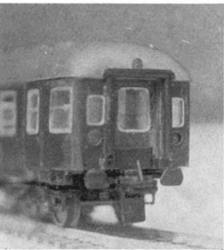
Abb. 4. Auch im Osten Deutschlands gehen die Modellbahner mit der Zeit. Herr O. H. aus D. verwandelte einen normalen Trix-Wagen in einen Wendezug-Steuerwagen und versah ihn auch gleich noch mit Norm-Radsätzen.
