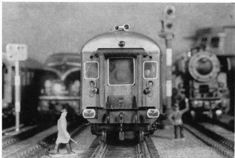
Abb. 3. Das „Konterfei“ des Steuerwagens nach der Herrn Lehmann bestens gelungenen „Operation“. Besonders beachtenswert: die Bremsluftschläuche, die Airfix-Kupplung sowie der akkurate Pufferteller-Warnanstrich.
