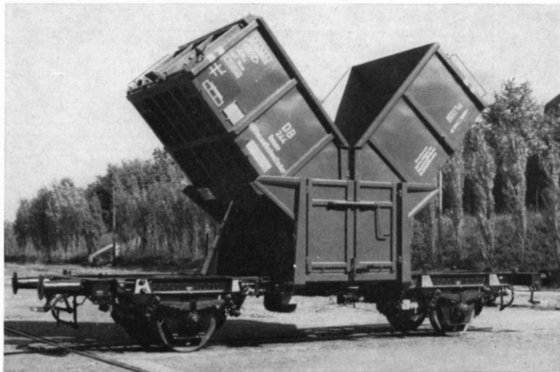
Abb. 1. DB-Mittenselbstentlader Fd-z-72 (Ommv-72) in Entladestellung. Der hier im Bild gezeigte Prototyp stimmt mit der Serien-Ausführung (Bauzeichnung) nicht in allen Details überein, gibt aber einen guten Eindruck vom Entladeprinzip. (Werkfoto: Talbot)
