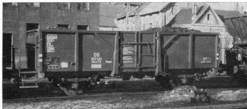
Abb. 8. Mittelselbstentlader Fd-z-72 mit Bremserstand.
