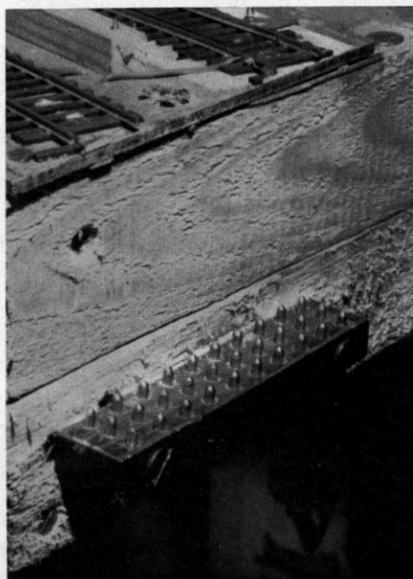
Abb. 13. Die Steckerkontaktleiste ist mit kräftigen Schrauben direkt am Anlagenrahmen festgeschraubt. Die Schienenprofile sind genau entsprechend der Brückenfluchtlinie abgesägt!
