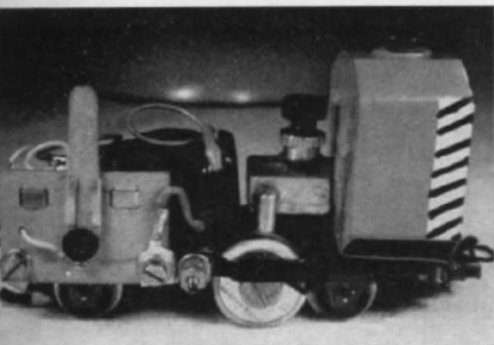
Abb. 5. Das gleiche wie in Abb. 4, nur mit abgenommener Motorhaube. Der Umschalter ist jetzt gut sichtbar.
