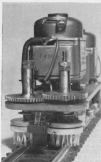
Abb. 11. Das Wichtigste ganz nah: die Rotationsbesen und ihr Antrieb (einschl. der besagten sicheren Doppelmutter).
