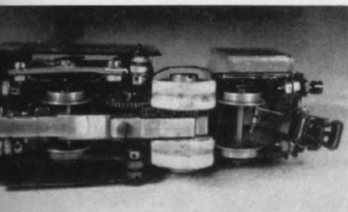
Abb. 6. Das Schienenreinigungsfahrzeug von unten. Die beiden Reinigungswalzen sind deutlich zu sehen.
