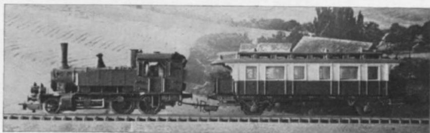
Abb. 2 und 3. Der BR 69 bzw. 70 (unten) sieht man es nicht mehr an, daß die Gehäuse der italienischen Kitmaster-C-Lok entsprechend abgeändert worden sind. Aus dem Fahrwerk einer Kleinbahnlok wurde eine Treibachse herausoperiert und jeweils eine Laufachse anmontiert.
