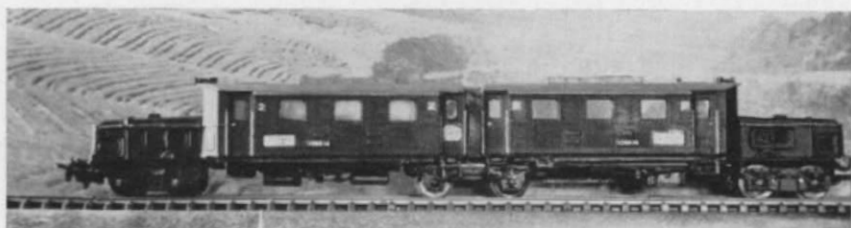
Abb. 6 und 7. Diese beiden Modelle sind etwas mehr „FS“ (frei Schnauze) entstanden. Der Triebwagen wurde in Anlehnung an den ETA 180 aus zwei Oberteilen der E 1280 ÖBB (Kleinbahn) gebaut. Die anderen Teile sind wiederum von „internationaler“ Herkunft: Batterie-Kästen vom Kitmaster-„Krokodil“, die Drehgestelle von Kleinbahn, der Antrieb von TRIX, Getriebe von Sommerfeld usw.
