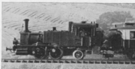
Abb. 2 und 3. Der BR 69 bzw. 70 (unten) sieht man es nicht mehr an, daß die Gehäuse der italienischen Kitmaster-C-Lok entsprechend abgeändert worden sind. Aus dem Fahrwerk einer Kleinbahnlok wurde eine Treibachse herausoperiert und jeweils eine Laufachse anmontiert.
