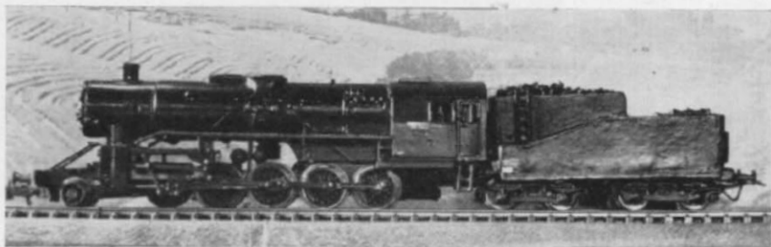
Abb. 5. Die BR 52 war vormals eine Gützold-„42“. Der Tender sowie die Vorlaufachse sind Eigenbau. Diese Lok kann übrigens mit wenigen Handgriffen wieder in eine „42“ zurückverwandelt werden.
