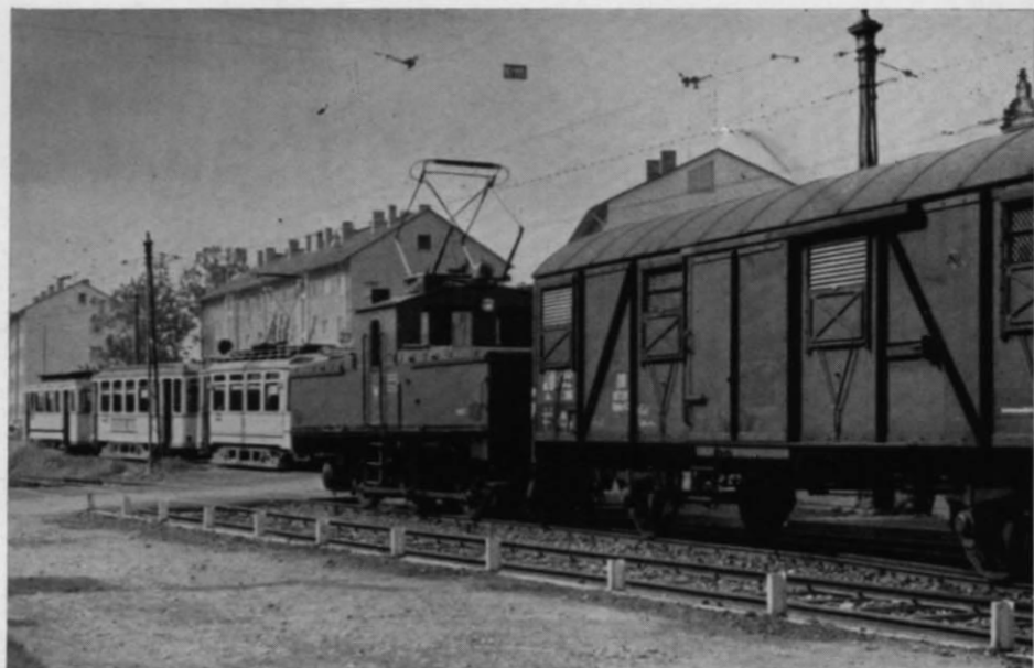
Abb. 3. Güterzuglok für Gleichstrom-Fahrleitungs- und Speicherbetrieb, Betriebsnummer 2020, der Frankfurter Straßenbahn. Im Bereich des Straßenbahn-Oberleitungsnetzes wird der Fahrstrom über den Bügel entnommen.
