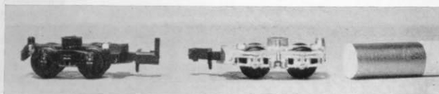
Abb. 4 und 5. Die neuen Drehgestelle (links amerikanischer Bauart, rechts Minden-Deutz), zwar etwas vereinfacht und verkürzt, jedoch trotz der Kleinheit gut detailliert, beide mit der neuen Kupplung; beim MD-Drehgestell ist der obere Pinn für die bisherigen Kupplungen weggeknipst worden.
