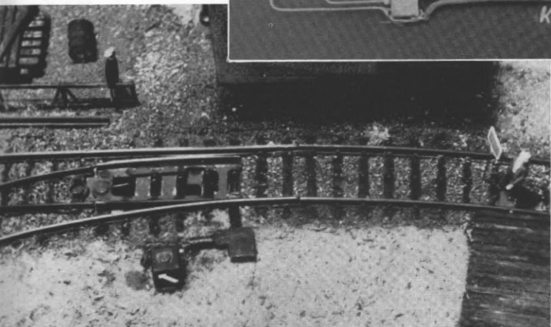
Abb. 2. Der „RU-ME-SCHA“ nach der Montage bei einer MARKLIN-Linksweiche (s. a. Abb. 3).
