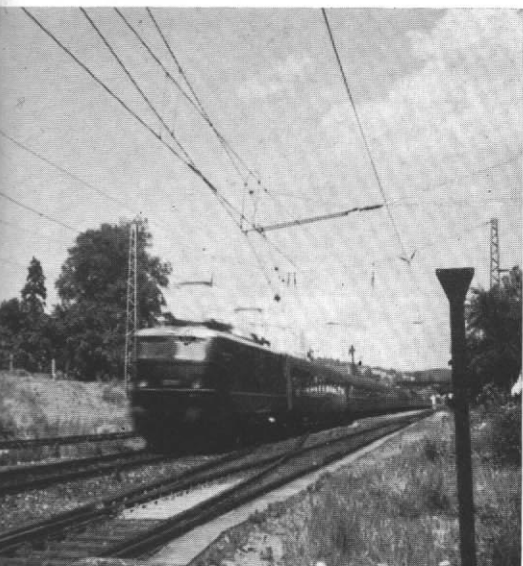
Abb. 18. Noch ein Beispiel für einen Bogenabzug (über einer Weiche) mittels Zugseil (samt Isolator und Fahrdratseitenhalter), das an einem Bauwerk oder an einem Hilfsmast befestigt ist.
