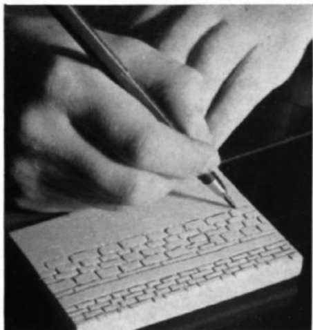
Abb. 1. Müheless und spielend „zeichnet“ man die Fugen in PORODUR.
