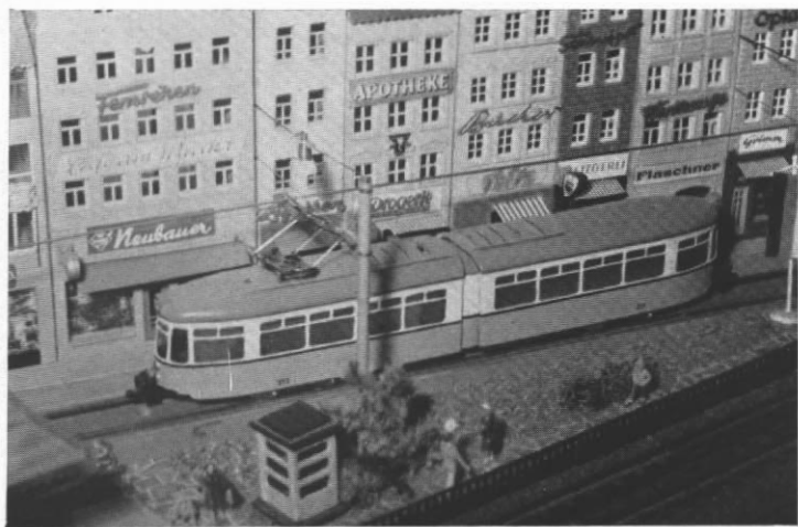
Abb. 4. Über das Modell des vierachsigen Gelenktriebwagens der Stuttgarter Straßenbahn A.G. TW 511 – hier die türlose linke Seite – gibt es etwas mehr zu sagen. Auf die einander zugekehrten Endquerträger der beiden Drehgestelle stützt sich ein Verbindungsträger ab, der die beiden Wagenhälften trägt und führt. Der Motor liegt nicht im Drehgestell, sondern auf diesem Verbindungsträger; die Kraftübertragung erfolgt mittels Kardanwelle auf ein Drehgestell.
