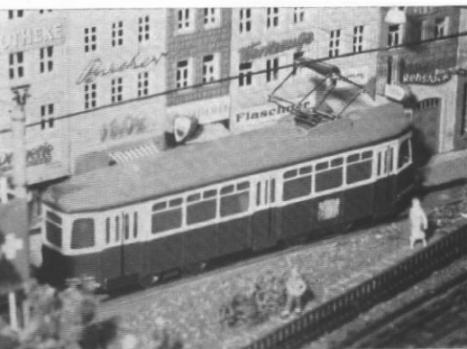
Abb. 3. Der neueste Großraumwagen der Züricher Straßenbahn, der TW 1416, mit vierachsigen HAMO- Drehgestellen. Aufbau wiederum aus Ms-Blech und Vollholzdach.
