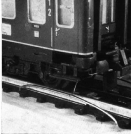
Abb. 1. Die anzufertigenden Gegenkontakte neben den Schienen, über die soeben der kaum sichtbare „Schnurrbart“ hinweggleitet.
