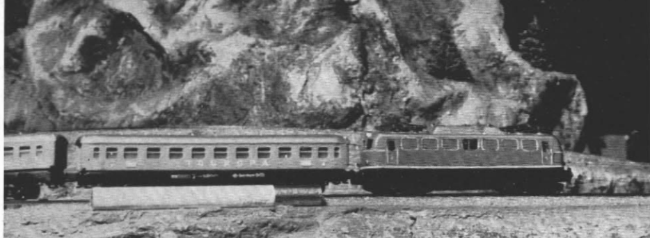
Abb. 10. Die letztjährig angekündigte E 10 blau (in Grün = E 40) ist die erste Lok, die zur maßstabgerechten Linie zählt (alle Achsen angetrieben, verbesserter Motor, Puffer). Die Stromabnehmer sind nicht federnd, sondern im Interesse einer zierlicheren Ausführung starr. Außerdem ist bei ARNOLD eine nur optisch wirkende, funktionslose Oberleitung geplant.
