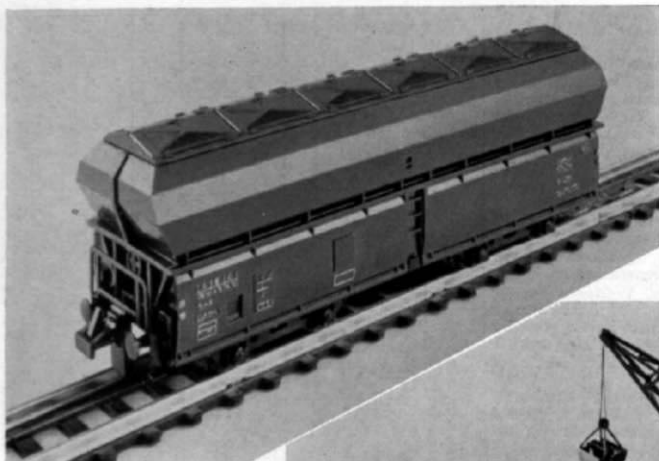
Abb. 161. Aus dem 00t50 ist ein KKt 57 geworden (dessen internationale Bezeichnung Uad-v-57 lautet). Durch das Spritzgußunterteil und das Oberteil (einschl. Deckel) aus Kunststoff besitzt das vierachsige Modell gute Laufeigenschaften.
