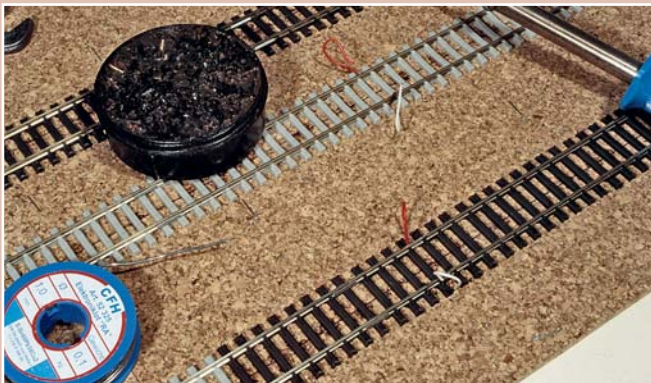
Vor der optischen Behandlung der Schienenprofile sollte man die Anschlussdrähte verlöten. Sie werden durch Bohrungen gefädelt.
