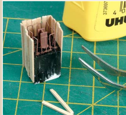
Die Nachbildung der Armierungseisen entstand aus Messingdraht, die Holzschalung aus dünnen Holzleisten.
