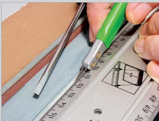
Die dünne Dämmstoffplatte wird parallel zum Randstein leicht eingeschnitten. Ein zweiter Schnitt halbiert diesen Streifen nochmals. Als Maß dient die Spitze eines Schraubendrehers.
