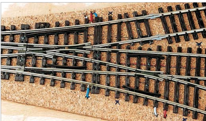
Der Aufwand hat sich gelohnt – nach der Grundierung mit rostbrauner Farbe ist die unterschiedliche Herkunft der Weichen nur bei genauem Hinsehen zu erkennen.
