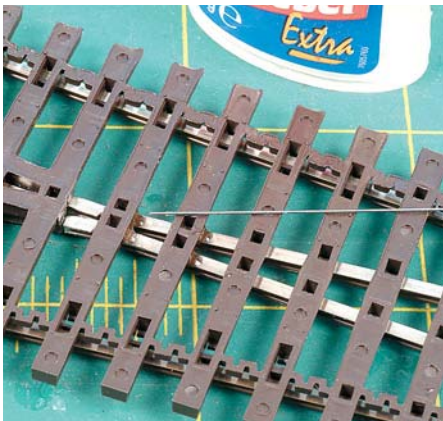
Die Flügelschienen wurden an den beiden Schwellen vor dem Herzstück mit Sekundenkleber versehen und mit einer Zange leicht zusammengedrückt – danach sollten Herzstück und Flügelschienen genau fluchten.
