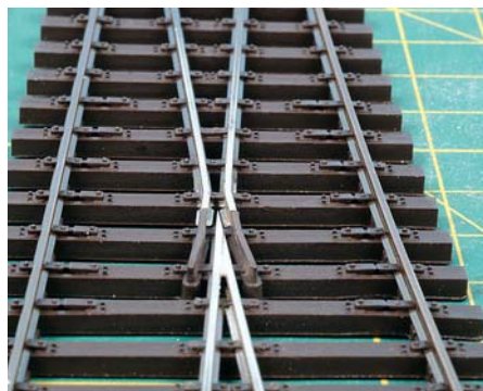
Zum Schluss wurde die Öffnung mit einem Stück Polystyrol mit der Nachbildung des Weichenantriebs von Weinert abgedeckt. Die Platte wurde nur mit Weißbleim „geheftet“, sodass sie sich auch wieder leicht entfernen lässt.
