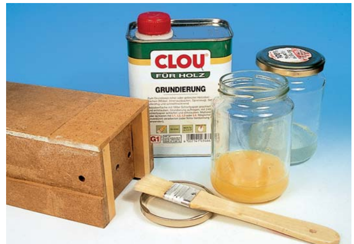
Um das Holz vor dem Aufquellen durch dünnflüssigen Schotterkleber zu schützen und um eine bessere Grundlage für die selbstklebende Korktapete zu schaffen, müssen alle Flächen mit farbloser, porenfüllender Grundierung eingelassen werden.
