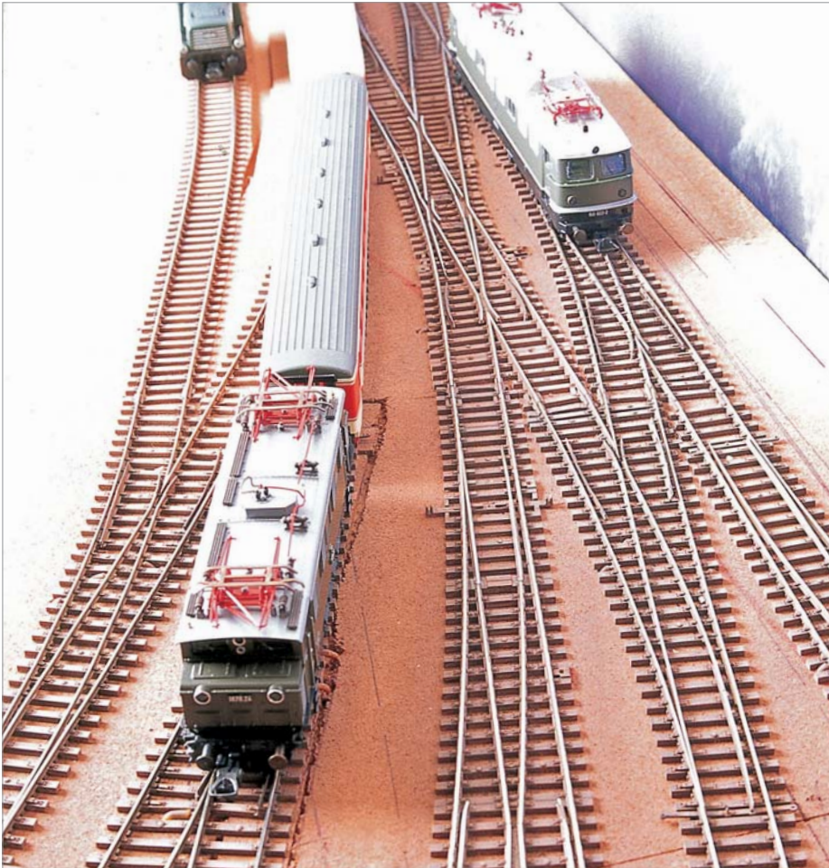
Der Aufwand hat sich gelohnt – nach der Grundierung mit rostbrauner Farbe ist die unterschiedliche Herkunft der Weichen nur bei genauem Hinsehen zu erkennen.
