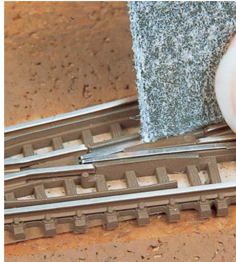
Nach dem Abreiben der Schienenköpfe mit einem Schleifgummi erfolgt das Polieren mit dem Reinigungsfilz von Manfred Jörger. Besonders wichtig ist auch das Reinigen der Kontaktbleche im Herzstück der Miniclub-Weichen. Baufotos: Wolfgang Besenhardt
