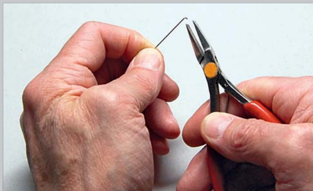
Der dem Servo beiliegende Stelldraht ist stark federnd – er muss daher zunächst etwas stärker abgebogen werden, damit er die gewünschte Position beibehält.
