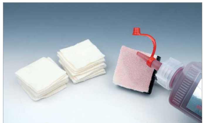
Vorbereitende Handgriffe: Reinigungsfilz per Klettverschluss ansetzen und mit Flüssigkeit beträufeln.
