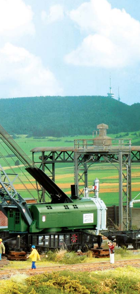
Zwei 75-t-Krane heben im Bw Behrenfeld für Wartungsarbeiten die Drehscheibenbühne aus der Grube. Für diese Last hätte zwar auch einer gereicht, aber mit zweien ließ sich die Bühne besser wieder einhängen. Die Modelle stammen von Weinert.
