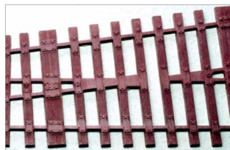
Weller-8,5°-Rost nach erster Reinigung vom Trennmittel mit Aceton; keine Schienenklemmen, aber zierliche Rippenplatten.
