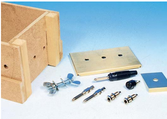
Der fertig verleimte Modulkasten mit allen Verbindungselementen und den Bohrschablonen für die Kopf- und Seitenteile
