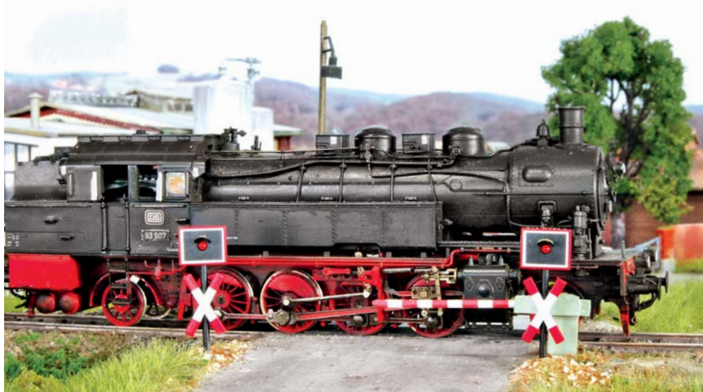
Halbschranke mit einer Blinklichtanlage, wie sie bereits in der Epoche III eingesetzt wurde. Der Schrankenbaum greift als Gabel um den Antriebskasten.
