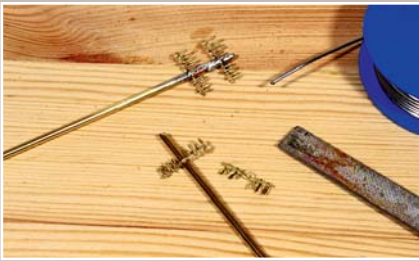
Die Telegrafmasten entstanden aus Messingteilen von Weinert; die Traversen wurden mit dem Mast verlötet.
