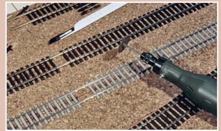
Nach dem Auflöten werden die Schienen an den Modulkanten getrennt.
