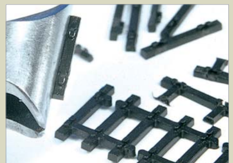
... korrekte Länge und Breite. Da die Schwellen jedoch zu dicht liegen, müssen sie aus den Stegen herausgetrennt werden.
