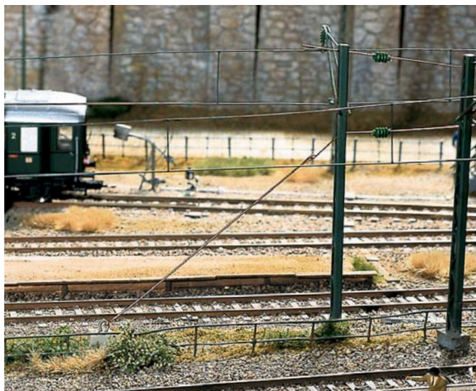
Da die Fahrdrähte richtig gespannt sind, ist auch eine stabile Abspannung erforderlich. Fotos: Helmut Brückner
