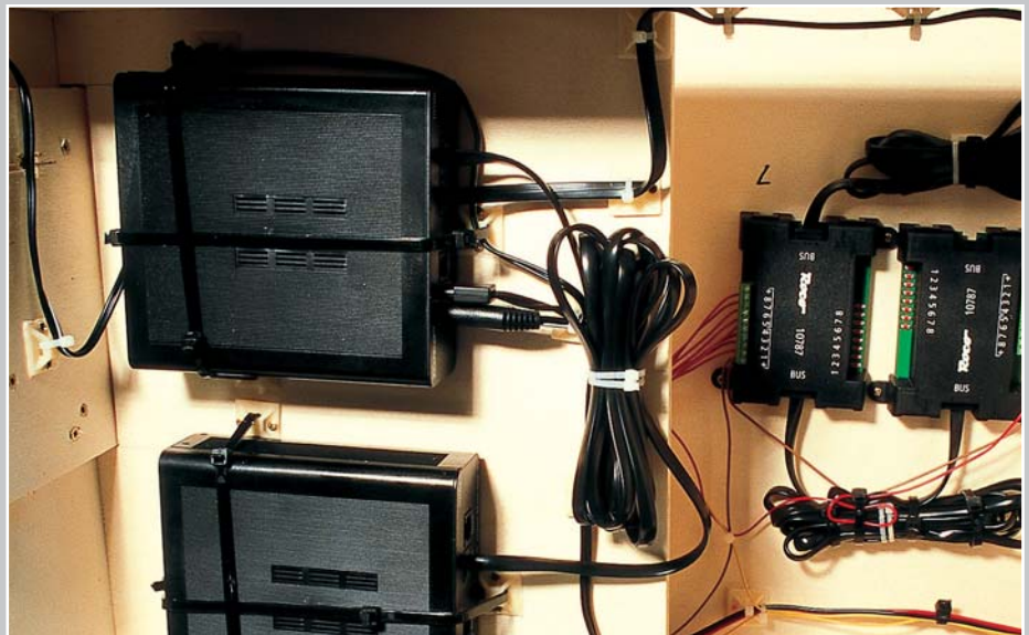
Da Interface und Verstärker keinerlei Bohrungen oder andere Haltevorrichtungen aufweisen, wurden sie kurzerhand mit Kabelbindern unter der Anlage befestigt.
