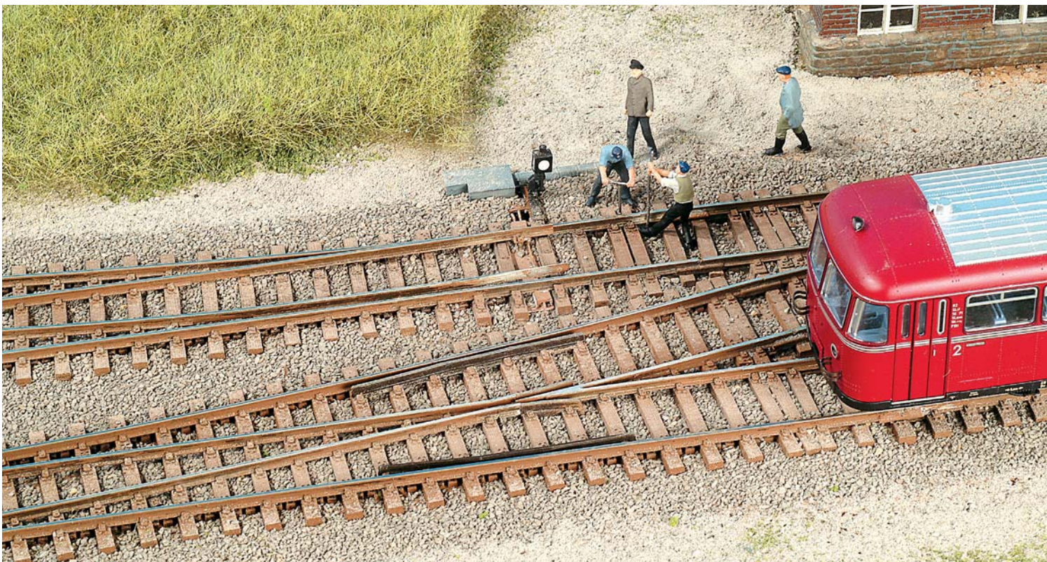
Die Flügelschienen wurden an den beiden Schwellen vor dem Herzstück mit Sekundenkleber versehen und mit einer Zange leicht zusammengedrückt – danach sollten Herzstück und Flügelschienen genau fluchten.
