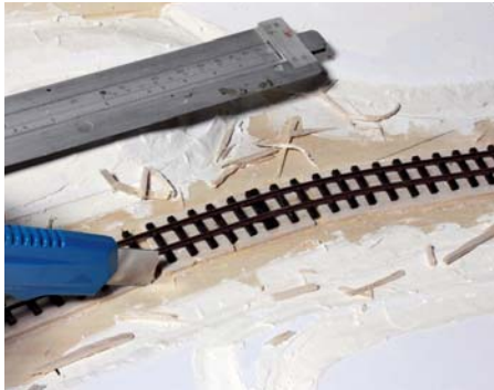
Nach der Gleisverlegung wurde das Bett aus Balsaholz an den Seiten abgeschnitten.
