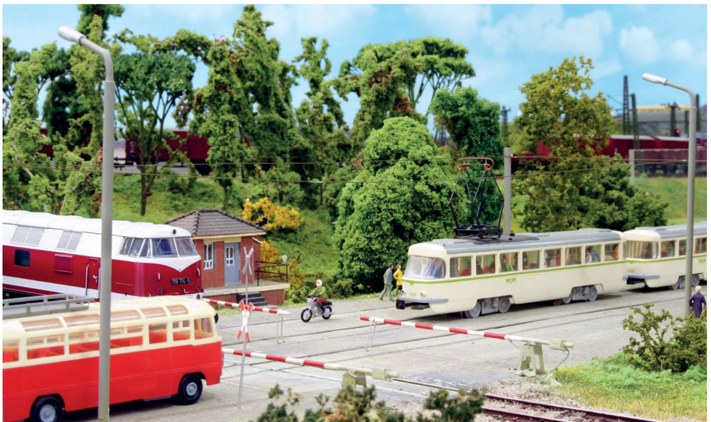
Bü-Sicherung mit gegenslägigen Schranken ohne Behang. Interessant ist dabei die Kreuzung Eisenbahn/Straßenbahn. Leider gibt es in der Straßenmitte noch ein recht großes „Schlupfloch“ zwischen den Schranken. (Anlage: Magdeburger Eisenbahnfreunde e.V.).
