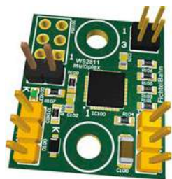
N-0: Mit dem WS2811-Multiplex von Fichtelbahn können Lichtsignale an die NeoControl angeschlossen werden.
