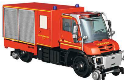
H0: Der formneue Zweiwege-Unimog 423 von Zagro soll auch im Modell vor Güterzügen eingesetzt werden können.
