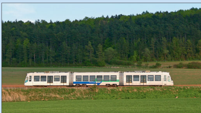
Den Triebwagenzug RegioCitadis setzt man in Kassel auch als Hybridvariante mit Dieselantrieb ein und befährt mit ihm die Nebenstrecke nach Wolfhagen.
