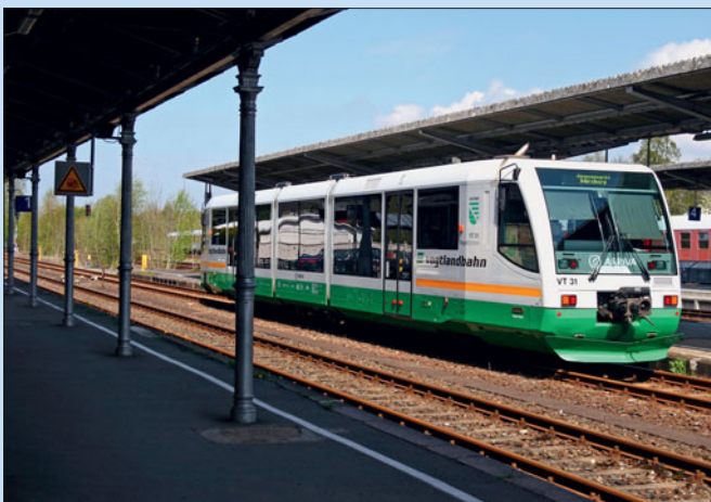
Die Triebwagen RegioSprinter I der sächsischen Vogtlandbahn besitzen Blinklichter für den Einsatz auf den Straßenbahngleisen im Stadtzentrum von Zwickau. Das Foto entstand in Neuenmarkt-Wirsberg.
