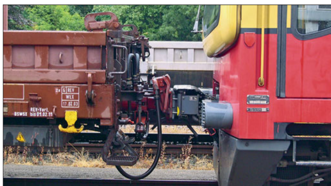
Dieser S-Bahn-Triebwagen der BR 481 wird mit einem Kuppelwagen der S-Bahn Berlin überführt, bei dem die Übergangskupplung fest montiert ist und die Puffer demonstrierbar sind.
