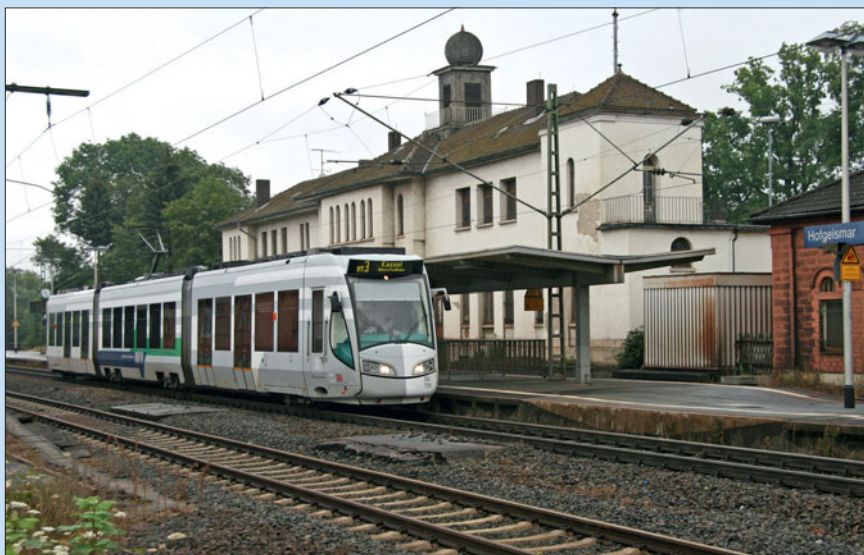
Für den Antrieb durch Dieselmotor und Generator auf dem Dach besitzen die Fahrzeuge einen Treibstofftank in den Endwagen mit Einfüllöffnungen zwischen den Türen.
