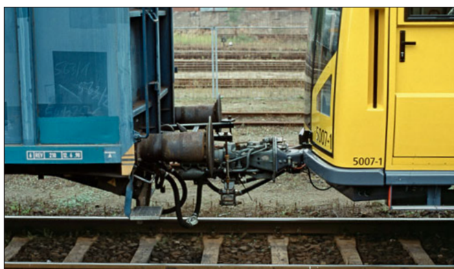
Übergangskupplung zwischen einem Habis-Wagen und einem Kleinprofilzug der Bauart Hk der Berliner U-Bahn.
