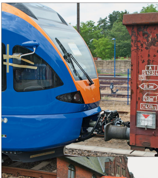
Bei der Überführung dieses fabrikneuen Flirts finden Kuppelwagen mit Übergangskupplungen Verwendung. Die Fahrzeugnummern sind noch nicht angebracht und die Spiegel mit Klebeband fixiert.
