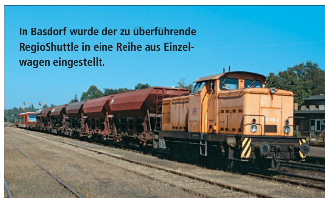
Aus Gründen der Transporthaftung wurde dieser RegioShuttle trotz normaler Zug- und Stoßvorrichtung mit Schutzwagen transportiert. Als Zuglok diente eine DR-V60.
