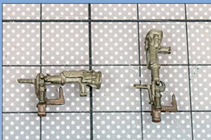
Auf dem Bild links ist die montierte Kupplung in herunter- und hochgeklapptem (rechts) Zustand zu erkennen.
