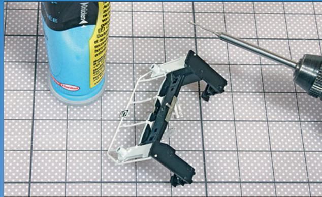
Je nach verwendeter Lokbaureihe müssen die Aufnahmen und Anschläge der Kupplung an der Pufferbohle montiert werden. Dazu müssen die Pufferbohlen mit dünnen Löchern aufgebohrt werden.
