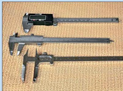
Messschieber (Schieblehren) sind Längenmessgeräte. Auf einer Stange mit zwei Messschenkeln lässt sich ein Schieber bewegen, der ebenfalls Messschenkel trägt. Für Innen- bzw. Außenmessungen wird je eines der Messschenkelpaare an die Innenwände eines Körpers bzw. außen angelegt. Am Schieber befindet sich oft eine Messstange, die zur Tiefenmessung (bei Sackbohrungen) verwendet wird.
