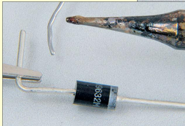
Zum Abwinkeln der Anschlussdrähte ist stets ein geeignetes Werkzeug zu benutzen. Nie freihändig umbiegen. Beim Verlöten ist für eine gute Wärmeableitung vor dem Gehäuse zu sorgen.
