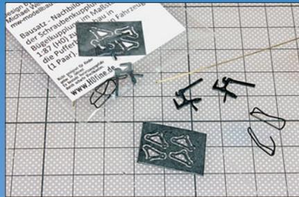
OBK-Kupplungshaken aus Kunststoff mit Bügel werden auch als kleine Bausätze angeboten. Der Bügel ist bereits fertig gebogen.
