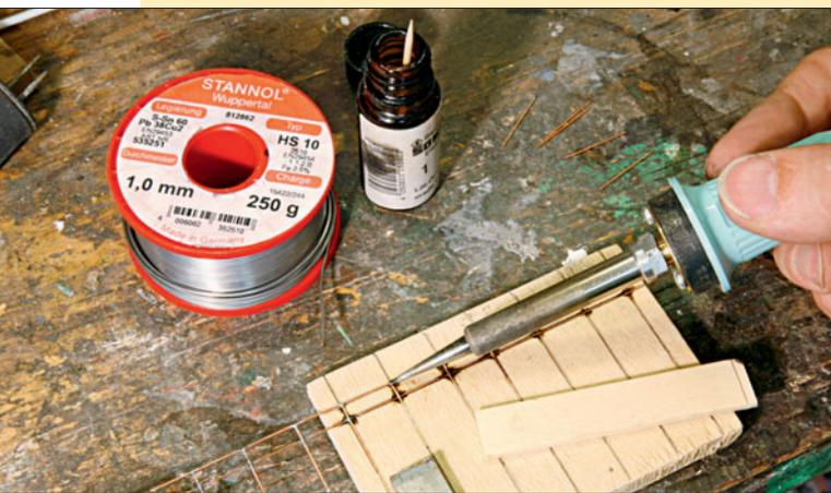
Die verkupferten Eisendrähte von Sommerfeldt lassen sich mithilfe des Lötöls hervorragend verbinden. Danach muss das übergelaufene Zinn mit den passenden Nadelfeilen abgetragen werden.
