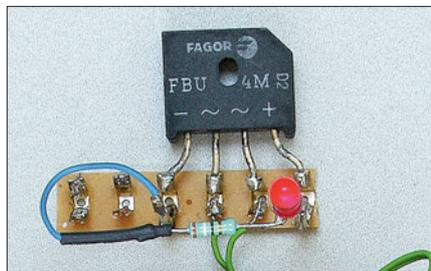
Der Schaltungszusatz in vergrößerter Darstellung. Die Leitungen vom Trafo kommen an die AC-Anschlüsse des Gleichrichters.
