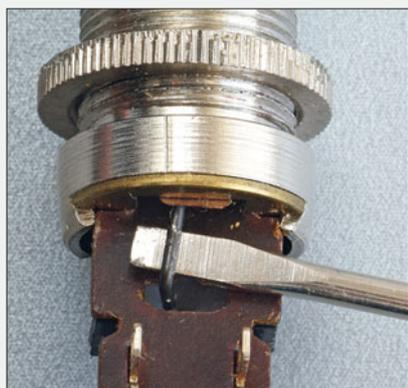
Mit einem Schraubendreher oder einer Zange kann der Arretierbügel ...
