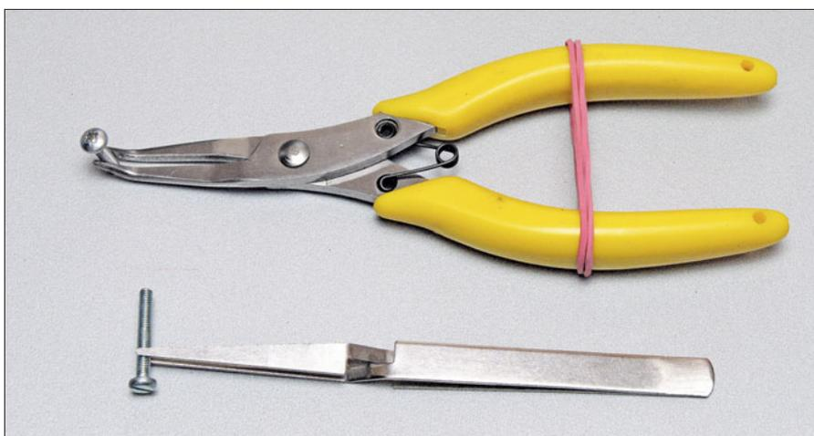
Eine einfache Möglichkeit, mittels Gummiarretierung eine Negativ-Pinzette (selbstschließend) durch eine Spitzzange zu ersetzen.
