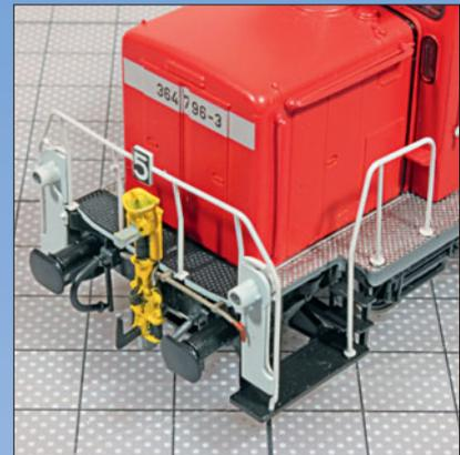
Wenn die RK 900 hochgeklappt ist, kann der Kupplungshaken verwendet werden.
