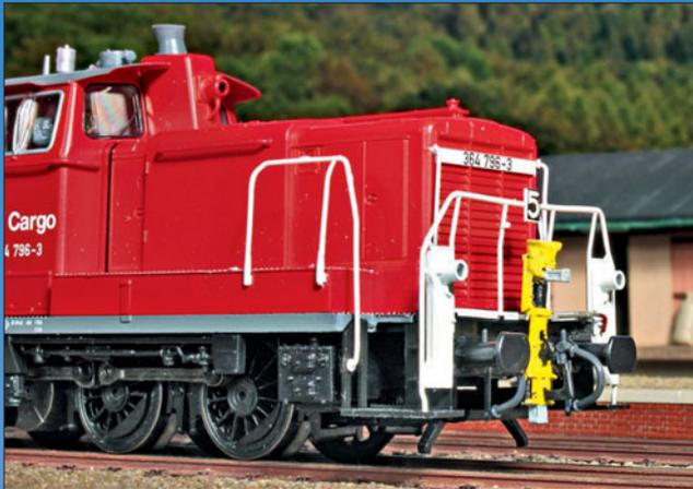
Ebenfalls von H0fine wird die Rangierkupplung RK 900 angeboten. Auch sie verfügt über den Lohaken und kann folglich mit Bügelkupplungen gekuppelt werden. Hier ist die RK 900 hochgeklappt. Im unteren Bereich ist der Haken zu sehen.
