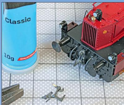
In die Front der Köf wurde der passende Lokhaken in die vorhandene Öffnung geklebt (links). Auch der PMT-VT erhielt die kleine Kupplung für die Pufferbohle.
