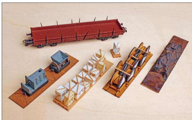
Für Ladegüter, die man am Wagenboden verspannen muss, kann man herausnehmbare Wagenböden fertigen. Je nach Wagentyp bestehen sie aus Holz- oder Blechnachbildungen.
