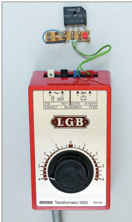
Links: Der Einstellknopf zur Geschwindigkeit befindet sich in der linken, weiß markierten Endstellung. Über dem Fahrtransformator der Brückengleichrichter mit der LED zur Spannungsanzeige. Zur besseren Erkennung ist eine rote LED in Verwendung.
