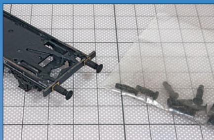
In neue Bohrungen in der Pufferbohle werden Pufferflansche und Federpuffer – hier von Weinert-Modellbau – eingeklebt.
