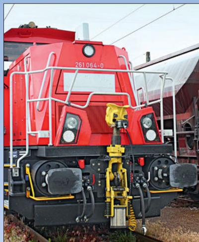
Die Rangierkupplung des Typs RK 900 wird an den meisten Rangierloks der Deutschen Bahn AG verbaut. Hier im noch nahezu neuwertigen Zustand an einer Lokomotive der Baureihe 261. Deutlich sind der graue Stellmotor am unteren Ende sowie die schwarzen Federn zu erkennen. Die Ansteuerung erfolgt über spiralförmige Leitungen.
