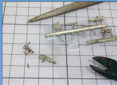
Über einen Stift kann der obere Teil der Kupplung beweglich montiert werden. Die Bauteile sind von Gussgrat zu säubern.
