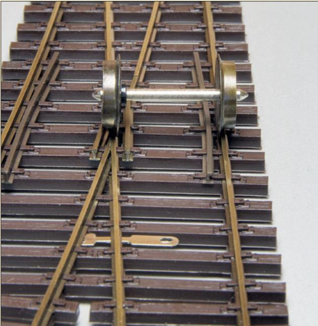
Unerlässlich für einen reibungslosen Betrieb der Modellbahn – gleich welcher Spurweite – ist ein korrektes Radsatzinnenmaß. Das gewährleistet eine sichere Stromaufnahme und einen ruhigen Lauf der Fahrzeuge. Ist dieses wichtige Maß nicht normgerecht, kommt es auf den Weichen zu Entgleisungen, da das Rad im Herzstückbereich aufsteigt und in anderen Weichenbereichen sogar einen Kurzschluss verursachen kann.
