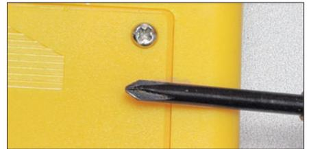
Nicht nur die Batteriefächer von Messgeräten, auch andere elektrische Komponenten erfordern zum Anschließen Kreuzschraubendreher in unterschiedlichen Dimensionen, wie sie diverse Sets enthalten.
