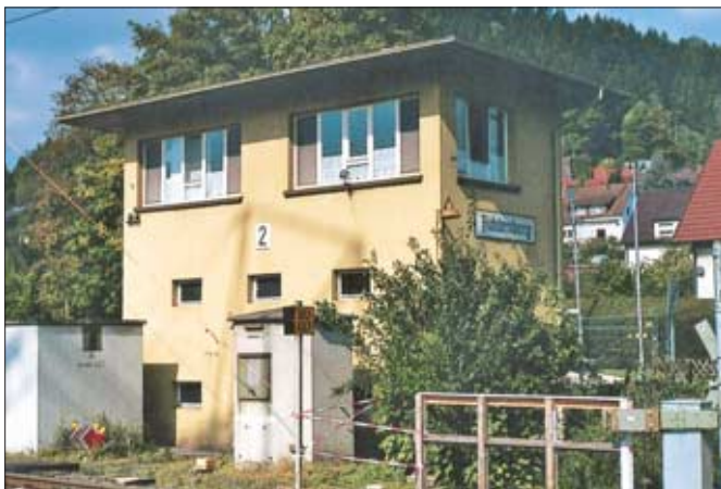
Das kleine Schaubild zeigt den linken Anlagenteil mit Tunnel und Bebauung. Zeichnung: Reinhold Barkhoff Unten: Das Stellwerk entspricht der Einheitsbauart aus DRG-Zeiten; die zugehörigen Flügelsignale sind noch in Betrieb. Fotos: jw
