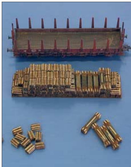
Wie beim Original erhielt die Ladung eine zusätzliche Längssicherung in Form von aufgelegten Latten (im Modell wieder Northeastern-Profile), die der Länge nach niedergebunden sind und mit Garn mittels Sekundenkleber gesichert sind. Alle Modellfotos: Horst Meier
