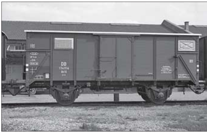
Voll aufgearbeitete G 10 in unterschiedlichen Ausführungen. Links oben der im AW Friedrichshafen hergerichtete Gh 10 134 614 mit alten Laufwerken und einem Kastengerippe in der ursprünglichen Anordnung der Profile, jedoch bereits mit Schichtholzplatten und verzinkten Lade- und Lüftungskappen. Rechts daneben der im AW Oldenburg umgebaute G 10 105 557 mit geänderter Anordnung der Kastensäulen und Austauschbaulaufwerken. Unten die beiden Wagen mit Tonnendach – links der ehemalige G 10 131 353 bereits mit der UIC-Bezeichnung Gklm 191 112 4 691, rechts der Gs 13 noch mit der ursprünglichen Nummer 113 268. Fotos: Fritz Willke (3), GDW Frankfurt, Slg. SC
