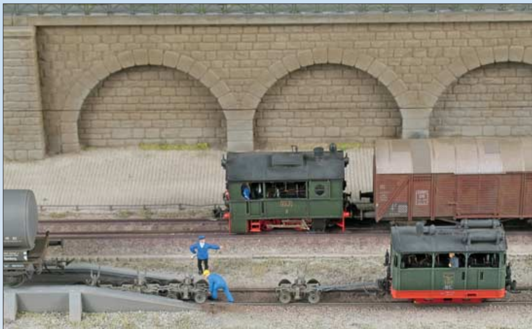
Gut zu erkennen ist die Kuppelstange, die im Rollbock einerseits und in der Microtrain-Kupplung der Kastenlok 102 der OEG andererseits eingegangen ist.
