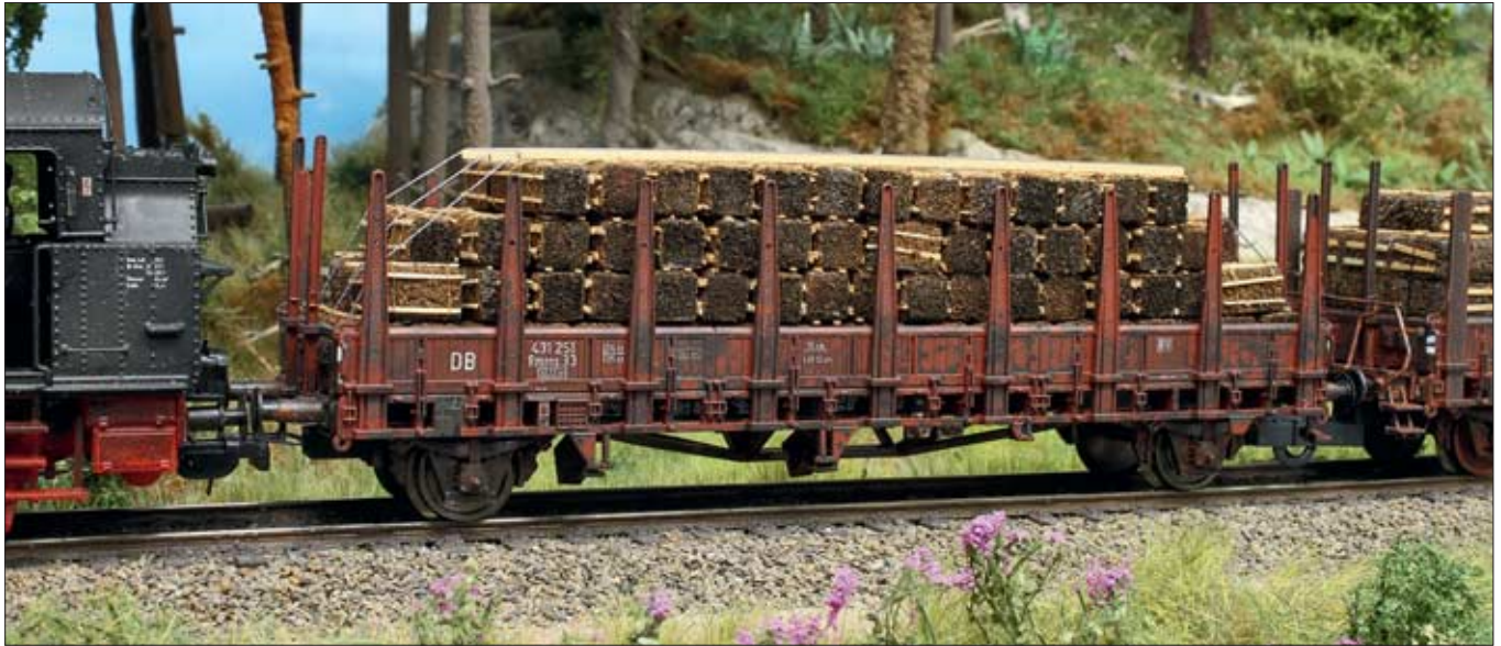
Wie beim Original erhielt die Ladung eine zusätzliche Längssicherung in Form von aufgelegten Latten (im Modell wieder Northeastern-Profile), die der Länge nach niedergebunden sind und mit Garn mittels Sekundenkleber gesichert sind. Alle Modellfotos: Horst Meier
