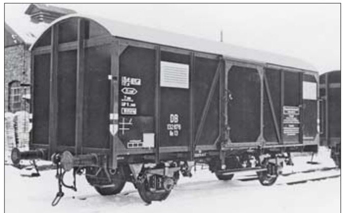
Voll aufgearbeitete G 10 in unterschiedlichen Ausführungen. Links oben der im AW Friedrichshafen hergerichtete Gh 10 134 614 mit alten Laufwerken und einem Kastengerippe in der ursprünglichen Anordnung der Profile, jedoch bereits mit Schichtholzplatten und verzinkten Lade- und Lüftungskappen. Rechts daneben der im AW Oldenburg umgebaute G 10 105 557 mit geänderter Anordnung der Kastensäulen und Austauschbaulaufwerken. Unten die beiden Wagen mit Tonnendach – links der ehemalige G 10 131 353 bereits mit der UIC-Bezeichnung Gklm 191 112 4 691, rechts der Gs 13 noch mit der ursprünglichen Nummer 113 268. Fotos: Fritz Willke (3), GDW Frankfurt, Slg. SC
