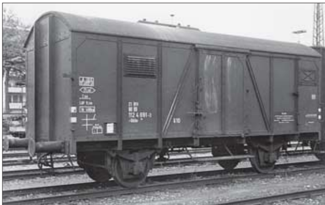
Voll aufgearbeitete G 10 in unterschiedlichen Ausführungen. Links oben der im AW Friedrichshafen hergerichtete Gh 10 134 614 mit alten Laufwerken und einem Kastengerippe in der ursprünglichen Anordnung der Profile, jedoch bereits mit Schichtholzplatten und verzinkten Lade- und Lüftungskappen. Rechts daneben der im AW Oldenburg umgebaute G 10 105 557 mit geänderter Anordnung der Kastensäulen und Austauschbaulaufwerken. Unten die beiden Wagen mit Tonnendach – links der ehemalige G 10 131 353 bereits mit der UIC-Bezeichnung Gklm 191 112 4 691, rechts der Gs 13 noch mit der ursprünglichen Nummer 113 268. Fotos: Fritz Willke (3), GDW Frankfurt, Slg. SC
