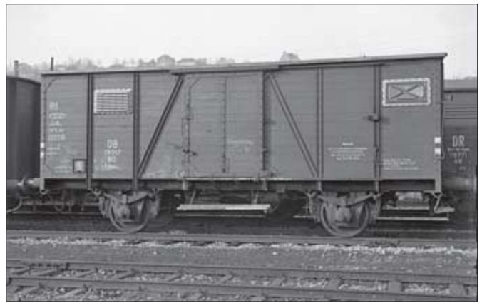
Voll aufgearbeitete G 10 in unterschiedlichen Ausführungen. Links oben der im AW Friedrichshafen hergerichtete Gh 10 134 614 mit alten Laufwerken und einem Kastengerippe in der ursprünglichen Anordnung der Profile, jedoch bereits mit Schichtholzplatten und verzinkten Lade- und Lüftungskappen. Rechts daneben der im AW Oldenburg umgebaute G 10 105 557 mit geänderter Anordnung der Kastensäulen und Austauschbaulaufwerken. Unten die beiden Wagen mit Tonnendach – links der ehemalige G 10 131 353 bereits mit der UIC-Bezeichnung Gklm 191 112 4 691, rechts der Gs 13 noch mit der ursprünglichen Nummer 113 268. Fotos: Fritz Willke (3), GDW Frankfurt, Slg. SC
