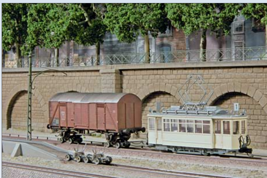
Gut zu erkennen ist die Kuppelstange, die im Rollbock einerseits und in der Microtrain-Kupplung der Kastenlok 102 der OEG andererseits eingegangen ist.
