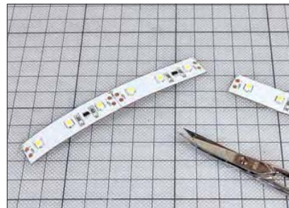
Selbstklebende LED-Leisten aus dem Elektrofachhandel wurden für die Wagen gekürzt.
