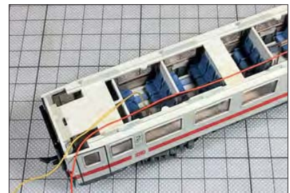
Die Drähte für die Beleuchtung fädelt man durch die Inneneinrichtung nach oben.
