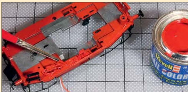
Mit Sekundenkleber werden die dünnen Litzen unter dem Umlauf festgeklebt.
