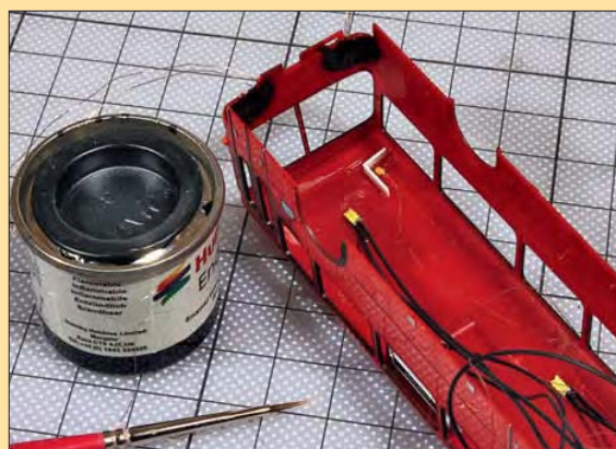
Um das Licht über dem Fahrersitz räumlich zu begrenzen, wurden aus kleinen Kunststoffstreifen Blenden neben die LEDs geklebt.
