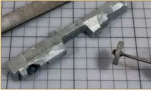
Um Platz für den zusätzlichen Decoder zu schaffen, wurde das Gewicht im Kessel demontiert und ausgefräst.
