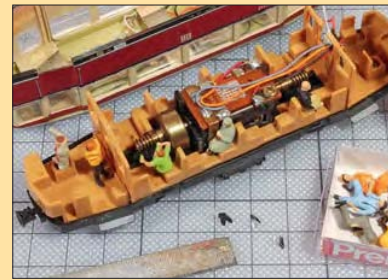
Um den Decoder im Fahrzeuginneren zu kaschieren, wurden einige sitzende Figuren auf die Sitzbänke geklebt.
