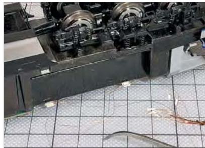
Unter die Kunststoffstreifen wurden anschließend die kleinen LEDs geklebt.
