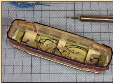
Die Innenbeleuchtung entstand aus LEDs, die unter die Decke des Fahrgastraumes geklebt wurden.
