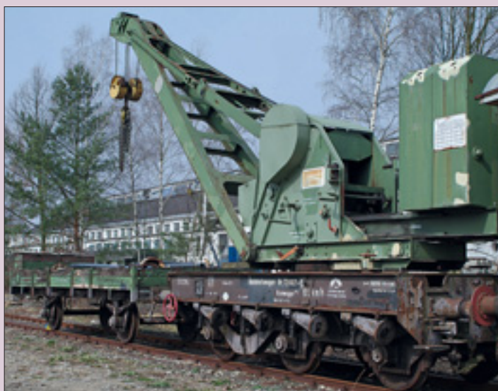
Dieser mit Handkurbelantrieb versehene 10-Tonnen-Kran wurde bis zur Übernahme durch die FME im Jahr 1992 im Bw Lichtenfels eingesetzt.
