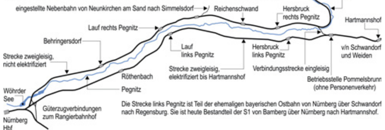
Der Streckenverlauf ab Nürnberg in der Übersicht. Deutlich ist hier der parallele Verlauf der beiden Strecken links und rechts der Pegnitz erkennbar. Der Übersichtlichkeit halber sind nur einige Bahnhöfe bzw. S-Bahn-Haltestellen eingezeichnet.
