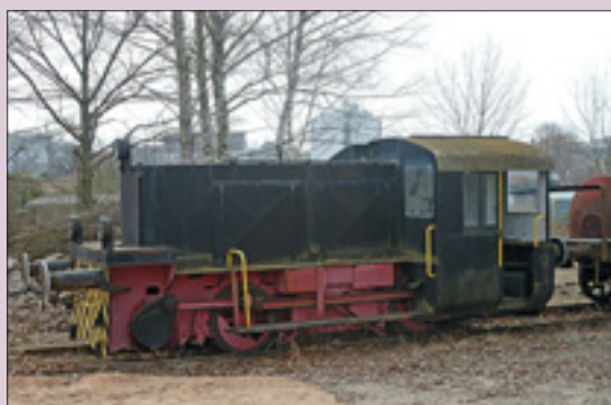
Bei dieser 1938 gebauten Diesellokomotive mit der Bezeichnung Kö handelt es sich um den Typ RL 12.
