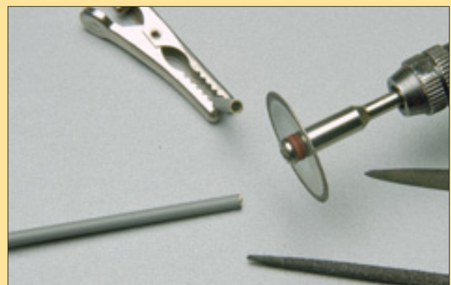
Mit einer Diamanttrennscheibe werden 2,5 cm lange Stücke von den Lampenmasten getrennt und die Ränder entgratet.
