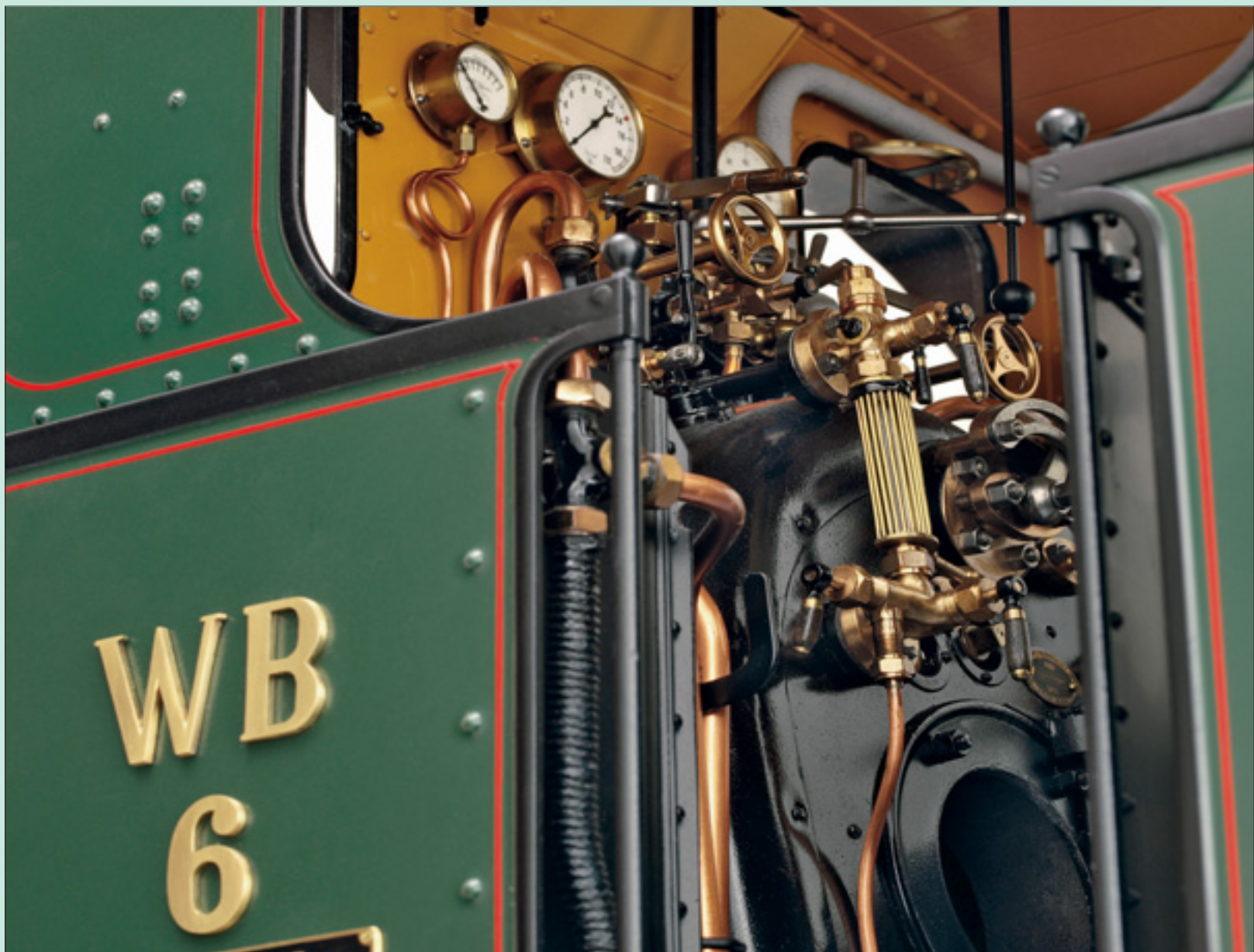
Alle Armaturen im Führerhaus sind minutiös nachgebaut – Echtdampfbetrieb hingegen würde angesichts der Belastungen massivere und vereinfachte Bauteile erfordern. Die Robustheit nimmt eben mit der Verkleinerung überproportional ab. Fotos: Daniel Wietlisbach
