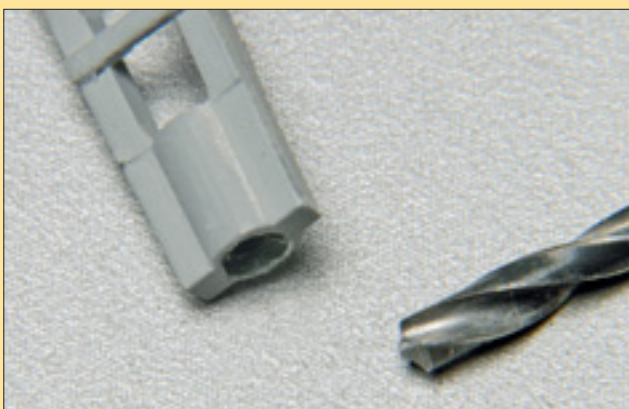
Das Mastende wird zur Aufnahme der Leuchten mit einem 2,5-mm-Bohrer erweitert.
