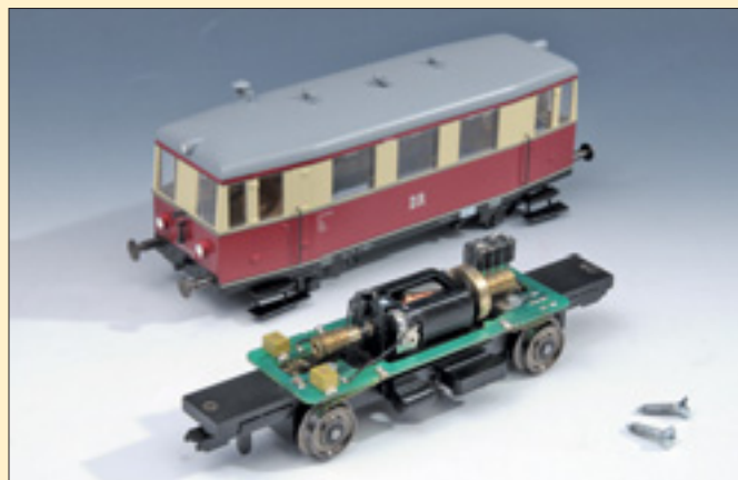
Rechts: Die aktuelle Modellversion in geöffnetem Zustand. Die neue Verschraubung mit selbstschneidenden Alu-Senkkopfschrauben verlangt behutsames Vorgehen bei allen Montagearbeiten. Modellfotos: gg
