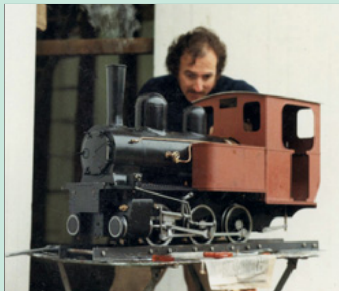
Unter dem freudig-kritischen Blick des Erbauers durfte das noch unfertige Modell auf dem Rollenprüfstand dampfen. Foto: Delaby
