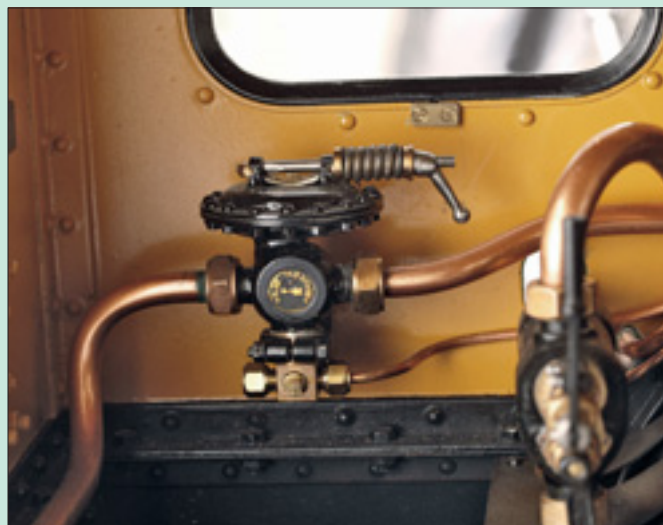
Bremsdruck-Regulierungsventil: nicht funktionell, jedoch maßstäblich. Fotos: Daniel Wietlisbach
