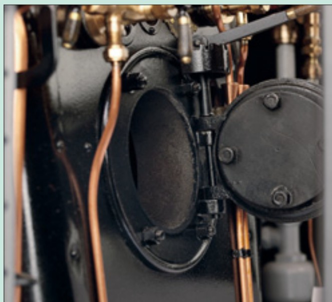
Auch die Feuerbüchse entspricht außen ganz dem Original und ist innen funktionell.
