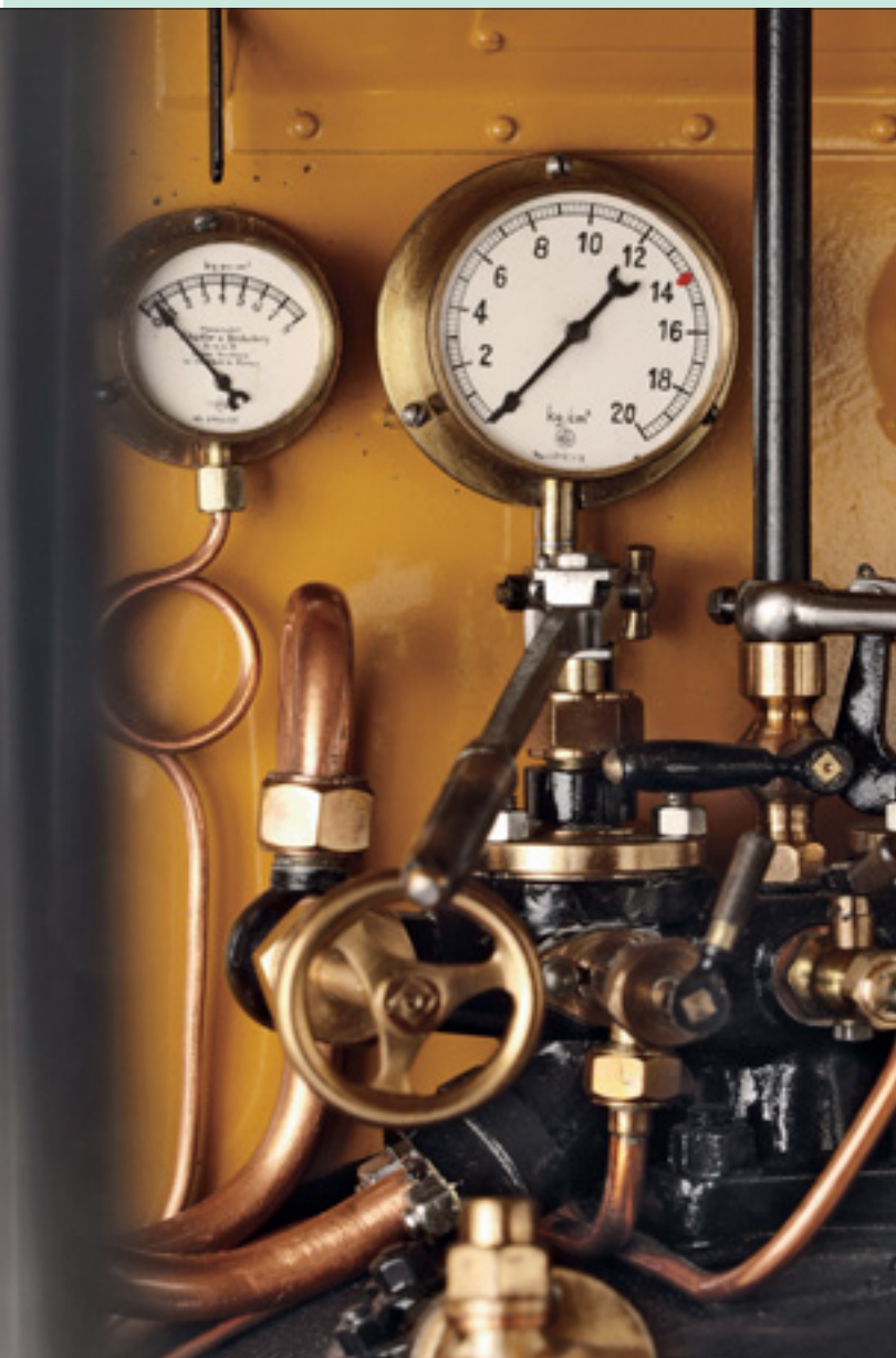
Das Manometer ist exakt originalgetreu – das für den Betrieb erforderliche versteckt sich dahinter.
