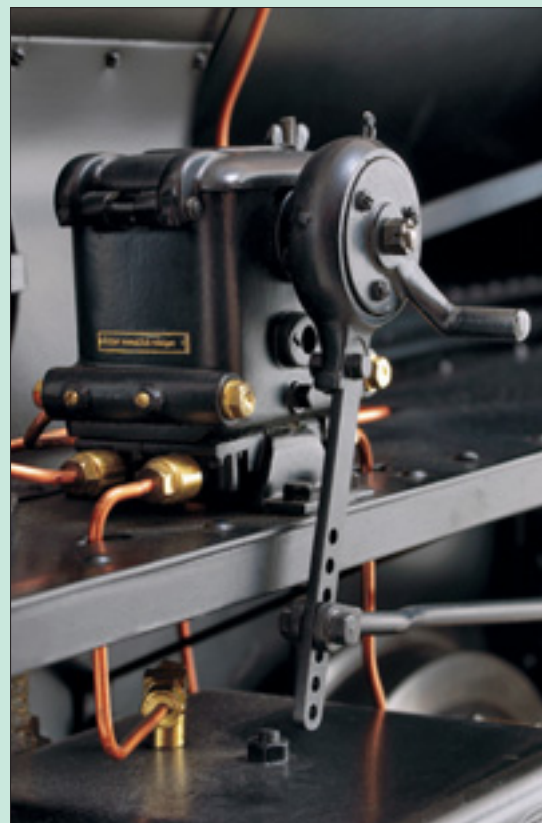
Ein Projekt für sich stellt die selbstverständlich funktionierende Schmierpumpe dar.
