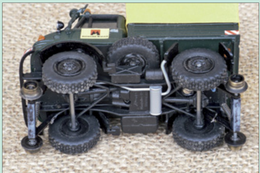
Das Fahrwerk des Unimogs erhielt durchgehende Achsen. Zudem musste der Radstand an die Spurweite des Gleises von 32 mm angepasst werden.
