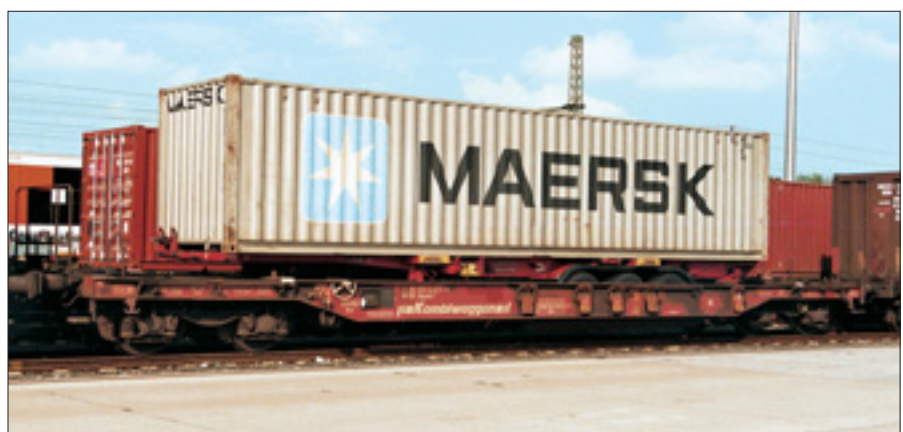
Oben: Der Minitrix-Taschenwagen in 1:160. Oberhalb der Tasche sind zwei Spriegel zu erkennen, die zum Transport von Wechselbrücken gedacht sind.
