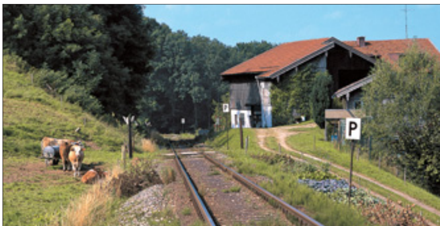
Unten: Beachtenswert ist hier unter anderem das Blinklichtüberwachungssignal als Wiederholer direkt am Bahnübergang. Statt eines Kennlichts besitzt das Signal nur eine retroreflektierende orange kreisrunde Fläche und einen orangen Rahmen. Foto: Burkhard Rieche
