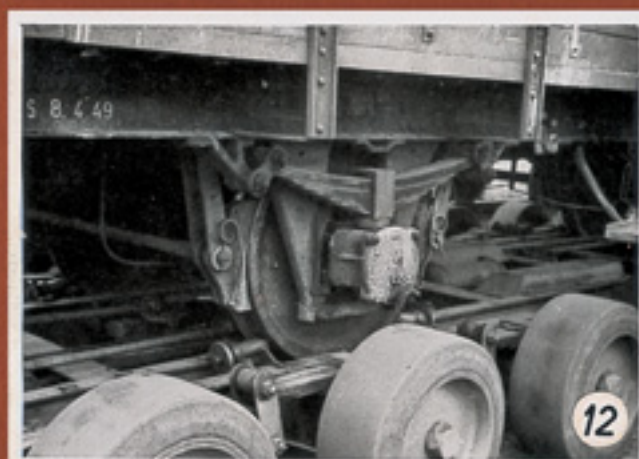
ler ist bereit zur Aufnahme des Wagens. ⑥ Das Zugseil wird über den Roller gelegt. ⑦ Das Zugseil ist eingehängt. ⑧ Die Winde beginnt zu ziehen. ⑨ Der Wagen rollt auf die Rampe. ⑩ Auf beiden Seiten wird das Erreichen der Transportposition beobachtet. ⑪ Das Zugseil wird ausgehängt. ⑫ Die Radsätze sind beidseitig gesichert. ⑬ Der Waggontransport auf seinem Weg. ⑭ bis ⑯ Am Zielort erfolgt das Abladen in umgekehrter Reihenfolge.
