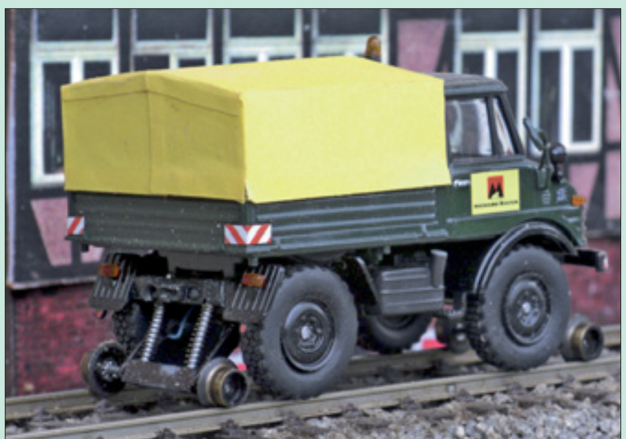
Die Achsen der Eisenbahnlafräder sind über Federn (hier noch ohne Verkleidung) gegen das Chassis abgestützt, damit die angetriebenen Räder auf den Gleisen aufsetzen können.
