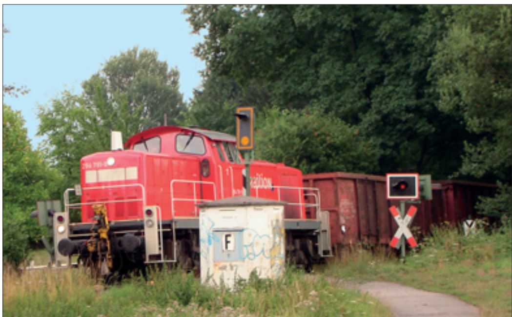
Unten: Beachtenswert ist hier unter anderem das Blinklichtüberwachungssignal als Wiederholer direkt am Bahnübergang. Statt eines Kennlichts besitzt das Signal nur eine retroreflektierende orange kreisrunde Fläche und einen orangen Rahmen. Foto: Burkhard Rieche
