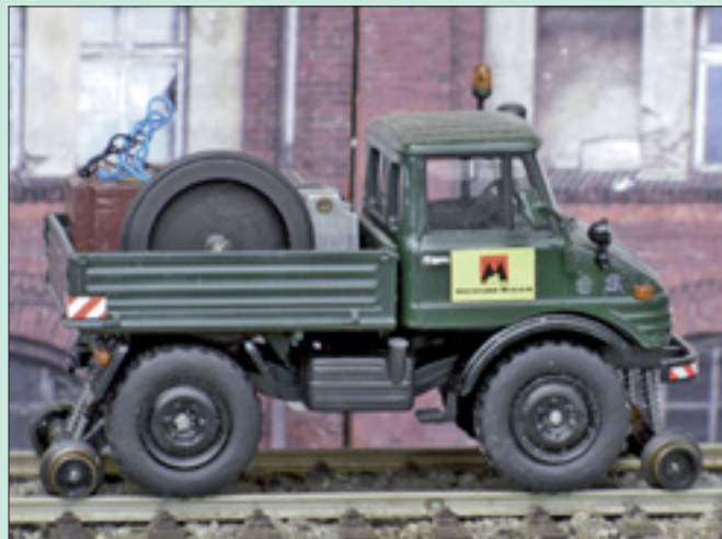
Auf der Hilfs-ladefläche ist der Antrieb aus Faulhaber-Motor, Getriebe und Reibrad untergebracht. Eine Platine dient als Sammelstelle für die Stromabnehmer.
