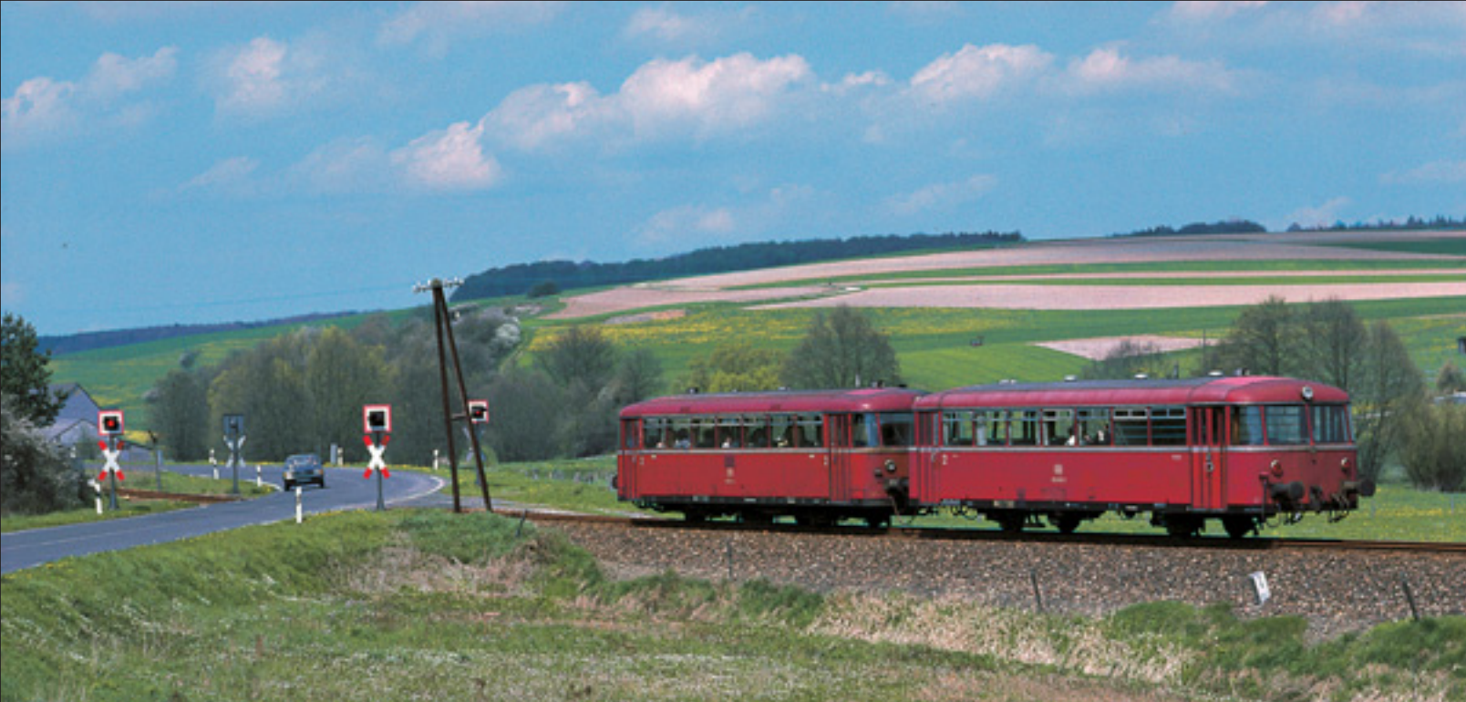
Auf der Fahrt von Külz nach Altekülz nähert sich am 30.4.1983 der Schienenbus der Baureihe 798 mit seinem Beiwagen dem unbeschränkten Bahnübergang, der mit einer älteren Wechselblinkanlage ausgestattet ist.
