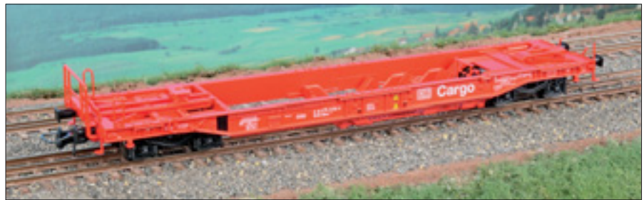
Oben: Rocos Taschenwagen in H0 ist in zahlreichen Varianten gefertigt worden. Die dicke Lackschicht macht das Zurüsten zu einem Geduldsspiel, die Löcher müssen aufgebohrt werden. Modellfotos: Gideon Grimm
