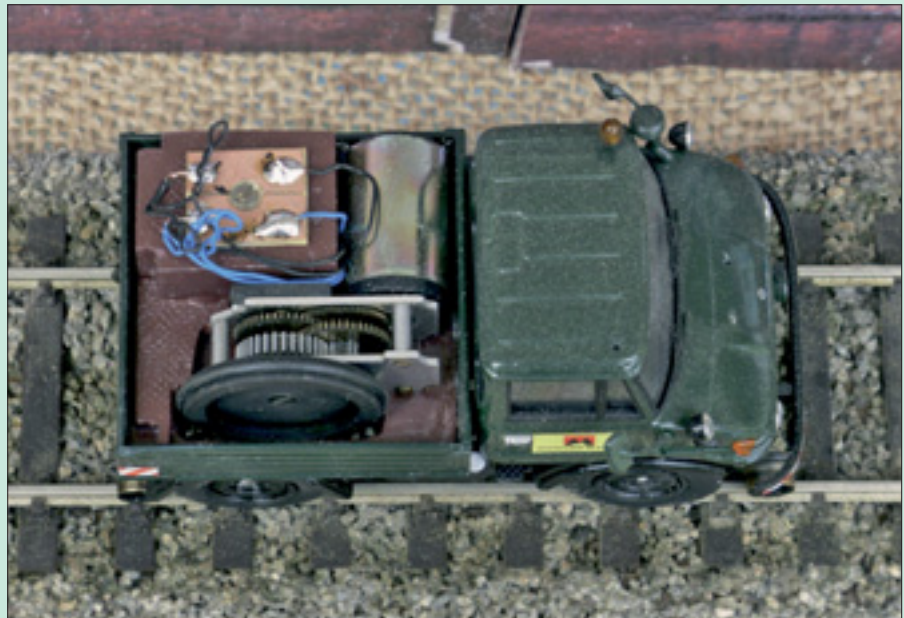
Auf der Hilfs-ladefläche ist der Antrieb aus Faulhaber-Motor, Getriebe und Reibrad untergebracht. Eine Platine dient als Sammelstelle für die Stromabnehmer.
