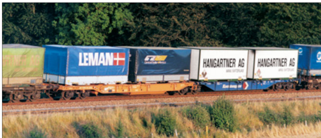
Gelenktaschenwagen des Typs Sdgg-nos744 nahe des dänischen Næstved im September 1991. Lediglich die linke Wagenhälfte kann einen Trailer aufnehmen. Die rechte Hälfte ist Containern oder Wechselbrücken vorbehalten. Auch diese Fahrzeuge waren bei Kombiwaggon eingestellt. Foto: Jan Lundström
