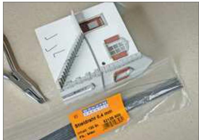
Diffizil gestaltet sich die Erstellung eines halbwegs maßstäblichen Geländers. Zur Verwendung kommt ein 0,4 mm starker Stieldraht.
