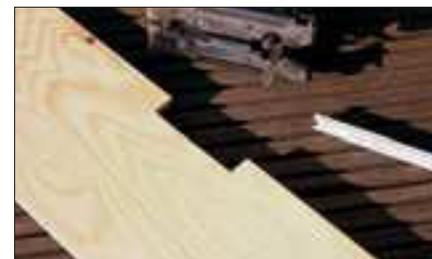
Die Anpassung der Bauteile, wie hier die Einfahrt in den Fiddleyard an den Stirnseiten, erfolgt mit der Stichsäge.
