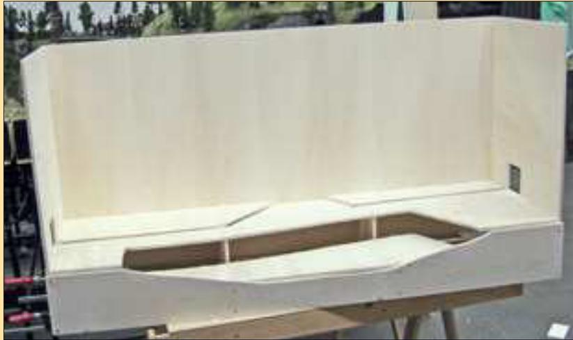
Es geht voran, hier werden die Rück- und die beiden Seitenwände an den Rahmen geleimt – allmählich wird das „Kasperle-Theater“ mit der Bühne für die Züge erkennbar.
