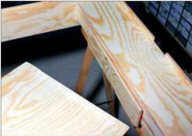
Die über die Schubladenführung mit dem Rahmen verbundenen Bühnengewangen müssen gerade und parallel zur oberen Rahmenkante verlaufen.
