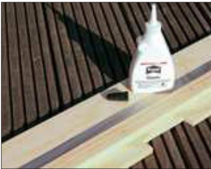
Die Rahmenwangen erhalten Leisten zur Auflage der Deckplatten. Sie werden genagelt und verklebt, geben zusätzliche Stabilität und gewähren Rechtwinkligkeit.
