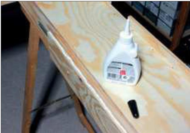
Nachdem die stirnseitigen Bühnengewangen an der Schubladenführung befestigt worden sind, wird die Bühne montiert. Vorsichtig werden die Klebeflächen eingeleimt, um ein ungewolltes Verkleben beweglicher Teile zu verhindern.
