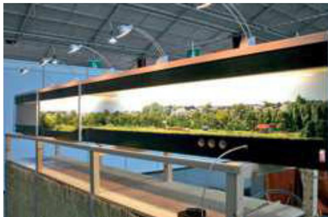
Links: Um bei der N-Anlage „Böhme“ eine gleichbleibende Ausleuchtung zu erreichen, erhielt das Diorama neben der Innenbeleuchtung zusätzlich noch eine Anstrahlung auf der Vorderseite in einem Winkel von ca. 45° schräg von oben.
