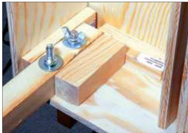
Über die verschiebbaren Ausziehschienen können die Schienenübergänge den anzudockenden Modulen, Segmenten bzw. Anlagen angepasst werden, um Spalten zu überbrücken.
