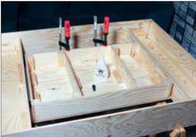
Abschließend wird die Unterseite der Bühne mit Querspannen und Leimhölzern versehen. Schraubzwingen pressen die zu verleimenden Teile zusammen.
