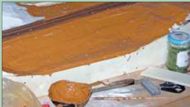
Der Deckel mit der vorderen Blende besteht aus 6 mm starkem Sperrholz. Zur Verstärkung wurde vorne noch ein 10 mm starker Sperrholzstreifen aufgeleimt; hier wird später die Halterung der Leuchtstoffröhre befestigt.
