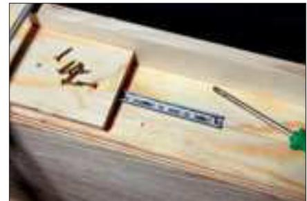
Die Gegenseiten der Schubladenführung werden passgenau an die Innenseiten des Fiddleyard-Rahmens geschraubt.
