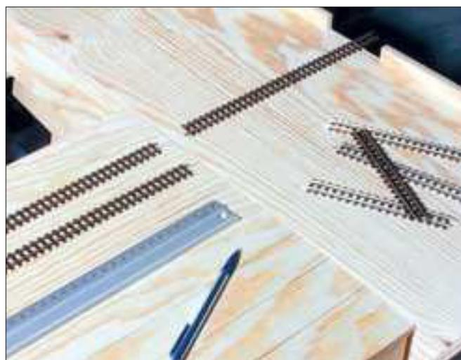
Nach Beendigung des Rahmenbaus wird die Lage der Gleismittelachsen mit einem Bleistift auf Rand- und Bühnenfläche markiert.
