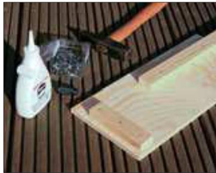
Die Ecken, in denen die Wangen aneinanderstoßen, werden ebenfalls mit Leisten versehen, die parallel zur Außenkante angebracht werden.
