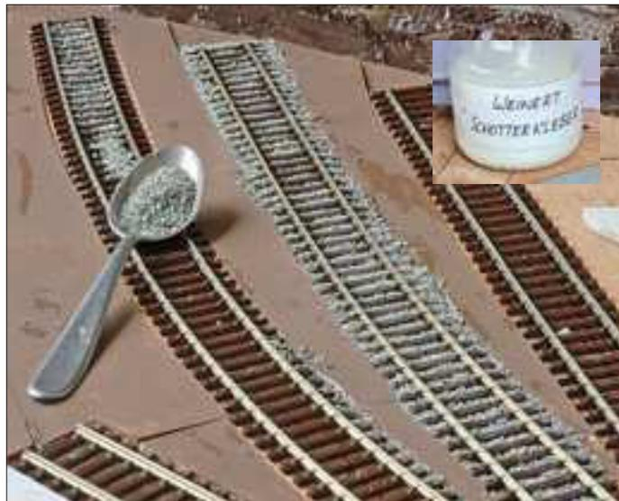
Oben: Die Unterlage für den Gleisbereich bildet feinporiger Industriekork mit einer Stärke von 4 mm.
