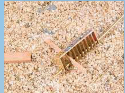
Die Hebelböcke werden zusammengelötet; ein Holzleistchen sorgt für den richtigen Abstand.
