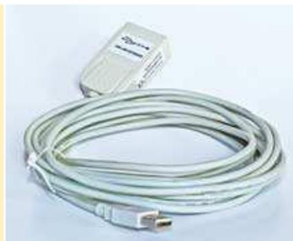
Entfernungen bis zu 5 Metern können direkt mit einem USB-Kabel überbrückt werden. Für größere Distanzen ist ein sogenannter USB-Repeater erforderlich. Maximal fünf solcher Repeater können hintereinandergeschaltet werden.
