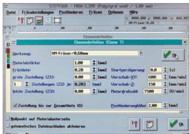
Rechts: Die Reihenfolge der zu fräsenden Ebenen wird in einer Liste angezeigt und kann hier nochmals verändert werden.
