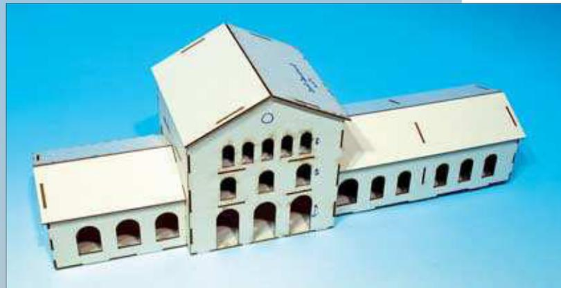
Nach der Konstruktion der Basisteile erfolgte die Überprüfung der Passmaße mithilfe eines 3D-Programms, während daneben schon der erste Prototyp in der noch unverkleideten Grundaussführung steht – es war dann noch eine Änderung der Fenster notwendig.
