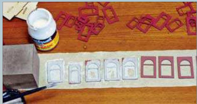
Die Deckschichtbögen erfordern ebenso wie die Fenster eine Farbbehandlung. Diese fiel bei der Sandsteinfassade recht umfangreich aus, weil einzelne Schmucksteine hervorgehoben werden mussten. Wichtig ist die Verwendung einer dünnflüssigen, aber gut deckenden Farbe, z.B. von Tamiya. Die umlaufenden Simse entstanden aus Polystyrolstreifen von Evergreen. Das Material muss vor der Farbgebung mit einer Kunststoffgrundierung versehen werden, um ein späteres Abplatzen der Farbe zu verhindern.
