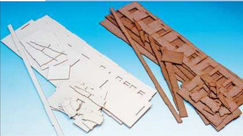
Beim Güterschuppen wurden vergleichsweise zwei Materialien für die Basiskonstruktion ausprobiert: Finnpappe und MDF-Platten. Letztere versprechen etwas mehr Stabilität, feuchtigkeitsempfindlich sind sie aber beide.
