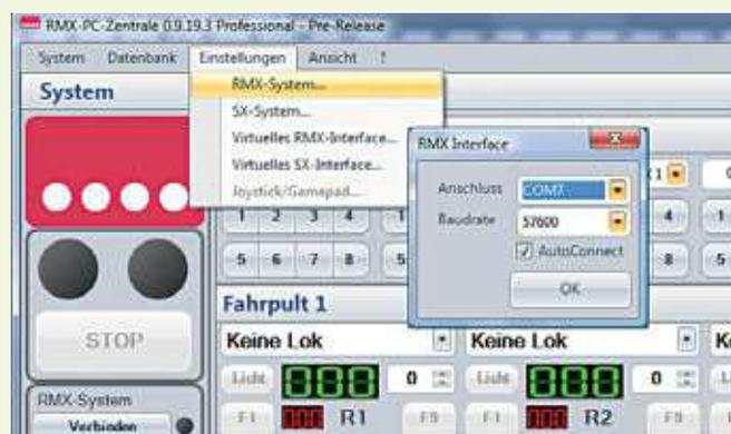
Beim erstmaligen Programmstart ist anzugeben, an welchem Schnittstellen-Port des PC und wie schnell das rautenhaus digital-Interface betrieben wird. Nach Betätigen der Schaltfläche „Verbinden“ ist das System betriebsbereit.
