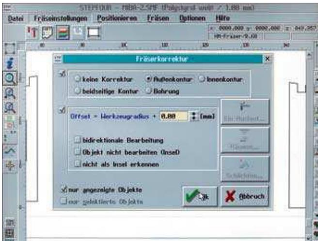
Für jede zu fräsende Linie der Zeichnung muss angegeben werden, ob der Fräser außen oder innen entlangfahren muss.
