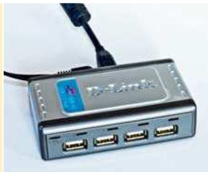
USB-Geräte lassen sich aus dem USB-Bus mit Strom versorgen (USB host powered). Dazu stehen gemäß Spezifikation je USB-Anschluss 500mA zur Verfügung – die sich bei einem USB-Hub ohne eigene Stromversorgung auf alle nachfolgenden Anschlüsse aufteilen.
