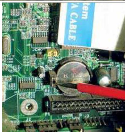
Rechts: Beim Kauf einer neuen Batterie auf den gleichen Typ achten. Hier geht es neben der Größe der Batterie auch um deren Spannung. Ist diese zu niedrig, arbeitet der Speicher nicht, ist sie zu hoch, kann der Speicher Schaden nehmen.
