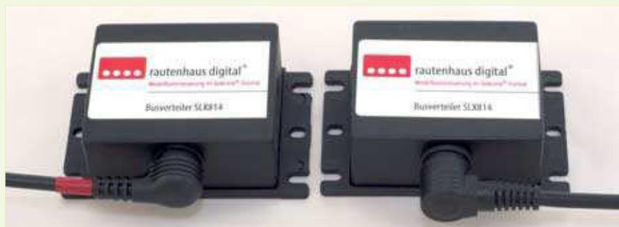
Die beiden Busse des RMX-Systems (RMX 0-Bus für den Übermittlung der Lokbefehle und RMX 1-Bus für den Austausch von Schalt- und Meldeinformationen) müssen strikt getrennt werden. Um Verwechslungen in der Unterwelt zu vermeiden, empfiehlt es sich, die Datenbus-Kabel farblich zu markieren. Die Markierung wurde im Bild unmittelbar am Stecker mit Isolierband angebracht. Die Kabel selbst unterscheiden sich nicht und sind mit denen des Selectrix-Systems identisch.
