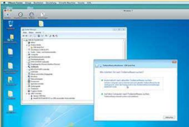
1. Windows 7 läuft hier unter VMware Fusion. So wird der Gerätetreiber von Hand installiert: Man klickt bei gedrückter Befehlstaste (oder mit der rechten Maustaste) das unbekannte Gerät im Gerätemanager an und wählt „Treiber aktualisieren“. Daraufhin muss man den Ort angeben, wo die Treiberdatei liegt.
