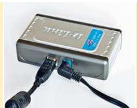
Bei stromhungrigen Verbrauchern sollte man daher zweckmäßigerweise einen USB-Hub mit eigenem Netzteil einsetzen, der die Spannungsversorgung seiner und der nachfolgenden Anschlüsse übernimmt.
