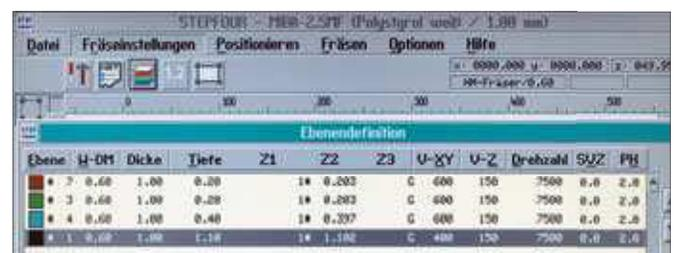
Für die verschiedenen Ebenen (Linienfarben) müssen Fräserdurchmesser, Frästiefe, Zustellung, Vorschub und dergleichen eingegeben werden.
