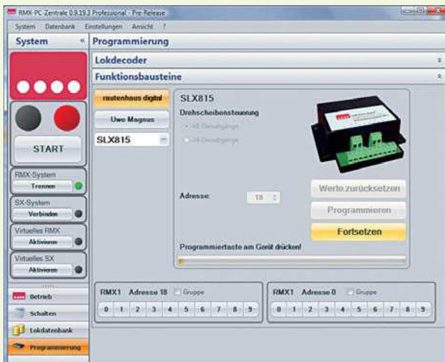
In der Ansicht „Programmierung“ können Lokdecoder (das Menüfenster ist hier ausgeblendet) und Funktionsbausteine programmiert werden. Während der Programmierung muss der Anlagenbetrieb ruhen, es dürfen keine Schaltbefehle über den RMX 1-Bus gesendet werden.
