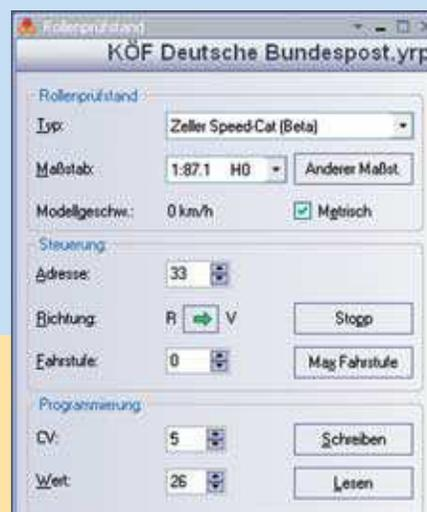
Bei der Verwendung des TrainProgrammers lassen sich die CVs zum Einstellen der Geschwindigkeit sowie von Anfahr- und Bremsverzögerung auch gleich aus dem TrainController heraus programmieren.
