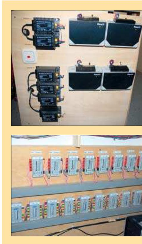
Übersichtliche Anordnung der elektrischen/elektronischen Bauteile, hier (links) die Booster
