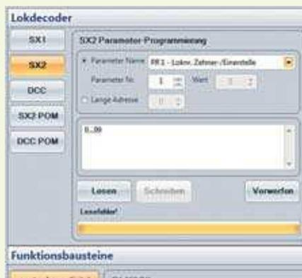
Die aus dem DCC-Bereich bekannte CV-Programmierung findet sich auch in den SX2-Decodern unter dem Namen „Parameter-Programmierung“ wieder. Die standardisierten CVs werden im Klartext und mit Erläuterungen angezeigt, die anderen können über Direktwahl programmiert werden. Hier wurde die Lautstärke des in der Minitrix V 300 eingebauten DHS220-Decoders auf ein erträgliches Maß eingestellt, indem der Wert für die CV mit der Nummer 902 verringert wurde.
