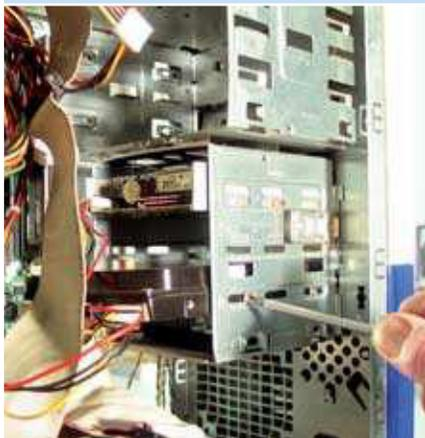
Links: In einem Montagekäfig eingesperrt lassen sich die Daten der Festplatte nicht ablesen. Sie muss daher ausgebaut werden.
