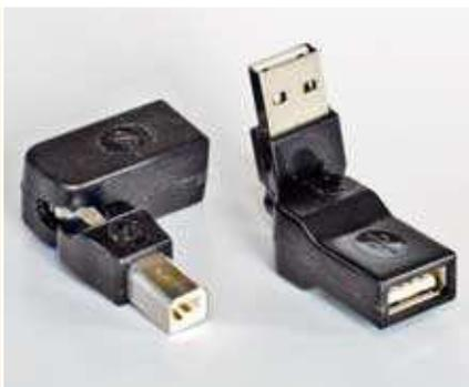
Sind USB-Anschlüsse nur schwer zugänglich, helfen Adapter weiter, die in alle Richtungen abgewinkelt werden können. Sie sind sowohl für A-Stecker als auch B-Stecker erhältlich und besitzen am anderen Ende das entsprechende Gegenstück als Buchse.
