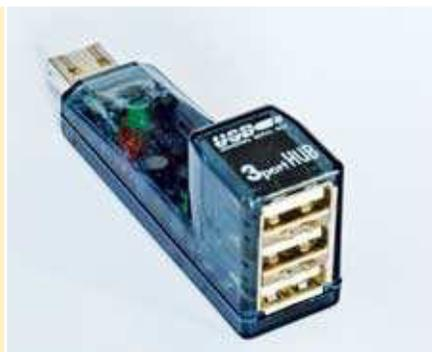
Um einen USB-Bus auf mehrere Anschlüsse aufzuteilen, verwendet man einen USB-Hub. Diese existieren in sehr kompakten Bauformen. Zu beachten ist dabei, dass sich die Anschlüsse die maximale Datenübertragungskapazität teilen müssen.
