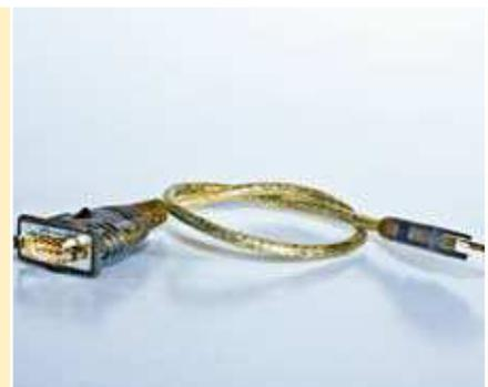
Zum Anschluss altgedienter Geräte mit serieller Schnittstelle (RS-232) – wie zum Beispiel die Interfaces digitaler Modellbahnsteuerungen – gibt es entsprechende Adapter. Die Einstellung der Übertragungsparameter erfolgt in der Systemsteuerung.
