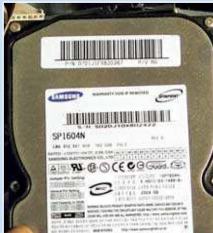
Funktioniert die automatische Erkennung nicht oder kann man die Daten der Platte nur manuell eingeben, sind Daten wie Cylinders, Heads (Köpfe) und Sectors/Track anzugeben. Diese Angaben findet man auf dem Typenschild der Festplatte.
