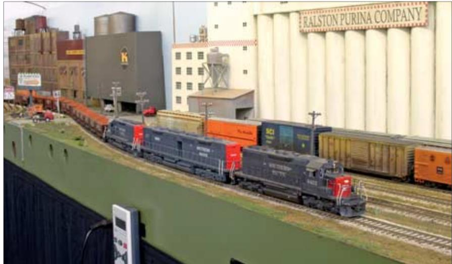
Segmentanlagen haben keine universellen Schnittstellen, sondern passen immer nur an einer ganz bestimmten Stelle aneinander. Sie können – im Gegensatz zu Modulanlagen – nicht willkürlich angeordnet werden, sondern immer nur in einer vorgegebenen, festen Reihenfolge. Gleichwohl sind sie ebenfalls zerlegbar und transportabel (Anlage: New Ponca Yard).
