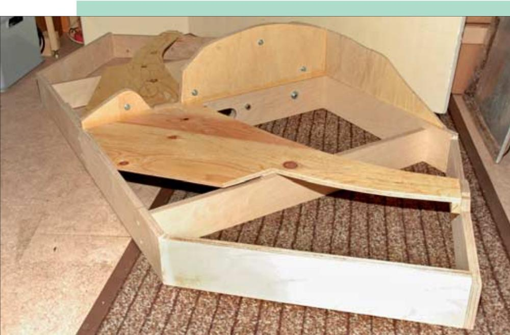
Die beiden Modulkästen entstanden aus stabilem Multiplex-Sperrholz. Das Profil der Landschaft wurde separat aus dünnerem Sperrholz aufgesetzt – das erleichtert den Zuschnitt des Rahmens. Rechts: Der Gleisbau kann beginnen. Die Unterlage für die Schotterbettung wurde aus einer 5 mm starken Styrodurplatte geschnitten; darauf konnte dann die am Computer entstandene Gleisschablone geklebt werden. Sie zeigt den vorbildgerechten Schwellenabstand sowie die Doppelschwellen unter den Schienenstößen.
