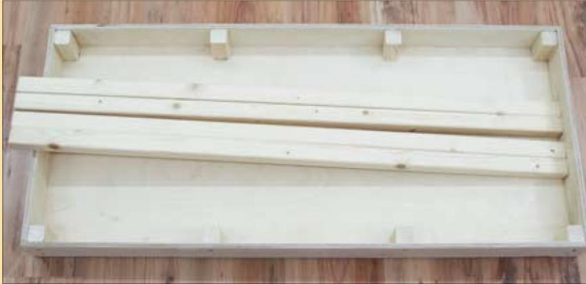
Nach den vier Seitenteilen werden noch acht Stützhölzer verleimt und zusätzlich verschraubt, um eine höhere Stabilität zu erreichen, schließlich werden Module häufig transportiert. Wer einen Bandschleifer besitzt, kann noch etwaige Unebenheiten bei den Stoßkanten der Multiplexplatten eliminieren.
