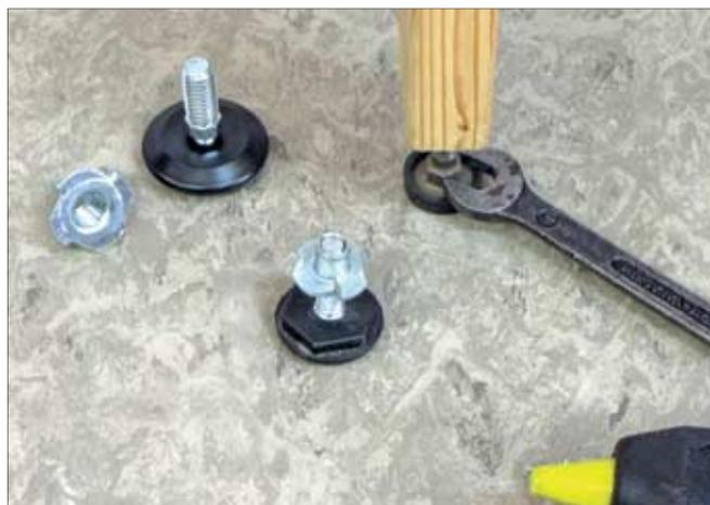
Höhenverstellbare Beine haben sich bewährt, sie können Bodenunebenheiten ausgleichen. Einschraubfüße in Verbindung mit Einschraubmutter (oder Rambamuffen) können dann bequem und fein mit einem Maulschlüssel justiert werden. Gegen Herausfallen der Einschlagmutter hilft etwas Heißkleber.
