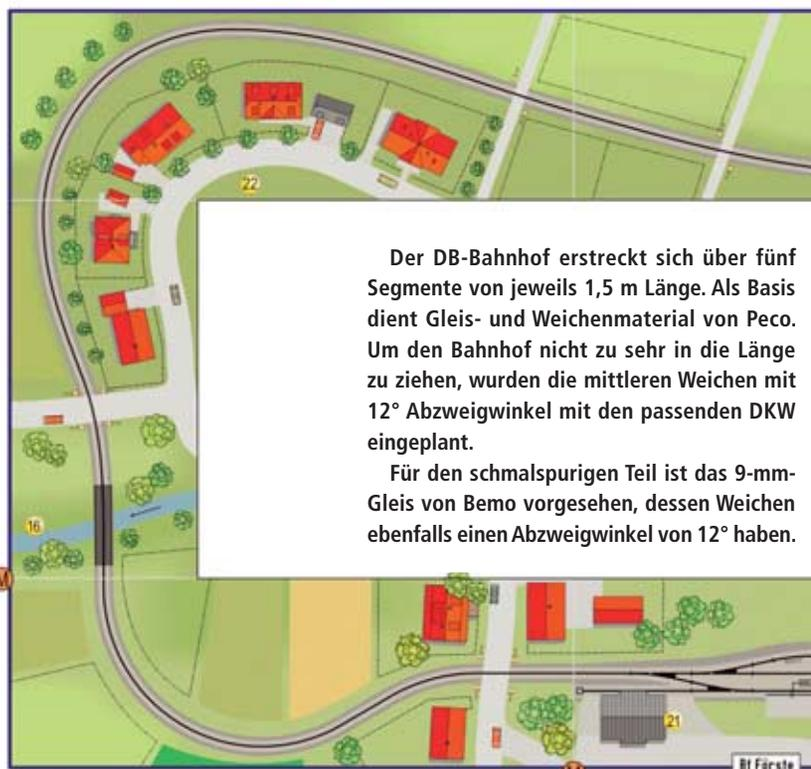
Der DB-Bahnhof erstreckt sich über fünf Segmente von jeweils 1,5 m Länge. Als Basis dient Gleis- und Weichenmaterial von Peco. Um den Bahnhof nicht zu sehr in die Länge zu ziehen, wurden die mittleren Weichen mit 12° Abzweigwinkel mit den passenden DKW eingepplant.
