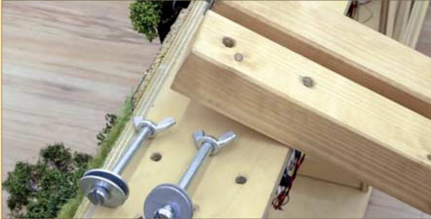
Eine relativ einfach anzufertigende Ausführung der Beinbefestigung: jeweils zwei Löcher im Bein, zwei Löcher in den Ecken des Moduls, verbunden mit zwei Schrauben M6 inkl. Karoseriescheiben reichen für einen stabilen Stand aus. Die Beine sind am anderen Ende mit verstellbaren Füßen versehen, um etwaige Unebenheiten des Fußbodens auszugleichen.
