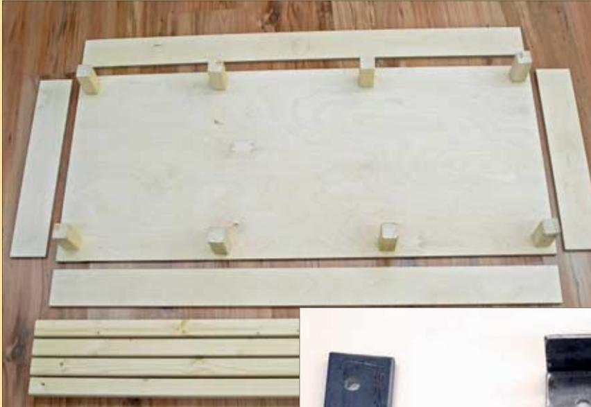
Nach dem Einkauf im Baumarkt wird das Material auf Rechtwinkligkeit und Maßhaltigkeit geprüft. Aus meiner bisherigen Erfahrung heraus ist der Zuschnitt stets korrekt. Vor Beginn der Arbeit werden die Kanten noch leicht mit Schleifpapier gebrochen, um Verletzungen zu vermeiden.
