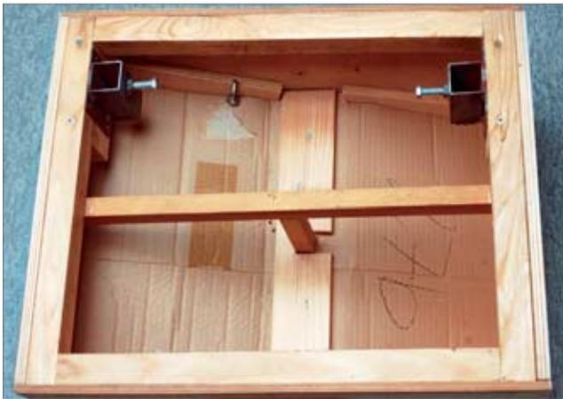
Kleines Prüf- bzw. Messmodul. Es dient beim Bau als Schablone für die Bohrungen der Verbindungsschrauben und zur Justierung der Trassenhöhe.
