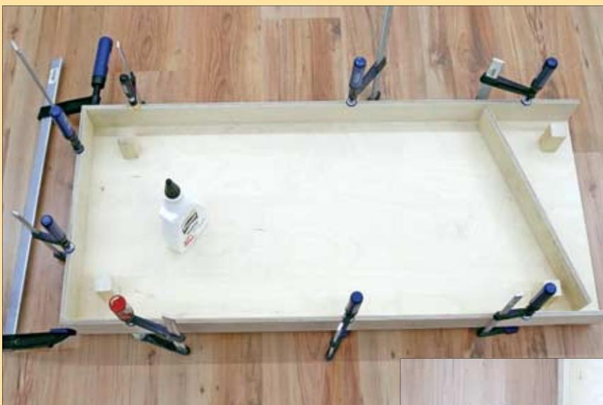
Das Werkzeug für den Bau hält sich in Grenzen. Einige Schraubzwingen sind notwendig, um den zu verleimenden Seitenrand auf dem Moduldeckel zu fixieren. Ein genauer Zuschnitt ermöglicht eine einfache, passgenaue Montage der Einzelteile.
