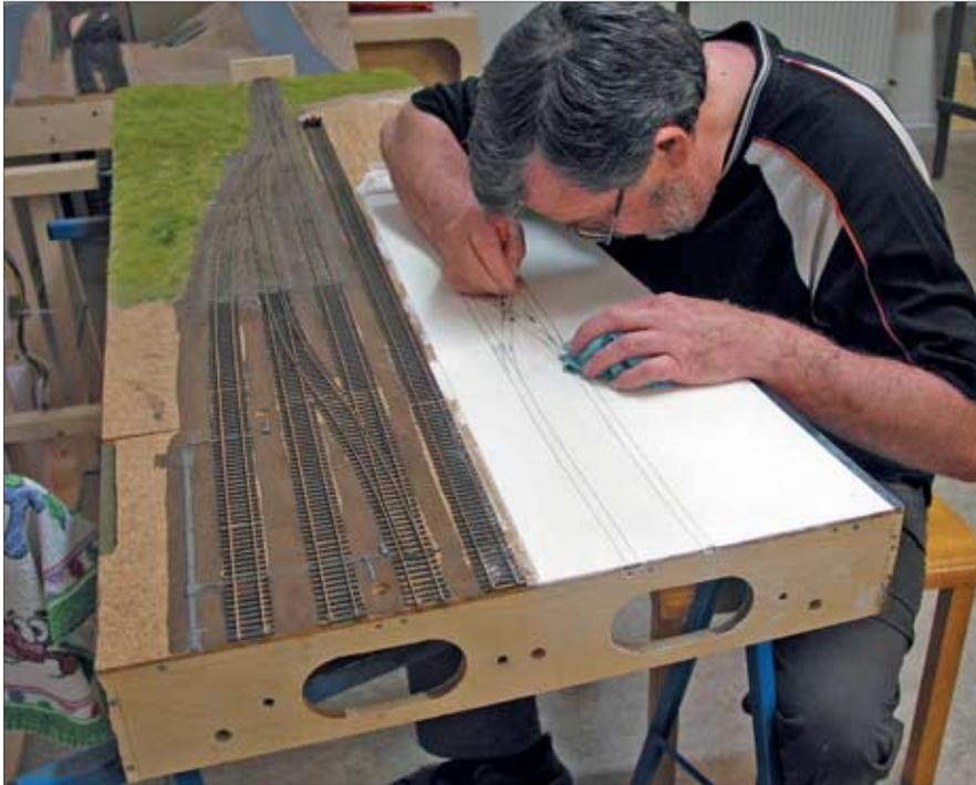
Segment 6 ist derjenige Endpunkt des Bahnhofs mit dem Fremo-Übergang. Zum Bahnhof hin ist das Gleisfeld auf vier Gleise angewachsen. Klaus ritzt gerade die Gleise in der Betonfläche (Keramin) des Schwellenwerks frei.
