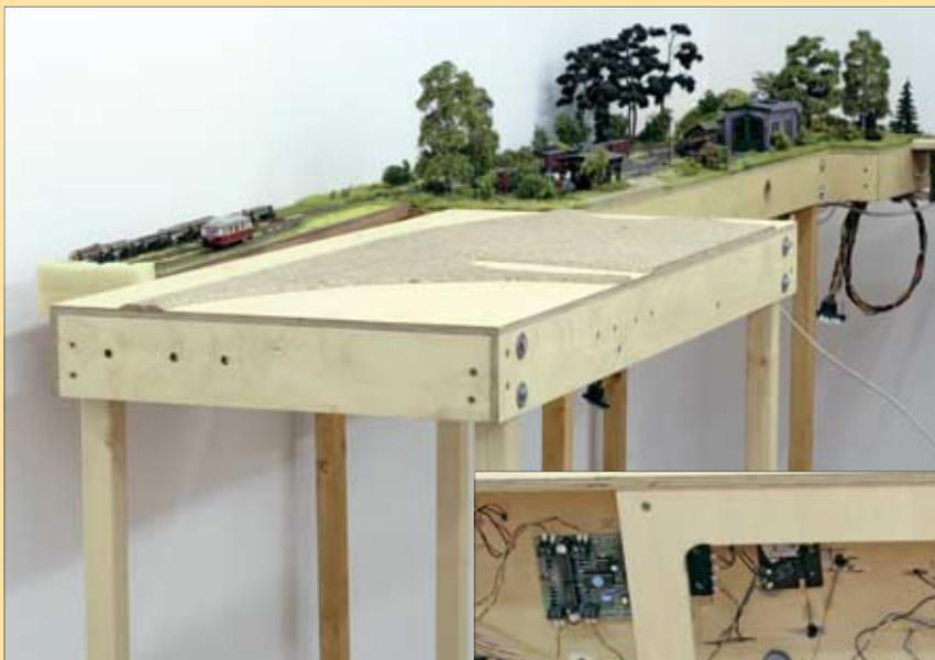
Hier sieht man, warum für die Modulschnittstellen auf einer Seite nur drei Löcher gebohrt wurden. Auf der linken Seite ist kein Platz mehr für ein viertes Loch. Dies deckt die Modulnorm ab. Bei Anschluss eines anderen Moduls könnten immerhin noch drei Schrauben Verwendung finden, was für die Stabilität leicht ausreicht. Meistens werden sowieso nur die beiden äußersten Löcher mit Schrauben bestückt.
