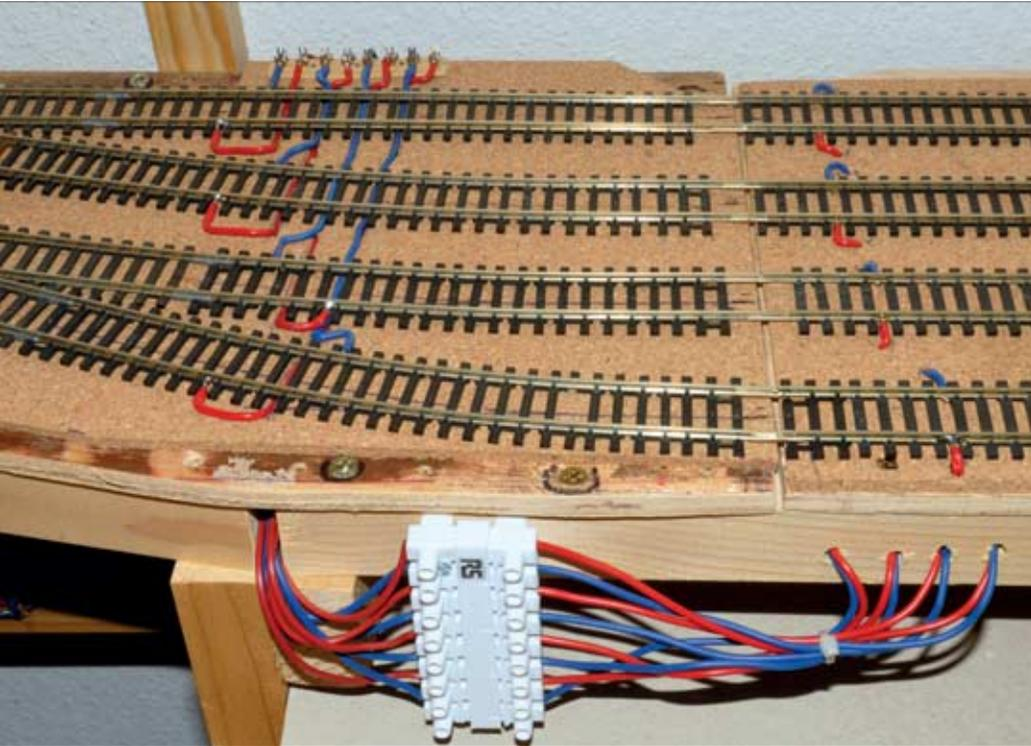
Die Weichen zum Schattenbahnhof bilden ein demontierbares Segment; dadurch lässt sich die Weichenstraße bequem am Werkstisch bearbeiten. Die Steckverbindung dient dem Fahrstrom.
