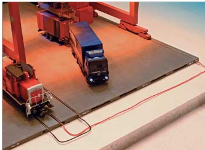
Lade- und Krangleise werden gemeinsam an das DCC-System angeschlossen; den Containerkran kann man dann direkt über die Adressen 4 und 5 steuern. Der Faller-Lkw hat hier bereits einen Container mit frischen Akkus bekommen und kann nun mit strahlenden Scheinwerfern weiterfahren ...
