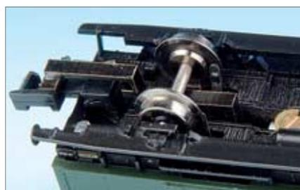
Links: Der Hebel führt zwischen Achse und KK-Kinematik zur Kupplung.
