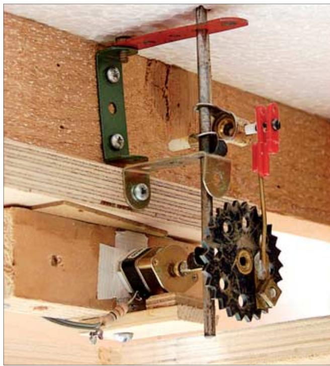
Das Geheimnis der Funktionswagen enthüllt: An der für den Betrachter unsichtbaren Rückseite des Waggons wirkt ein Magnet auf einen Blechstreifen ein, dadurch öffnet sich die Dachklappe. Nach der „Beladung“ wird der Magnet in die Rampe zurückgezogen, die Klappe fällt zu. Im Bild darunter der Antrieb für die Bewegung des Magneten. *Fotos: Ton Janssen*
