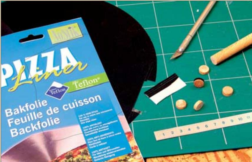
Im Foto links die „Zutaten“ zur Anfertigung von Umlenkrollen „à la Gérard“: aus einem 12-mm-Stock gesägte Holzscheiben und aus einer schwarzen NoStik-Backfolie geschnittene Teflon-Streifen. Die Streifen sind mit doppelseitigem Klebeband auf der Zylinderfläche der Holzscheibe zu befestigen.
