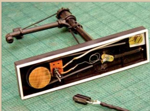
Der MDA passt exakt in den inneren Raum des Betonsockels vom Wasserkran. Für den elektrischen Kontakt sorgt eine winzige, trennbare Steckverbindung.
