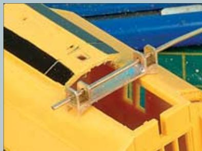
Für die Auslegerabspannung wurde eine neue Haltetraverse angefertigt; sie entstand aus passend zurechtgefeilten 4 mm breiten Messing-U-Profilen.
