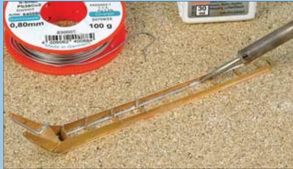
Nachdem die Ausrundung des oberen Deckblechs stimmte, konnten die Seitenteile mit einigen Löt-punkten angeheftet werden. Danach wurden die Querbleche eingesetzt und alles komplett verlötet.
