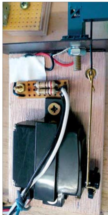
Anstelle des motorischen Antriebs wurde ein Servo auf das senkrecht an der Montageplatte befestigte Sperrholzbrett geschraubt. Das „Ösengelenk“ kompensiert die Auslenkung des Servofingers. Foto: Peter Urban
