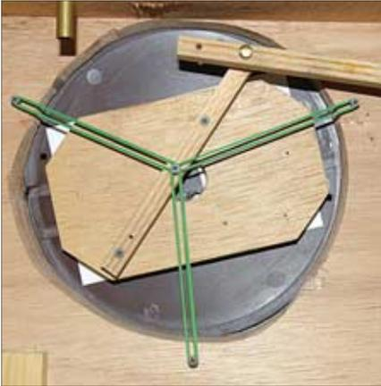
Zunächst mal die unmotorisierte Lösung: Da die Original-Kibri-Scheibe wirklich nur eine flache Scheibe ohne jede zentrale Lagerung ist, lässt sie sich mit einem einseitig angreifenden Hebel nur hakelnd drehen. Abhilfe schafft eine elastische zentrale „Lagerung“ mittels einfacher Haushaltsgummis.
