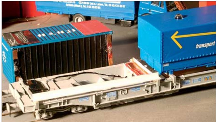
Zwei weitere Blechstreifen auf der Ladefläche sorgen für den Kontakt zum Container, auf dem die korrekte Polung außerdem mit gut sichtbaren Farbflächen markiert wurde. Im zweiten Container rechts findet die Schaltung zum Aufladen der Akkus Platz.
