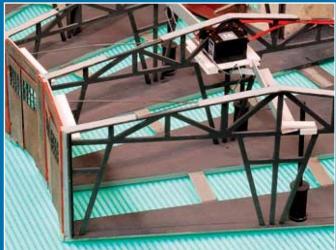
Das Ruderhorn des Servos überträgt seine Kraft auf einen im Dach untergebrachten Hebel, der den Stellweg reduziert. Der Hebel hat seinen Drehpunkt im gegenüberliegenden Tragwerk. Mittels Stellstangen wird nun der Stellweg auf die Türflügel übertragen.
