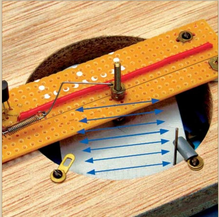
Hier nun, von „unten“ betrachtet, die physikalische Erklärung dieses Prozesses: In seiner Grundstellung wird der Entkupplungsmagnet durch eine Feder gehalten. Dadurch verlaufen die magnetischen Feldlinien (hier dargestellt als blau eingezeichnete Pfeile) nahezu parallel zur Gleisachse; eine seitliche Krafteinwirkung auf die Kupplungen ist ausgeschaltet.
