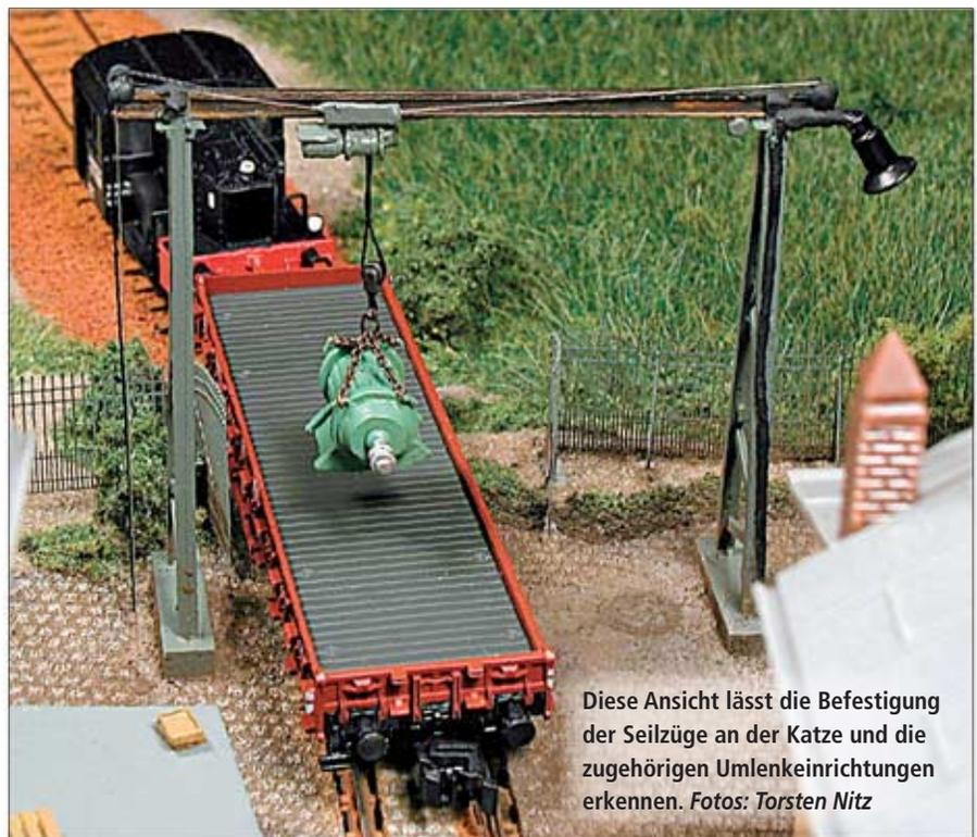
Diese Ansicht lässt die Befestigung der Seilzüge an der Katze und die zugehörigen Umlenkeinrichtungen erkennen. Fotos: Torsten Nitz
