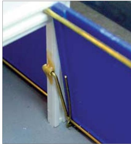
1-mm-Röhrchen dienen als Lager für den Hebel. Am Tor halten Messingdrähte den Bügel. Rechts oben: Die Zahnstange hat einen Schlitz zur Aufnahme des Bügels. Der Endabschalter wird durch die Stange direkt betätigt.
