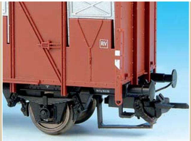
Links: Im Endbahnhof wird, nachdem die Reisenden den Zug verlassen haben, die Kupplung des Gepäckwagens betätigt und die 74er kann zum Ergänzen der Vorräte vom Zug abrücken. Man erspart sich hässliche Entkupppler im Gleis und muss trotzdem nicht in die Anlage eingreifen. Je nach gestaltetem Umfeld läuft man auch nicht Gefahr, mit dem Ärmel Telegrafmasten oder Bahnhofslaternen „niederzumähen“.
