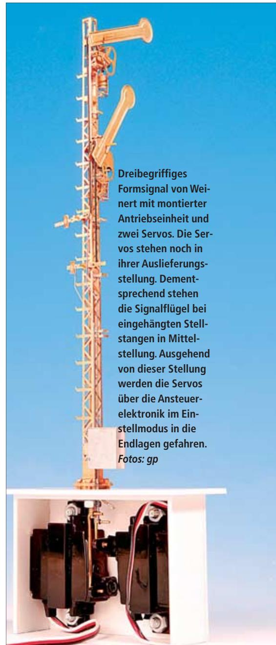
Dreibegriffiges Formsignal von Weichert mit montierter Antriebseinheit und zwei Servos. Die Servos stehen noch in ihrer Auslieferungstellung. Dementsprechend stehen die Signalfügel bei eingehängten Stellstangen in Mittelstellung. Ausgehend von dieser Stellung werden die Servos über die Ansteuer elektronik im Einstellmodus in die Endlagen gefahren. Fotos: gp
