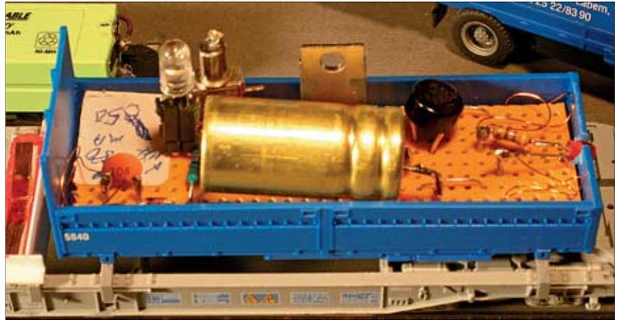
Die kleine Schaltung zum Aufladen der Akkus findet leicht in einem Container oder – wie hier – einem Lkw-Auflieger Platz. Der gelbe Zylinder in der Bildmitte ist das Elko, dahinter ist IC 317 eingelötet. Bei größeren Ladeströmen kann auch noch ein Kühlkörper vorgesehen werden. Legt man sich auf einen Ladestrom fest (50 oder 80 mA), ist der Umschalter auf dem Schaltplan natürlich nicht notwendig.
