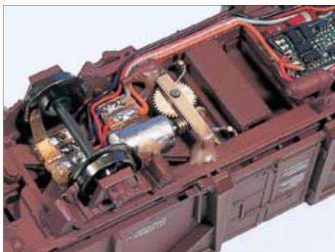
Martin Knaden hat diesen Liliput-F-dz-72 durch einen Minimotor in der Horizontalen bewegbar gemacht. Angesteuert wird er durch einen DCC-Lokdecoder (MIBA-Spezial 63). Einziger Wermutstropfen: die H0-Briketts sind härter als das Vorbild, sodass sie die Rückkehr in die Grundposition nachhaltig behindern können. Und von händischer Hilfe im H0-Maßstab müssen wir immer noch absehen.
