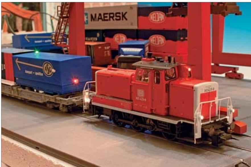
Auf dem Schaustück des Autors wurde mit dem Schaltgerät von Heljan außer dem Kran auch die Lok gesteuert. Die hier zu sehende 365 von Roco besitzt neben dem Licht auch eine fernsteuerbare Kupplung. Die rote LED am Container zeigt, dass die DCC-Spannung am Gleis anliegt, die grüne LED, dass die Akkus geladen werden.
