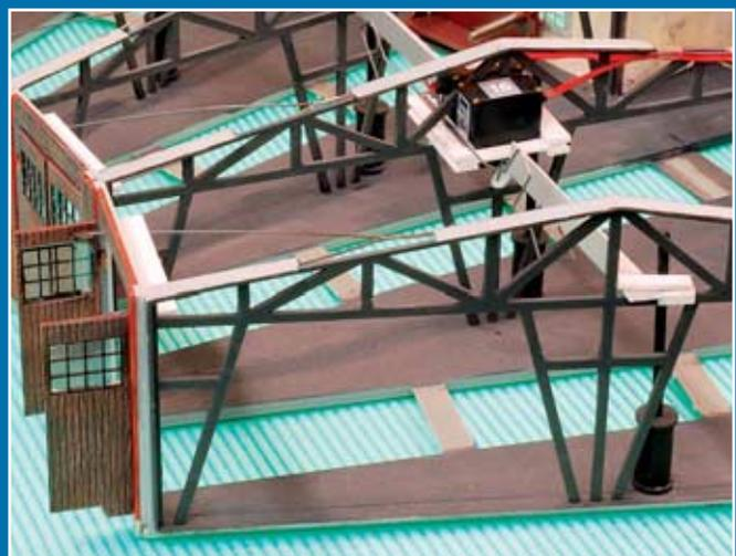
Jedes zweite Ständerwerk nimmt zwei Servos auf. An der Servohalterung ist zudem ein Draht mit einer Öse befestigt, um die Stellstange zum Schuppentor zu führen.
