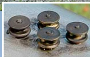
*Wer schon einmal einen Kühlwagen beobachtet hat, wird bemerkt haben, dass sich auf dem Dach seltsame Gebilde im Wind drehen. Diese Bauteile sind sog. Flettner-Lüfter, deren Aufgabe darin besteht, für einen beständigen Luftzug im Inneren des mit Stangen-eis gekühlten Wagens zu sorgen. Stefan Seim wollte an seinem Kühlwagen von Klein Modellbahn auch so einen Effekt sehen. Er beschreibt hier, wie gut er den Dreh raus hat.*
