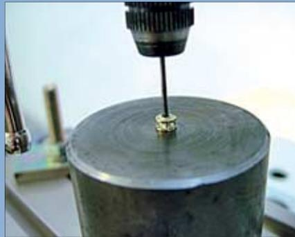
Damit die Lüfter sich auch schön gerade drehen, sollte die Bohrung unbedingt mit einer Ständerbohrmaschine erfolgen. Nur so ist ein genau senkrecht Loch gewährleistet.
