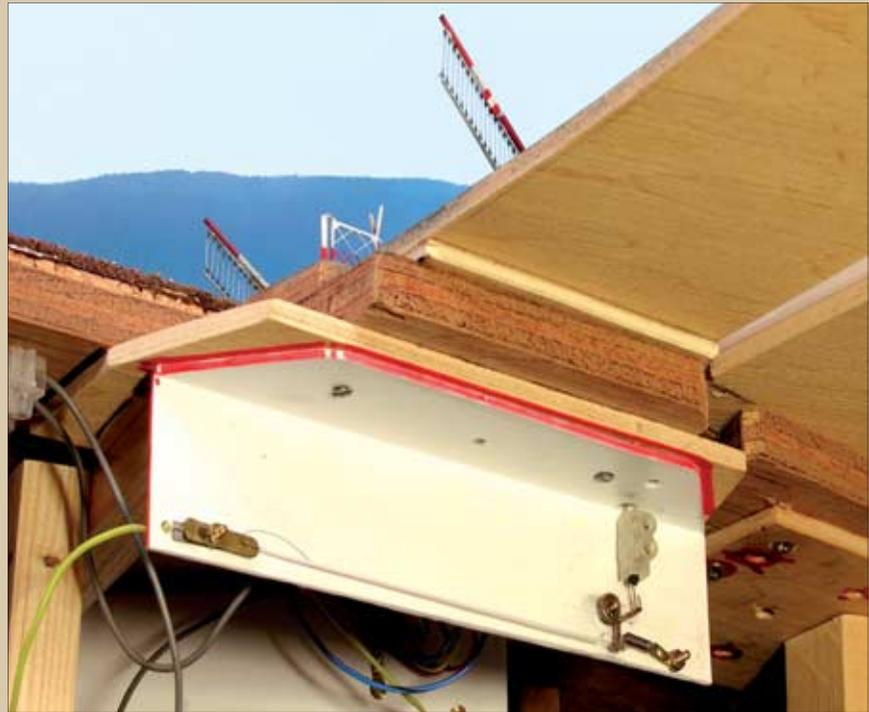
Der vordere Unterflurantrieb aus unmittelbarer Nähe. Der Memory-Draht arbeitet horizontal; die Bewegung wird durch eine 90°-Umlenkung vertikal umgewandelt und durch das Grundbrett zur Schranke geführt – einfacher gehts nicht!
