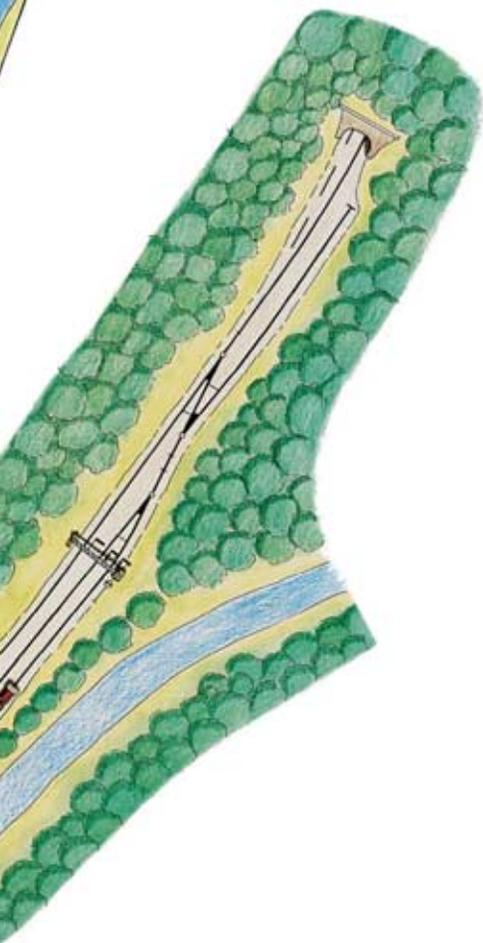
Der „kleine“ Entwurf, wiedergegeben im Maßstab 1:38 für H0 (Abmessungen ca. 4,10 x 3,70 m). Weichenwinkel in den Hauptgleisen 12°, in den Nebengleisen und dem frei zugänglichen Schattenbahnhof 15°. Gestaltung des Bahnhofsumfelds wie im „großen“ Entwurf. Die Häuser über dem Tunnel in Ri. Trier sind zwecks perspektivischer Verkürzung absichtlich kleiner als H0 gehalten (wie von Jacques Le Plat angeregt).
