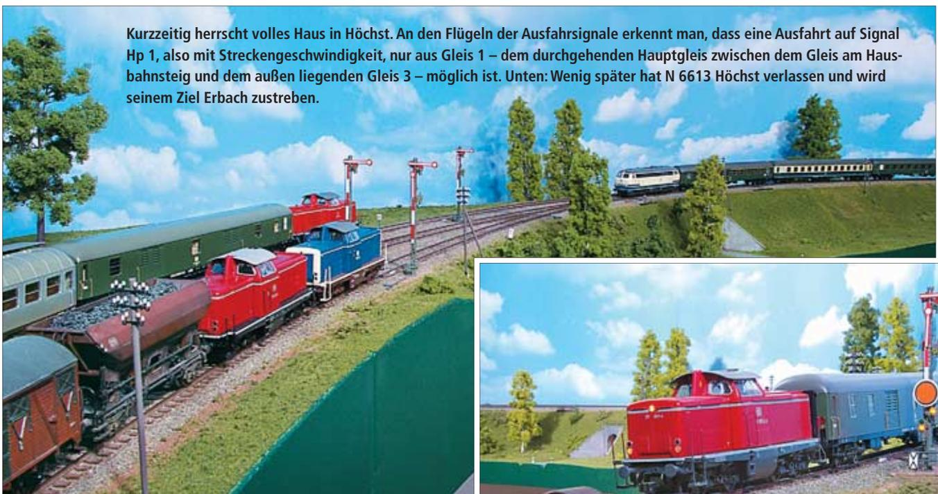
Kurzzeitig herrscht volles Haus in Höchst. An den Flügeln der Ausfahrtsignale erkennt man, dass eine Ausfahrt auf Signal Hp 1, also mit Streckengeschwindigkeit, nur aus Gleis 1 – dem durchgehenden Hauptgleis zwischen dem Gleis am Hausbahnsteig und dem außen liegenden Gleis 3 – möglich ist. Unten: Wenig später hat N 6613 Höchst verlassen und wird seinem Ziel Erbach zustreben.
