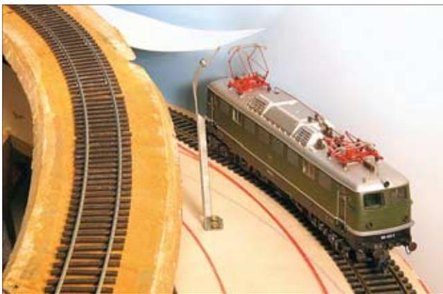
**Oben:** Ohne Bahnstrecken-segmente gut zu sehen: Die Rampe ist steil, aber auch für Züge von sieben bis acht Wagen kein Problem. **Links:** Damit sich die Stromabnehmer nicht verhaken, wurde unter dem ohnehin schon ausgefrästen Trassenbrett noch eine „Gleithilfe“ aus Polystyrol eingebaut.
