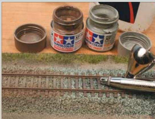
Zum Abschluss werden noch Betriebsspuren mit der Spritzpistole aufgebracht. Dazu eignen sich bestens die matt auftrocknenden Farben von Tamiya, die mit Spiritus verdünnt werden können.
