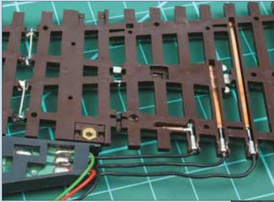
Mittels Kontakten am Doppelpulsenantrieb von Roco lässt sich die Herzstückpolarisierung recht einfach über steckbare Drahtbrücken realisieren. Zudem sind hier die zusätzlich eingelöteten Drahtbrücken von den Backen- zu den Flügelschienen zu sehen.
