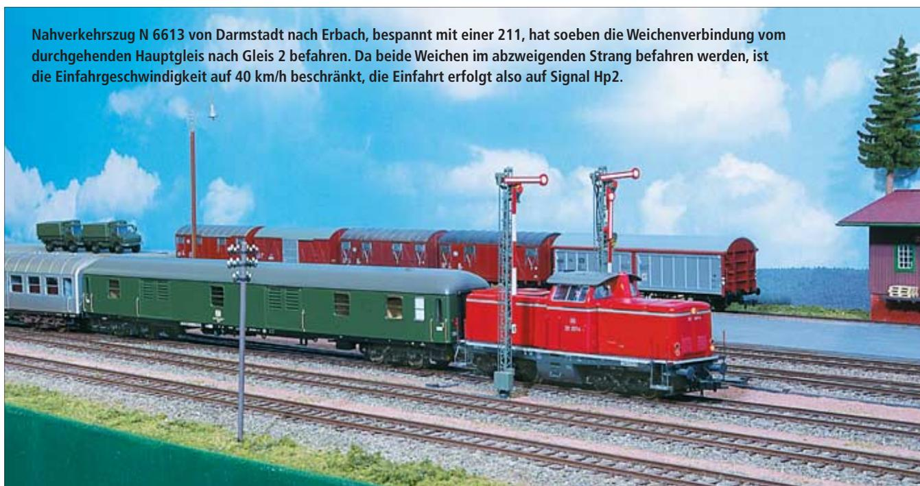
Nahverkehrs zug N 6613 von Darmstadt nach Erbach, bespannt mit einer 211, hat soeben die Weichenverbindung vom durchgehenden Hauptgleis nach Gleis 2 befahren. Da beide Weichen im abzweigenden Strang befahren werden, ist die Einfahrtsgeschwindigkeit auf 40 km/h beschränkt, die Einfahrt erfolgt also auf Signal Hp2.
