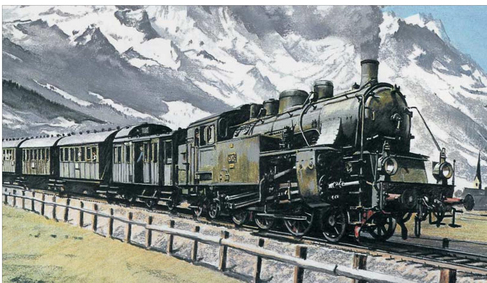
Für Strecken, an deren Endpunkten keine Drehscheiben zur Verfügung standen (was für viele eingleisige Hauptbahnen zutraf), ließen die Länderbahnen große und schnelle Tenderlokomotiven entwickeln. Das Gemälde von A. L. Hammonds zeigt die bayerische Pt 3/6 (DRG-BR 77) auf ihrer „Stammstrecke“ zwischen Garmisch-Partenkirchen und Murnau. *Abbildung: Archiv Eisenbahn-Journal*
