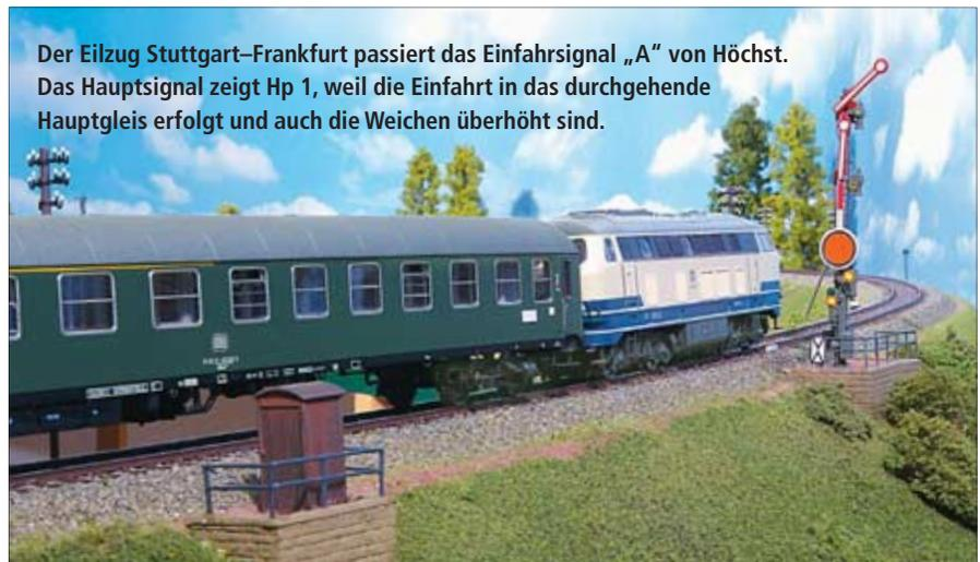
Der Eilzug Stuttgart–Frankfurt passiert das Einfahrsignal „A“ von Höchst. Das Hauptsignal zeigt Hp 1, weil die Einfahrt in das durchgehende Hauptgleis erfolgt und auch die Weichen überhört sind.
