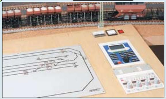
Gleisbildstellpult mit integrierter Selectrix-Zentrale für eine komfortable Bedienung der Anlage
