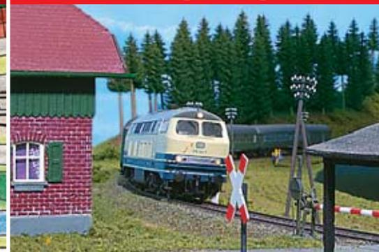
Die V 200 brummt mit ihrem Schnellzug an einer Blockstelle vorbei. Da diese Blockstelle für beide Fahrtrichtungen zuständig ist, stehen ihre Hauptsignale sozusagen Rücken an Rücken. Rolf Knipper komponierte das für eingleisige Hauptbahnen so typische Titelmotiv.
