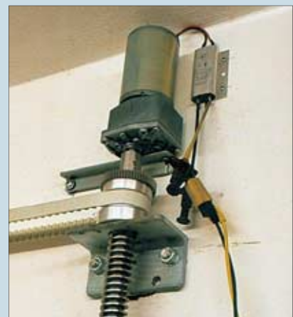
Nahansicht des Spindeltriebs mit abgehängendem Zahnriemen zur zweiten Spindel und Wandbefestigung. (Der Kabelanschluss hier ist nur provisorisch.)
