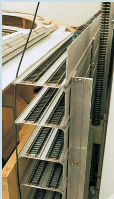
Nahansicht des Spindeltriebs mit abgehängendem Zahnriemen zur zweiten Spindel und Wandbefestigung. (Der Kabelanschluss hier ist nur provisorisch.)
