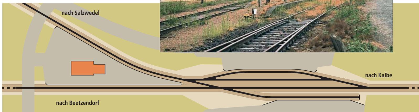
Rangiervorgänge. Für einige Nahgüterzüge war Badel zudem Ziel- bzw. Zugbildungsbahnhof! Um diese für eine Kleinbahn umfangreichen Aufgaben zu erfüllen, hielt man einen Keilbahnhof mit im Streckenwinkel liegendem Empfangsgebäude für die sinnvollste Lösung. Die relativ umfangreichen Gleisanlagen für den Güterverkehr und die Abwicklung von Zugkreuzungen schaltete man dem Keilbahnsteig in östlicher Richtung vor.
