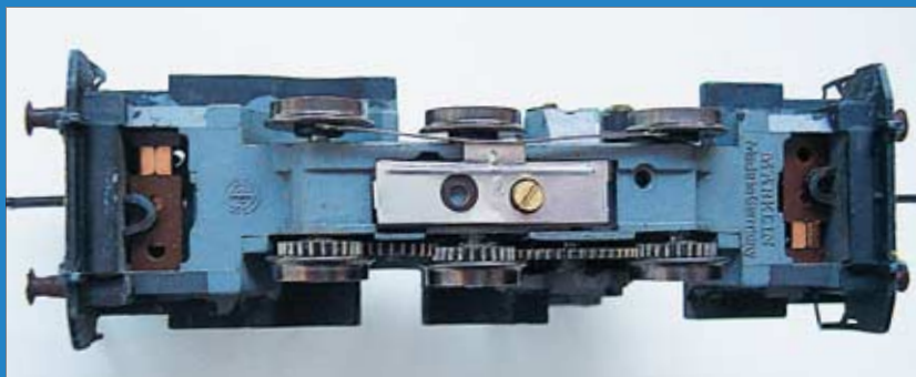
Der ursprüngliche Mittelleiter-Schleifer wird durch einen einseitig leicht zu kürzenden Hamo-Radschleifer ersetzt.
