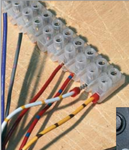
Eine mögliche Gefahrquelle entsteht immer wieder durch den unsachgemäßen Anschluss von Litzen in Lüsterklemmen oder sonstigen Anschlüssen auch von elektrischen Geräten.
