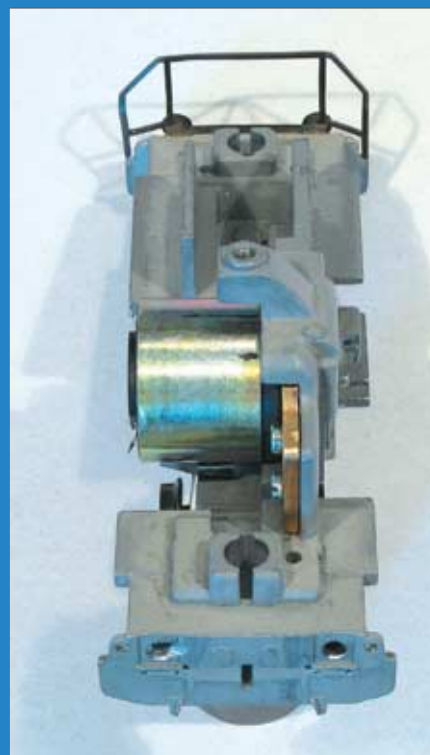
Mit ein wenig mehr Aufwand kann eine funktionsfähige Dreipunktlagerung und Stromabnahme von allen drei Lokachsen realisiert werden. Fotos: Klaus Holler
