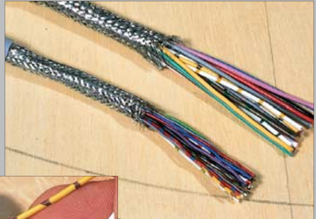
Der Einsatz von Aderendhülsen verhindert „vagabundierende“ Litzenadern. Zudem lassen sich ordentlich verarbeitete Kabel mit Aderendhülsen leichter auch an weniger gut zugänglichen Stellen in Klemmen einführen und sicher verschrauben.
