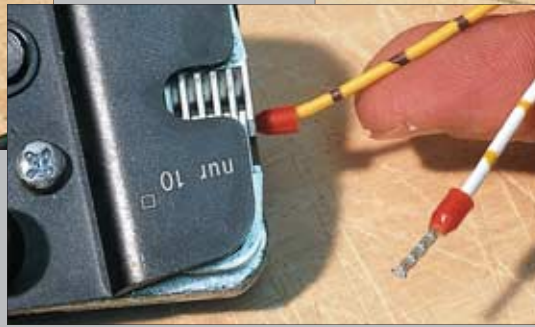
Eine mögliche Gefahrquelle entsteht immer wieder durch den unsachgemäßen Anschluss von Litzen in Lüsterklemmen oder sonstigen Anschlüssen auch von elektrischen Geräten.
