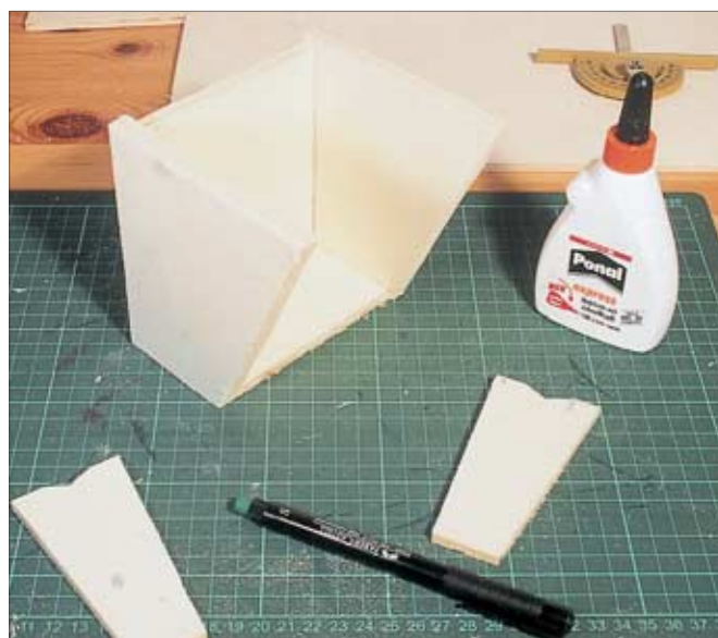
Die ausgesägten und farblich behandelten Teile des Brückenwiderlagers wurden mit „Ponal Express“ zusammengeklebt. Durch die schnelle Abbindung des Klebers ergab sich nach kurzer Zeit ein erster Eindruck von den Größenverhältnissen. An den Trennkanten austretender Leim wurde entfernt und die entsprechende Partie mit der Betonfarbe von Heki nachgebessert.
