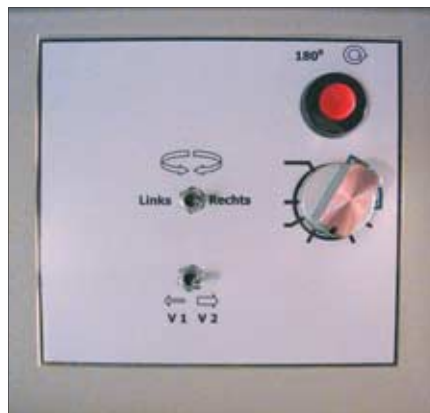
Das neue Gehäuse mit Drucktaster (rot) für die 180°-Drehung, darunter der zwölfpolige Drehschalter zur Ansteuerung von neun Gleisabgängen sowie die beiden Kippschalter für Drehrichtung und Drehgeschwindigkeit.
