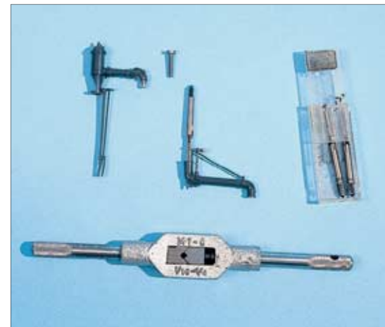
Herstellung eines Gelenks am Wasserkran mit Schraubverbindungen. Damit das überschwappende Wasser in den Gully gelangt, sollte man den Einlauf tiefer legen.
