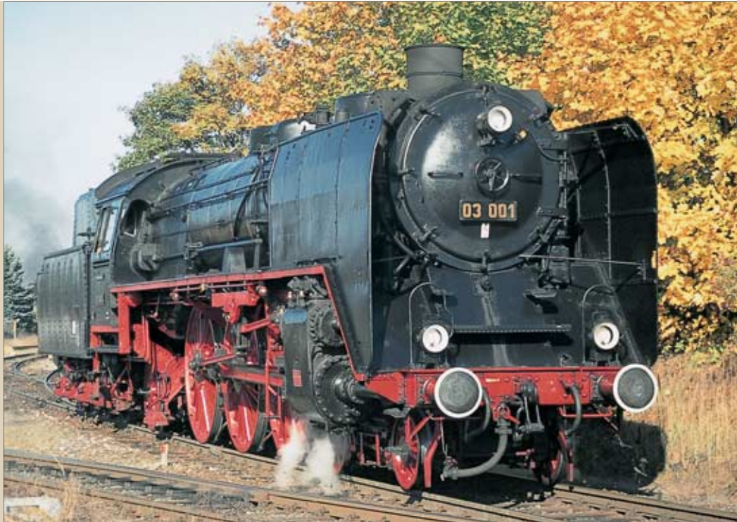
Mit der kurzen Entwicklungszeit der Baureihe 03 (1930), einer „in allen Bauteilen leichter gehaltenen Kopie der 01“, profitierten Bahn und Hersteller von den Vorzügen des Einheitslok-Konzepts. 03 001 im Oktober 1999 in Nürnberg. Foto: Wolfgang Bleiweis
