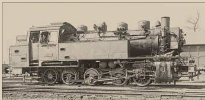
In Gestalt der Baureihe 87 (1927) löste man die speziellen Probleme mit den engen Radien der Hamburger Hafenbahn im Kontext des Einheitslokomotivprogramms. Foto: Carl Bellingrodt/Archiv MIBA
