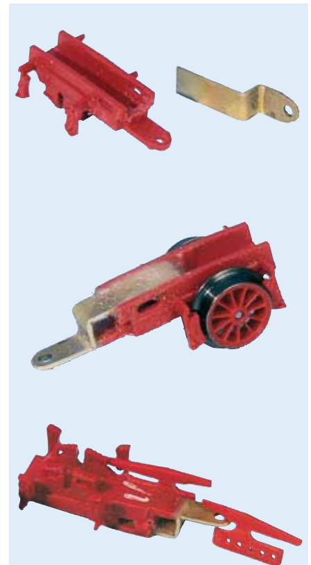
Bilder (3) oben: Zur Vergrößerung des Achsstands des Nachläufers wird die Fleischmann-Deichsel mithilfe eines Messingteils verlängert. Mit der Deichsel der Minitrix-03 wird das verlängerte Teil „verkleidet“.
