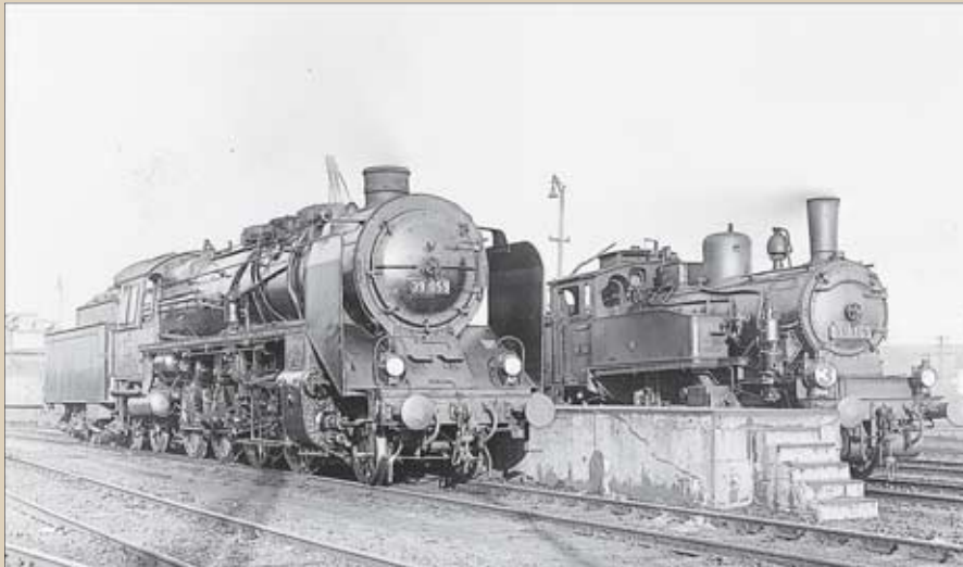
Ein Foto von nahezu symbolischer Aussage: Während 91 1165 noch die typischen Merkmale preußischen Lokomotivbaues zeigt, deutet 39 059 bereits den Übergang zur Einheitslok an.
