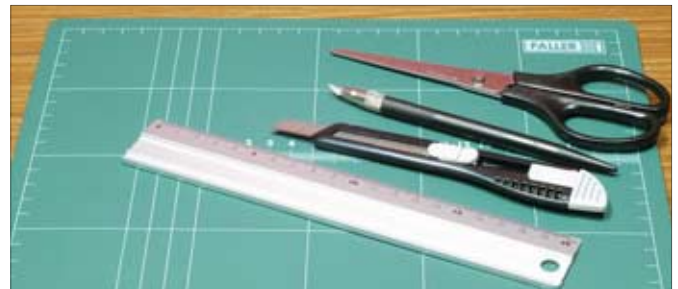
Für den Kartonmodellbau gut geeignet ist das Schneideset, bestehend aus Alu-Lineal, Bastelmesser, Skalpell (mit Ersatzklingen) und Schere von Faller. Nur ein Instrument zum Prägen fehlt noch.
