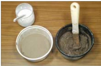
Sand und ein 1:4-Weißleim-Wasser-Gemisch ergeben als sämiger Brei die Spachtelmasse.
