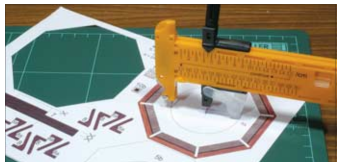
Oben: Fallers Kreisschneider kann auch als Zirkel dienen, wenn man statt der Klinge eine Bleistiftmine einsetzt. Mit ihm schneidet man nicht nur Pappe. Der Maximalradius beträgt stattliche 30 cm. Links: Dem Schreiber-Wasserturm vom Aue-Verlag sieht man nicht an, dass er aus einem Kartonbastelbogen entstanden ist.
