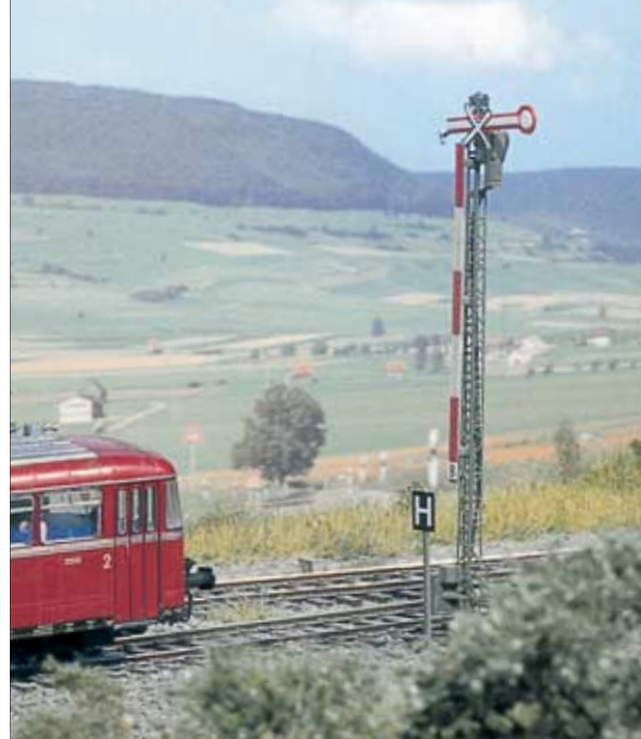
Noch mal zurück zur Modellzene vom Anfang: Die H-Tafel gewährleistet, dass Züge korrekt stehen und alle Weichen grenzzeichenfrei befahrbar sind.
