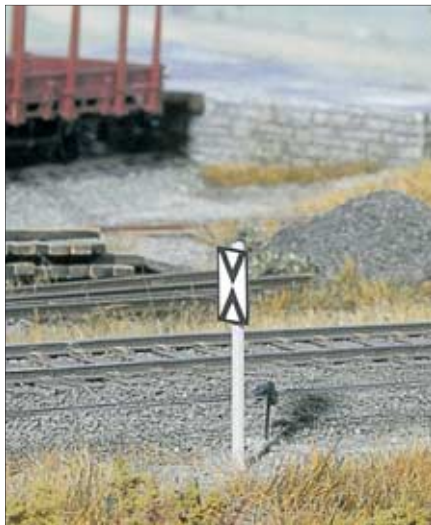
Eine Vorsignaltafel – zu finden vor einer Trapeztafel oder einem Einfahrtsignal und vielleicht auch schon vor einer Deckungsscheibe.
