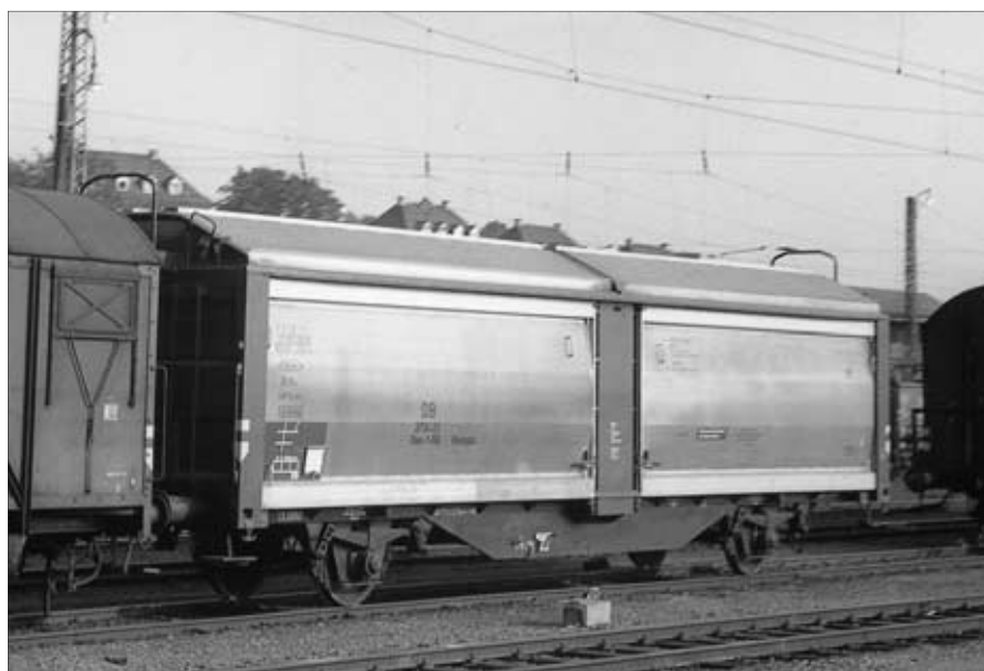
Zum Zeitpunkt der Aufnahme in Weinheim (Bergstr.) – 25.7.1961 – trägt dieser Schiebewand-/Schiebedachwagen der ersten Bauserie von 1960 mit den nach außen gewölbten Schiebetüren noch die Übergangsbeschriftung Tbes-t-66/ Klmmgks.
