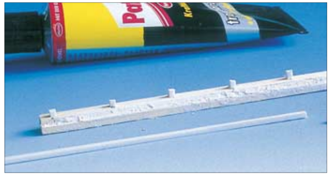
Die Radabweiser in Form von Quadersteinen entstanden als 2 mm lange Zuschnitte aus einer Kunststoffleiste mit dem Querschnitt 2 \times 2 \text{ mm} . Die Zuschnitte wurden im Abstand von 2,3 cm (entspricht 2,0 m Vorbildaufmaß) mittels Pattex auf die obere Leiste geklebt. Danach erfolgte die Farbgebung in einem betongrauen Anstrich.
