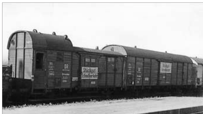
Bei der ersten Bauform des Leig aus dem Jahre 1927 verwendete man neben dem gedeckten Güterwagen GI noch einen Güterzugpackwagen (Pwg) der einstigen preußischen Staatsbahn.
