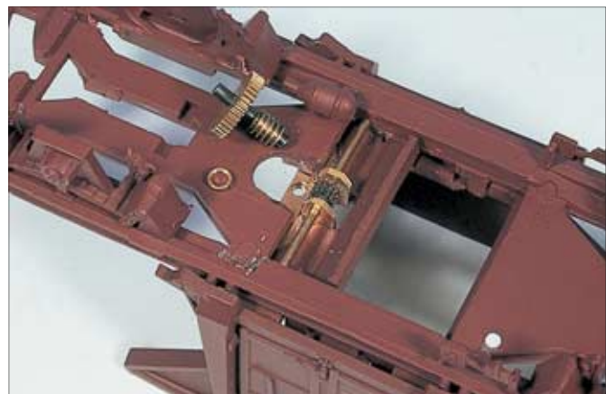
Das Zahnradspiel zwischen zweiter Schnecke und angetriebener Haspelwelle sollte genau überprüft werden. Neben dem Zahnrad der kleine Distanzring, der zusätzlich auf die Welle gefädelt wird.
