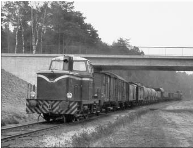
Ein Güterzug unterquert im April 1963 bei Kohlenbissen eine Zufahrtsstraße. Gezogen wird der Zug von einer 400 PS starken und C-gekuppelten Deutz-Lok, die 1959 von der OHE erworben wurde. Fotos (2): Reinhard Todt
