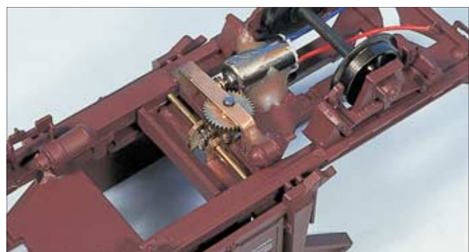
Nach dem Anbringen des unteren Wellenlagers kann ein Probelauf erfolgen, bevor die Komponenten mit Stabilit Express endgültig fixiert werden.
