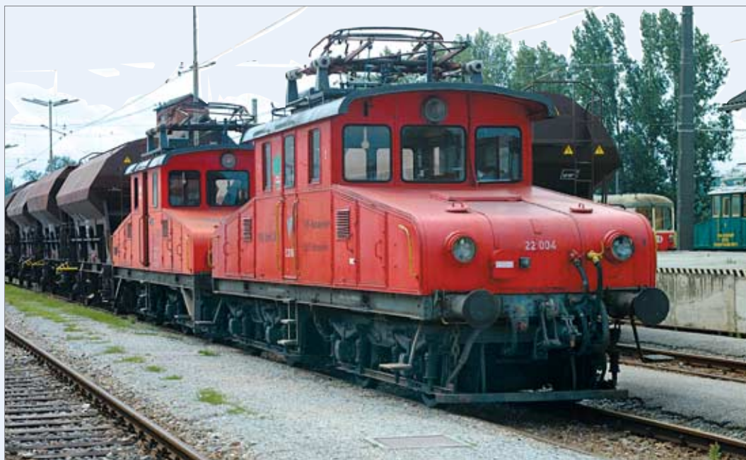
Abgebügelt, aber nicht abgetakelt sind diese beiden alten „Fregatten“ im Bahnhof Eferding. 22.004 (Baujahr 1916) und 22.005 (Baujahr 1915) haben beide Tandemsteuerung und können so in Doppeltraktion fahren. Beide gehören der Linzer Lokalbahn LILO. Aufgenommen sind sie im August 2002. Auch im Jahr 2004 haben sie noch fleißig gearbeitet.
