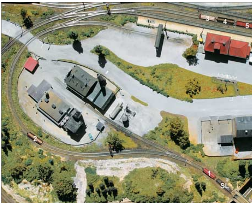
Wagen 2 wird auf dem Zubringergleis festgebremst zurückgelassen und Wagen 1 kann nun über das Ausziehgleis in den Gleisanschluss des Firmengeländes gedrückt werden.
