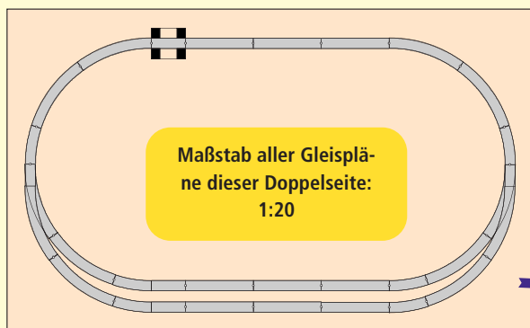
Typisches Gleisoval einer Startpackung von Fleischmann mit Ausweichgleis als Bahnhof. Platzbedarf: 155 x 100 cm
