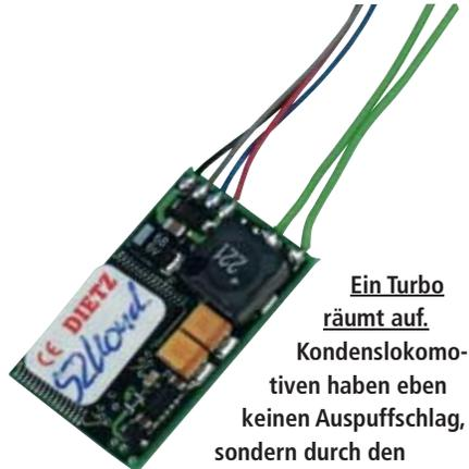
**Ein Turbo räumt auf.** Kondenslokomotiven haben eben keinen Auspuffschlag, sondern durch den Absaugturbo ihren eigenen, heulenden Klang. Dietz bietet auf der Basis einer Digital-Aufnahme einen speziellen Sound-Baustein mit Susi-Schnittstelle an.
