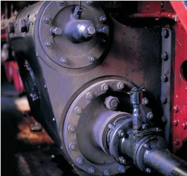
**Oben:** Vor dem rechten vorderen Zylinderdeckel der Schmalspurlokok 99 2323 (Strecke Bad Doberan–Kühlungsborn) erkennt man die Kolbenstangentrabuchse mit dem einfach gehaltenen Schmiergefäß.
