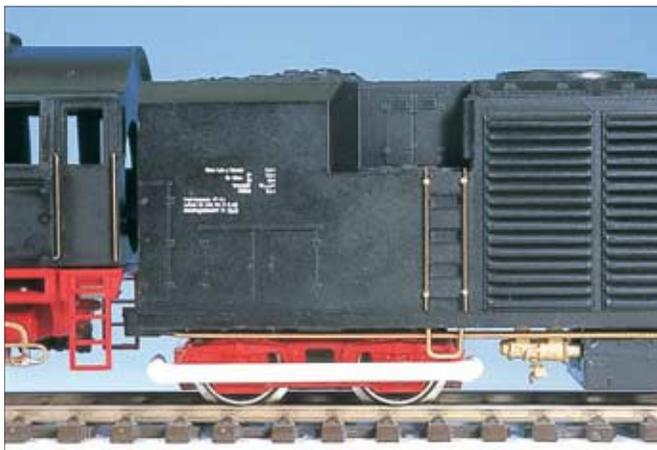
**Am Tender sind nur wenige Teile zu ergänzen: Die um das vordere Drehgestell herumgelegte Rückführungsleitung, eine weitere Leitung unterhalb des Tendaraufbaus und Griffstangen. Nach dem Wegfall der alten Motorverkleidung kann hier ein neues Bremsventil eingesetzt werden.**
