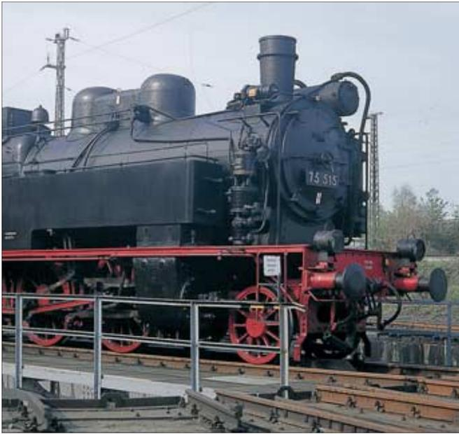
Bei den Loks aus Länderbahnzeiten konnten die Oberflächenvorwärmer auf dem Kessel (75.5), verkleidet vor der Rauchkammer (75.4 bzw. 75.10-11) oder auf dem Umlaufblech (38.10-40) sitzen.
