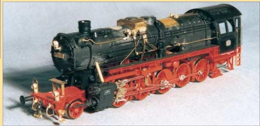
Die geraden Zylindereinströmröhre habe ich aus einem ca. 14 mm langen, 2 mm starken Messingrohr gebastelt. Sie wurden an beiden Enden im entsprechenden Winkel zugefeilt und in passend gebohrte Löcher im Kessel eingeklebt. Alle Leitungen, Handläufe und sonstige Kesselausrüstung, die vom Roco-Modell unverändert übernommen werden konnten, wurden nun wieder angebaut.
