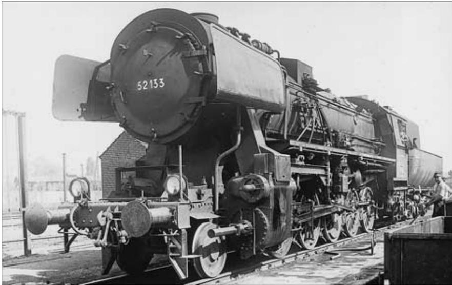
Der auf die Rauchkammer gesetzte Mischbehälter an den Henschel-52ern aus Nachkriegsproduktion beeinflusste das Erscheinungsbild wenig vorteilhaft. Im Unterschied zu den anderen Loks hat 52 133 eine Kolbenspeisepumpe des Typs KT 1. Foto: Bellingrodt/MIBA-Archiv
