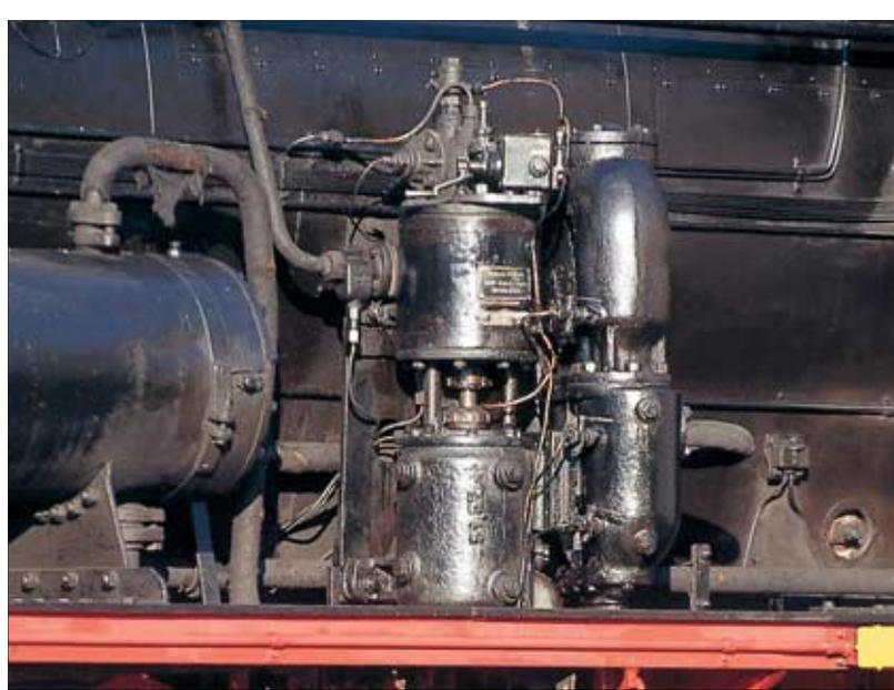
Speisewasserkolbenpumpe der 38 1182: Diese „klassische“ Knorr-Pumpe sitzt unmittelbar neben dem Oberflächenvorwärmer (links).
