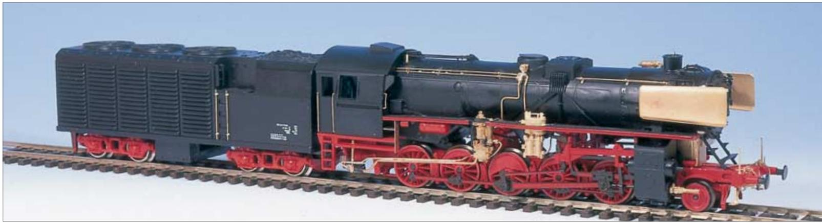
gemacht werden, ist die Handhabung während des Baus etwas diffizil. Die großen, metallenen Rastnasen am hinteren Rahmenende wurden daher entfernt und durch eine Schraubkonstruktion ersetzt. Dazu wird die hintere Bodenplattenschraube gegen ein längeres Exemplar getauscht. Die Schraube findet Halt in einer in den Aschkasten geklebten Mutter. (Diese Maßnahme hat sich übrigens auch bei der 52 138 bewährt.)
