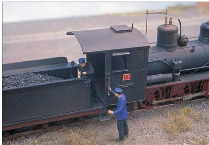
Auf eine Grundierung konnte ich übrigens verzichten, da die Tamiya-Farbe hervorragend deckt und auch haftet. Für die Pinsellackierung des Fahrwerks verwendete ich Acrylfarbe aus dem Hause Weinert. Die Alterung der Lok geschah anschließend mit diversen Pigmentfarben von Artitec. Dabei konnte auf eine besondere Fixierung verzichtet werden, da auf dem reaktiv matten Lack die Pigmente bestens hafteten. Die Laternen (Dreilicht-Spitzen-signal) stammen von Addie (Mainz) und bestehen aus Kunststoff.
