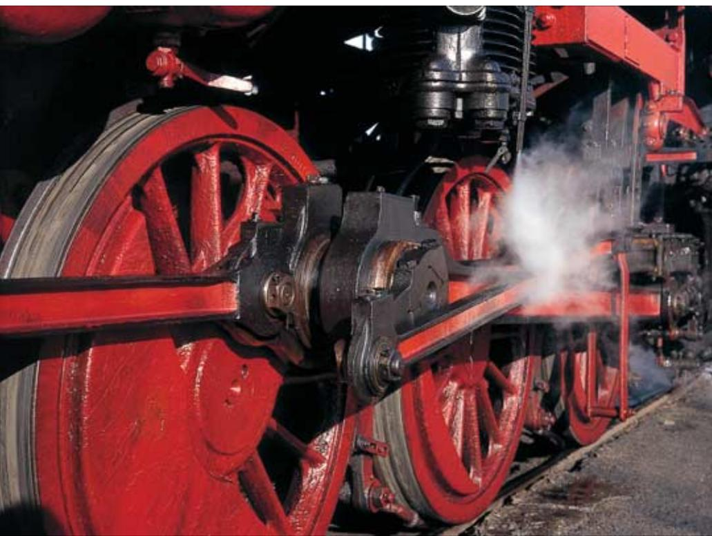
Triebwerk der Lokomotive 50 3708, Foto von der Lokführerseite: Direkt über den Radsternen sitzt die Kuppelstange, es folgen die hochstabile, wuchtige Treibstange und an der Gegenkurbel die Schwingenstange. Der Treibzapfen ist nur zu erahnen. Foto: Leikra
