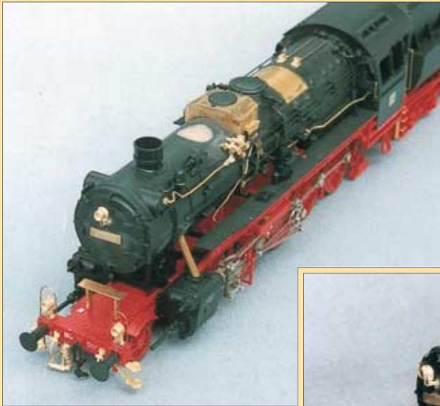
**Gut zu erkennen: Der ursprüngliche Speisedom und die beiden Sandkästen sind entfernt und die Löcher im Kessel verschlossen. Die neu montierten Teile am Kessel und auf der vorderen Pufferbohle sind der Deutlichkeit halber noch nicht lackiert.**
