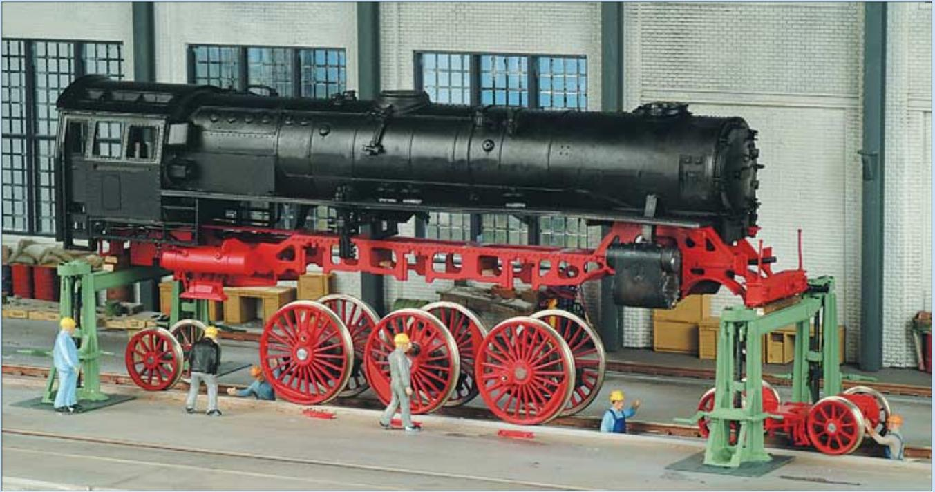
Das Einachsen der Lok ist ein besonderer Moment. Zuvor wurden die Radsätze in der richtigen Reihenfolge an den Hebestand gerollt. Die Federpakete sind zu diesem Zeitpunkt schon an den Achslagern befestigt. An jedem Radsatz achten die Arbeiter darauf, dass die Achslager beim Absenken der Lok ohne jegliches Verkanten in die Achslagerausschnitte des Rahmens gleiten. Die Achsgabelstege zum Verschließen der Ausschnitte liegen schon bereit.
