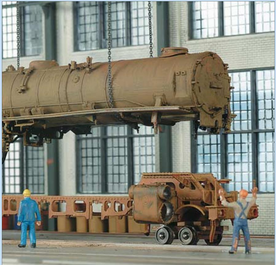
Um den Rahmen exakt vermessen zu können, wird der gereinigte Kessel noch einmal auf den Rahmen gesetzt. Nur so ist unter Last das korrekte Stichmaß des Rahmens zu ermitteln, das für die Anfertigung der Stangen benötigt wird. Aus den Zylinderblöcken sind Kolben und Schieber bereits entfernt.
