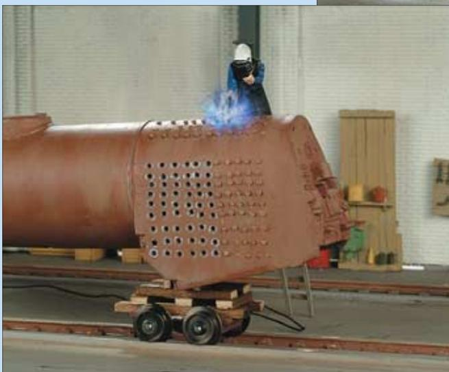
Entsprechend der ermittelten Längen werden die Stehbolzen einzeln gedreht und gebohrt. Danach erfolgt das Einschweißen.
