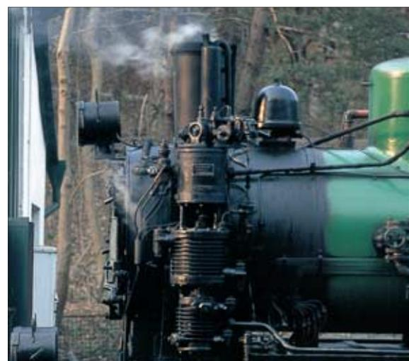
Dampflok. Entwicklungsgeschichtlich erwiesen sie sich schon früh als notwendig, da die Zugkraft des Triebfahrzeugs auch von der Haftreibung zwischen Rad und Schiene abhängt und bei schlüpfrigen Schienen mit dem „Sanden“ der Adhäsion kräftig nachgeholfen werden muss. Die Sandkästen können der Form der Dome weitge-
