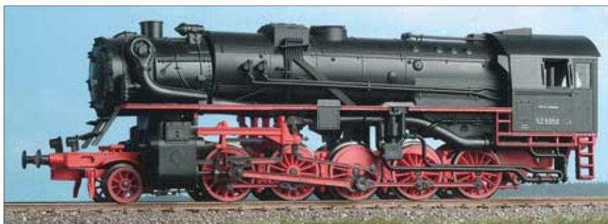
Das Prinzip der Spende: Da nur lose zusammengelegt, klafft zwischen alter Rauchkammer und neuem Langkessel noch ein deutlicher Spalt. Während des Baus wurden zusätzlich noch der alte Führerhausboden und die neuen Zylinder gegen die jeweilig anderen Teile ausgetauscht.
