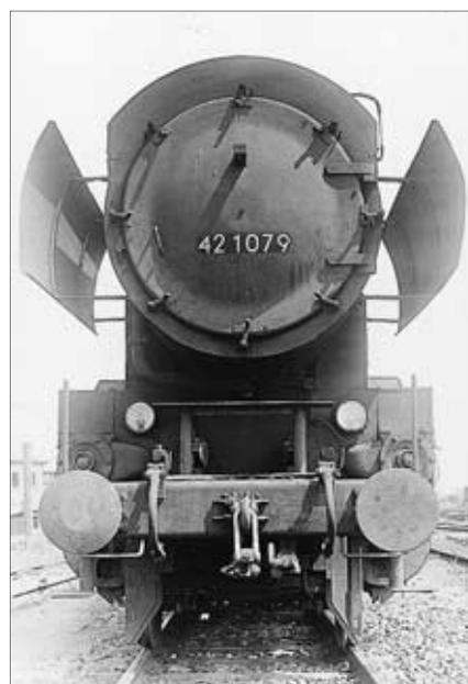
An den Fronten lässt sich gut die unterschiedliche Form der Mischvorwärmer-Anlagen von Knorr (an 42 591) und Henschel (an 42 1079) erkennen.
