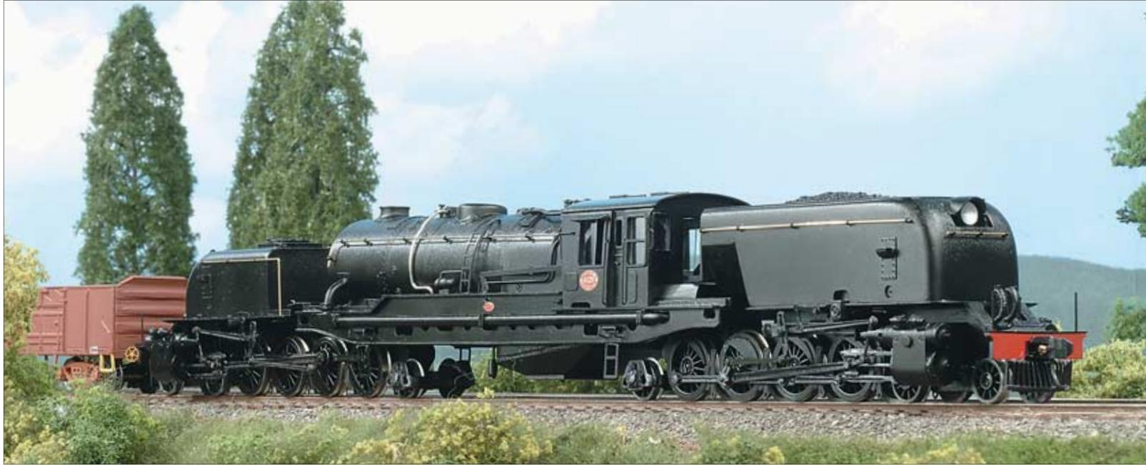
Garratts fahren üblicherweise mit dem Kohlenbunker voraus um die Belästigung des Personals durch Qualm zu reduzieren. Den zur Lok gehörende Wasserwagen hat Precisionminiatures angekündigt. Die Lok zeigt sich im schlichten Schwarz mit wenigen blanken Rohrleitungen und Griffstangen wie sie im regulären Betriebsdienst anzutreffen war. Die heutigen Museumsmaschinen zeigen sich deutlich freundlicher.
