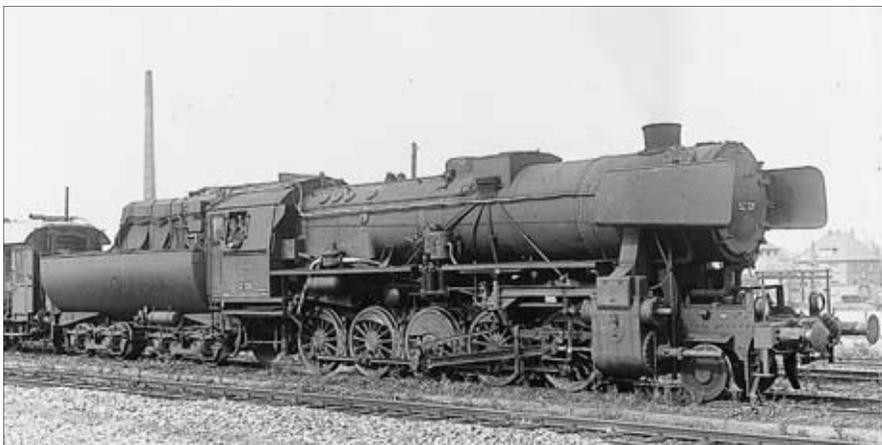
Zu Vergleichszwecken hatte 52 128, die im August 1948 in Dienst gestellt wurde, einen Oberflächenvorwärmer erhalten. Das Bild zeigt sie bei Messfahrten, auf deren Basis die Ergebnisse der Mischvorwärmerloks eingeordnet werden konnten. Foto: Bellingrodt/MIBA-Archiv
