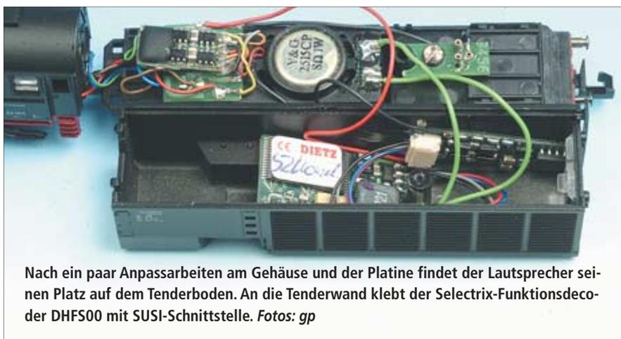
Nach ein paar Anpassarbeiten am Gehäuse und der Platine findet der Lautsprecher seinen Platz auf dem Tenderboden. An die Tenderwand klebt der Selectrix-Funktionsdecoder DHFS00 mit SUSI-Schnittstelle. Fotos: gp
