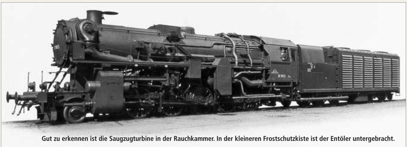
Gut zu erkennen ist die Saugzugturbine in der Rauchkammer. In der kleineren Frostschutzkiste ist der Entöler untergebracht.
