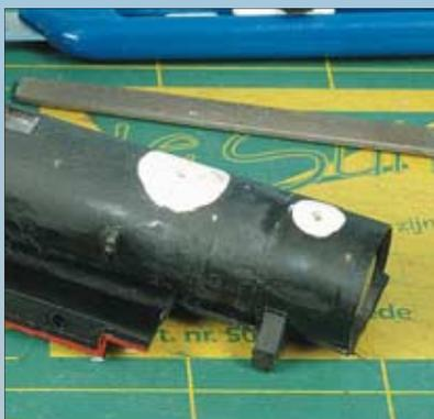
Die für die BR 92.5 typische Stufe zwischen Rauchkammertür und Pufferbohle wurde aus zwei 4 x 4 mm messenden Winkelprofilen zusammengelötet. Ein auf der Rückseite angelöteter Draht wird in eine Bohrung auf der Unterseite der Rauchkammer eingesetzt und sorgt später für mehr Stabilität beim Ankleben.
