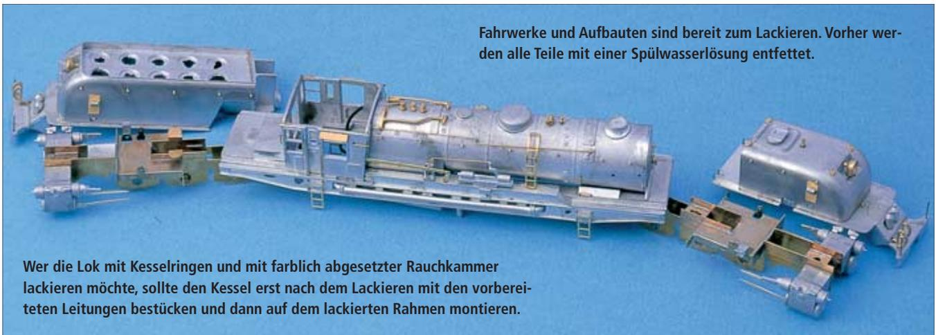
Fahrwerke und Aufbauten sind bereit zum Lackieren. Vorher werden alle Teile mit einer Spülwasserlösung entfettet.
