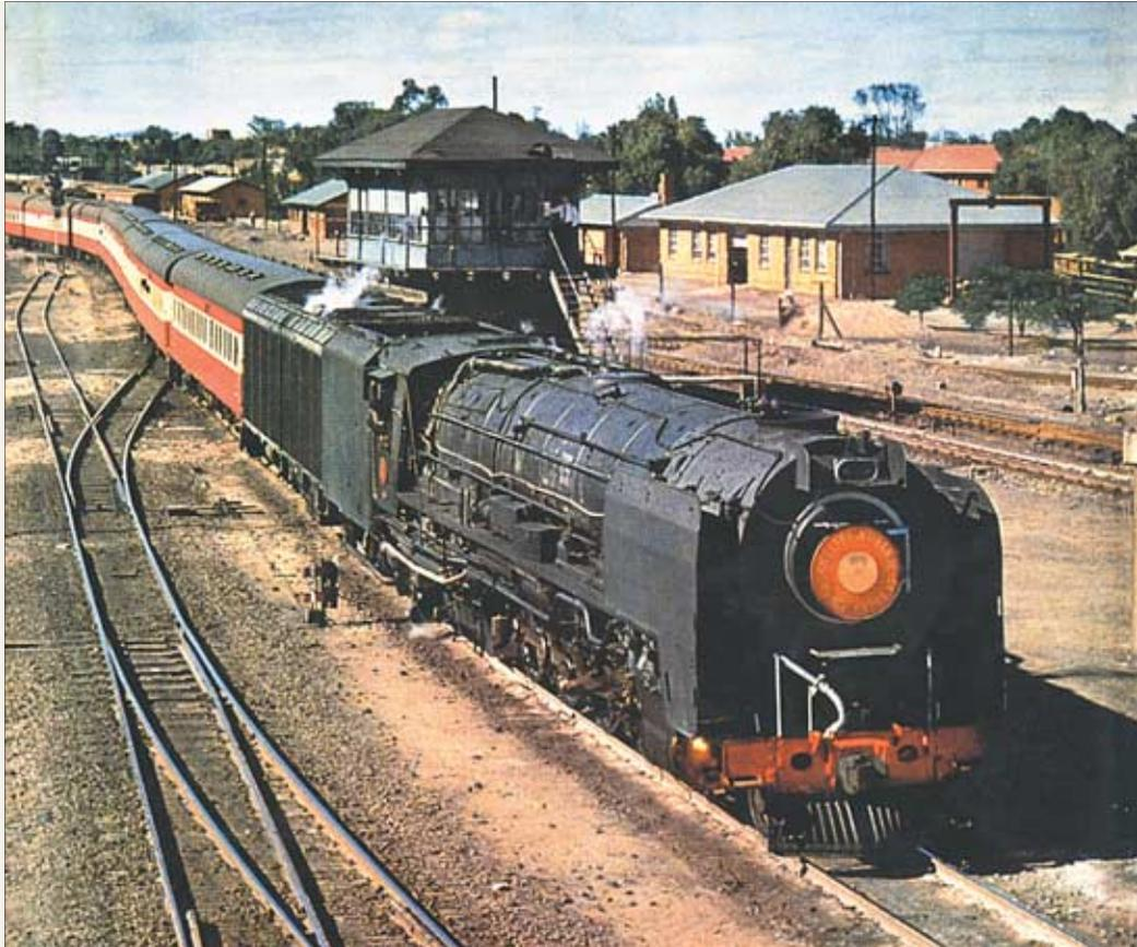
Der sechssachsige Tender der kapspurigen Kondenslok der Klasse 25 der South African Railway ist länger als die Lok selbst. Die Kondenser standen bis etwa 1978 im Dienst.
