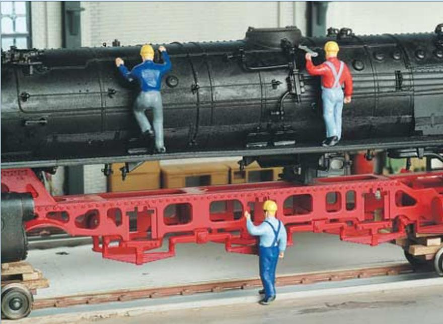
Nachdem Kessel und Rahmen aufgearbeitet sind, kann der Kessel wieder an seinen angestammten Platz. Damit der Kranführer auf den Zentimeter genau arbeiten kann, passen die Arbeiter an allen neuralgischen Punkten auf.
