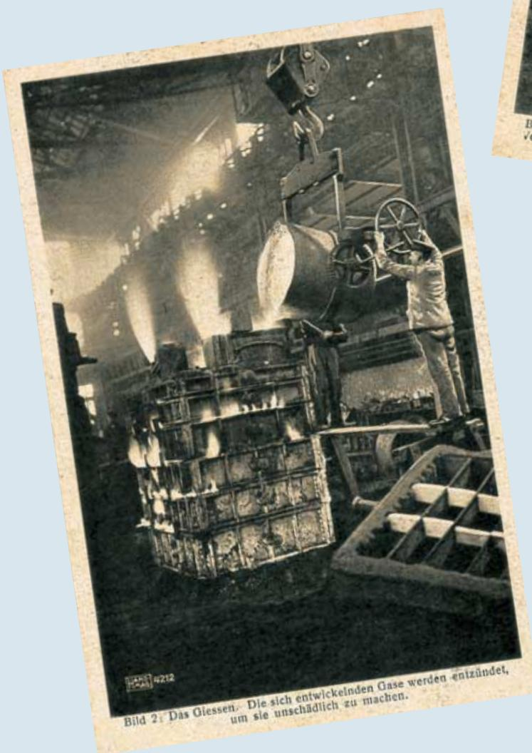
Bild 2: Das Giessen. Die sich entwickelnden Gase werden entzündet, um sie unschädlich zu machen.
