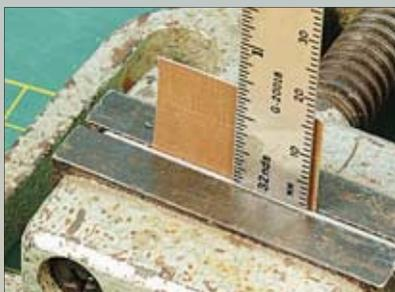
Das Riffelblech für die Stufe wird in einem Schraubstock sorgfältig zusammen mit einem Stahldraht (hier mit einem Durchmesser von 1 mm, 1,5-2 mm wären sicher besser gewesen) rechtwinklig ausgerichtet und umgebogen.
