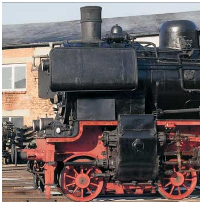
Ansicht der 38 1182 von der Heizerseite. Der Zylinderblock als eigentliches „Herz der Dampflok“ vereint Zylinder und Schieberkasten unter einer gemeinsamen Verkleidung. Am tiefsten Punkt des Zylinders sind die per Nockenstange und Hebelzug bedienbaren Zylinderentwässerungsventile erkennbar. Die Lok zeigt sich mit Schornsteinaufsatz und mit an den Rändern gebördelten Windleitblechen.
