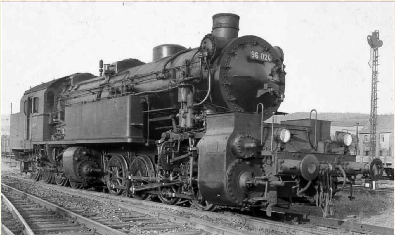
„Die“ Mallet schlechthin und charakteristisch für die teilgelenkige Konstruktion ist die Baureihe 96. Foto: Carl Bellingrodt, Slg. MIBA
