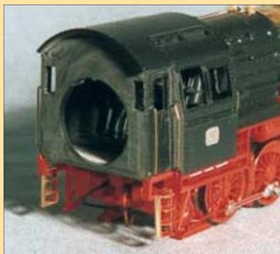
fernt werden. Der Speisedom wurde abgesägt, das dadurch entstandene Loch mit einem Klebestreifen hinterlegt und mit Stabilit-Express aufgefüllt. Nach dem Abbinden des Klebers wurde das Ganze in Form gefeilt und verschliffen. Bei dieser Aktion wurden auch die beiden Waschlukendeckel unterhalb des Speisedoms entfernt.
