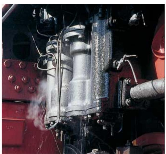
Speisewasserkolbenpumpen gab es in zahlreichen Ausführungen. Die VMP 15-20 wurde für DR-Mischvorwärmer entwickelt. Fotos: Leikra
