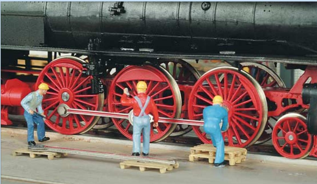
Zum Anbauen der Kuppelstangen wird die Lok mit Wagenhebern noch einmal angehoben, sodass die Räder entlastet sind und die Kurbelzapfen in eine synchrone Stellung gehiebt werden können. Die blanken Radreifen und Steuerungsteile glänzen trotz der schummrigen Hallenbeleuchtung besonders heraus.
