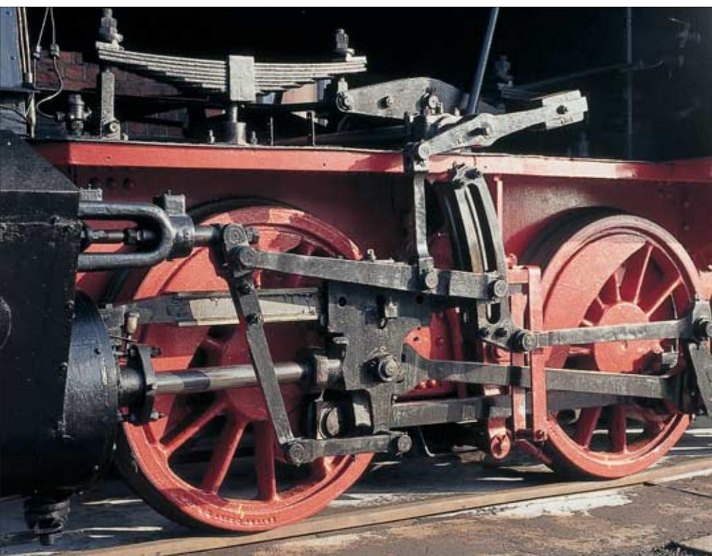
ihm entweder verschraubt oder angegossen der Schieberkasten mit zwei Anschlussstutzen zu den Zylindern. Im Schieberkasten läuft ein flacher oder auch kolbenartiger Schieber hin und her. Je nach Einstellung gibt er den Weg für den frischen Dampf aus dem Kessel in den vorderen oder hinteren Zylinderraum, also in den Raum vor oder hinter dem Kolben, frei.
