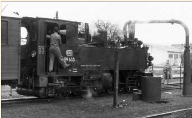
Mallet-Lokomotiven standen zumindest auf Schmalspurbahnen noch bei der DB im Einsatz. Die 99 633, bekannt durch Eisenbahnromantik, fasst 1964 in Buchau Wasser.
