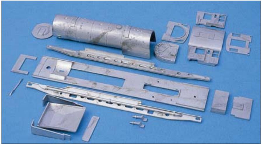
In der Bauanleitung wird empfohlen, die Weißmetallteile mit einem speziellen Lötzinn und einem Lötkolben bei 170° zu verlöten. Man kann sie aber auch mit Sekundenkleber heften und danach mit Stabilit Express endgültig verkleben.
