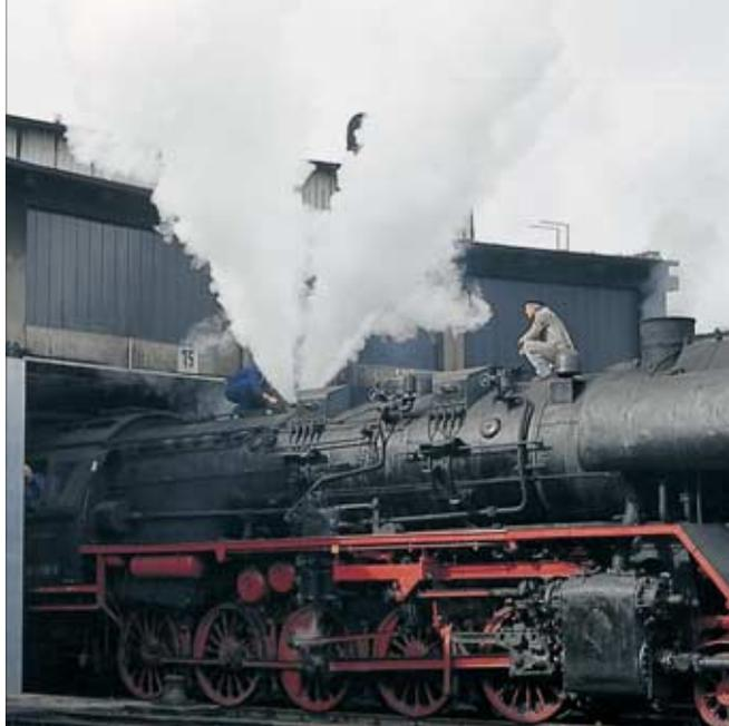
**Oben links:** Die Kesselsicherheitsventile der Bauart Ackermann konnten sowohl auf dem Kessel als auch (wie hier bei einer Tenderlok der Baureihe 64) am Dom sitzen. *Foto: Harald Ott*
