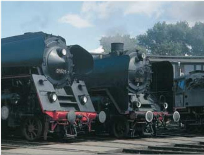
35 Einheitsloks der Baureihe 01.0-2 erhielten von 1962 bis 1965 im damaligen Raw Meiningen eine Rekonstruktion, die ihr Äußeres stark veränderte, wozu vor allem die hohen, steilen Schürzen, die spitzkegelige Rauchkammertür und die Witte-Windleitbleche beitrugen.
