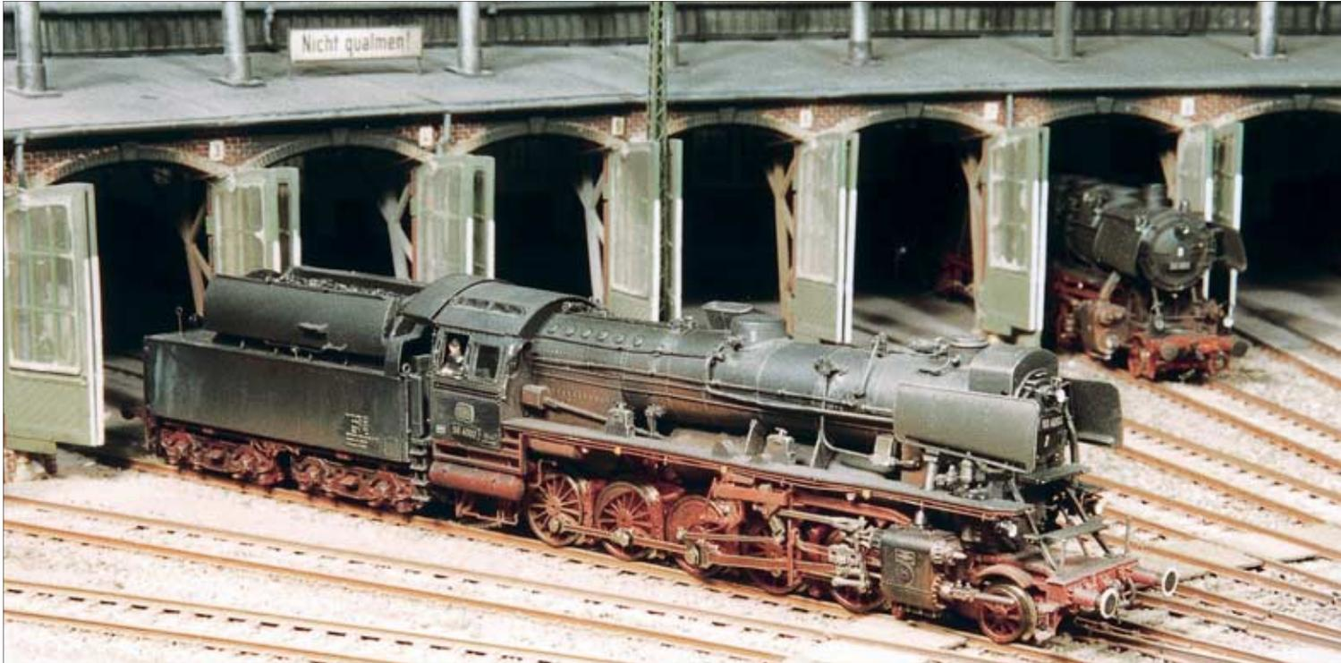
wand habe ich abgefeilt und in die Öffnungen Weinert-Lampen eingeklebt. Bei dieser Gelegenheit wurde auch das dritte Spitzenlicht angebaut und mit Spulendraht als Stromzuleitung versehen. An der Pufferbohle kamen Federpuffer zum Einsatz. Inzwischen war auch der Rangierertritt an der Pufferbohle des Tenders abgebrochen. Auch hier habe ich ein entsprechendes Weinert-Teil als Ersatz angebaut.
