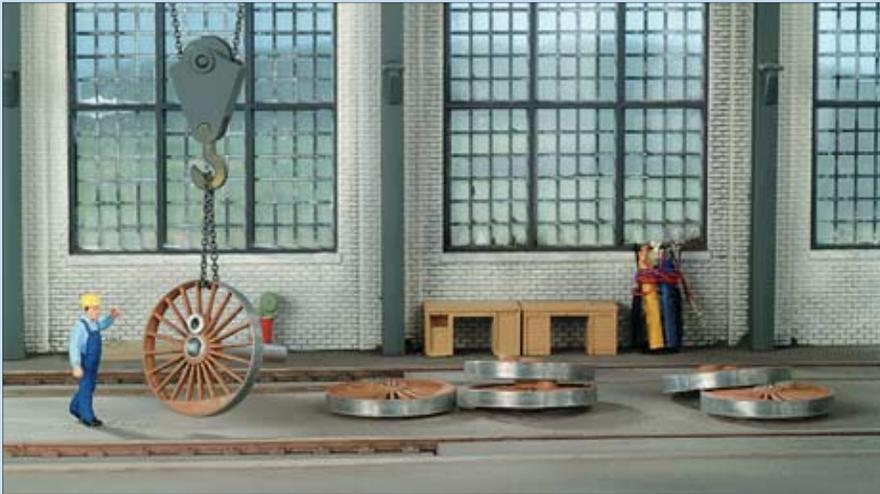
In der Radsatzwerkstatt werden parallel die Räder bearbeitet. Da die Radreifen nicht mehr das erforderliche Mindestmaß hatten, mussten sie von der Felge abgenommen werden. An den Radsternen wurden einige Risse in den Speichen geschweißt und die Felgenoberfläche auf Maß gedreht.
