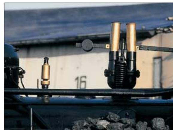
**Hosenrohr, Druckfeder und Messingglanz** sind Kennzeichen des Ramsbottom-Sicherheitsventils. Links die Pfeife der 89 6311.
