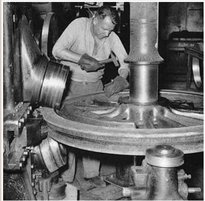
Oben: „Einwalzen eines Sprenglings in das Kuppelrad einer Dampflokotive“
