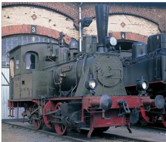
Die Frontalansicht der Rauchkammertür von 55 669 verdeutlicht, wie stark die Einflüsse des preußischen Lokomotivbaues waren: Die im Jahre 1906 als G 7.1 von Henschel gebaute Nassdampflok verfügte bereits (wie später die Einheitsloks der DRG) über eine leicht gewölbte Rauchkammertür mit Zentralverschluss, dem Handrad und den Vorreifern.
