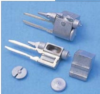
Die doppelte Kreuzkopfschiene wird durch das Zusammenkleben der Zylinderhälften fixiert. Mangelnde Passgenauigkeit erfordert Feilarbeit an der Kreuzkopfschiene wie auch an den Zylinderhälften.
