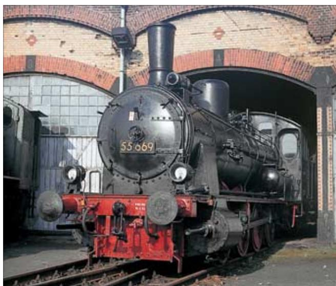
Die preußische P 8 und spätere Baureihe 38.10-40 setzte Maßstäbe. Die Vorderansicht ihres Kessels zeigt fast alle Merkmale der späteren Einheitslokomotive. Weniger typisch waren allerdings die hoch angesetzten, kleinen Windleitbleche der Bauart Witte, die man der bewährten Lokomotive erst nach 1945 verpasste. Fotos: Leikra
