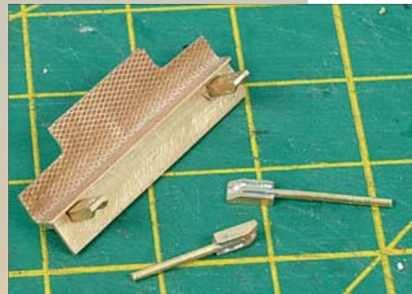
Die aufwändigste Arbeit ist sicher das Anpassen des neuen Umlaufblechs. Als Maß für den genauen Umriss diente das abgesägte alte Teil, auf der Lokführerseite muss zusätzlich der Ausschnitt für die Luftpumpe ausgefeilt werden. Als „Grundplatte“ dient 0,7 mm starkes Polystyrol, das sich mit Kunststoffkleber mit dem Lokgehäuse verkleben lässt; sie muss vorne bündig mit dem Gehäuse abschließen. Das Riffelblech aus fein geätztem, 0,3 mm starkem Messingblech stammt von Weinert.
