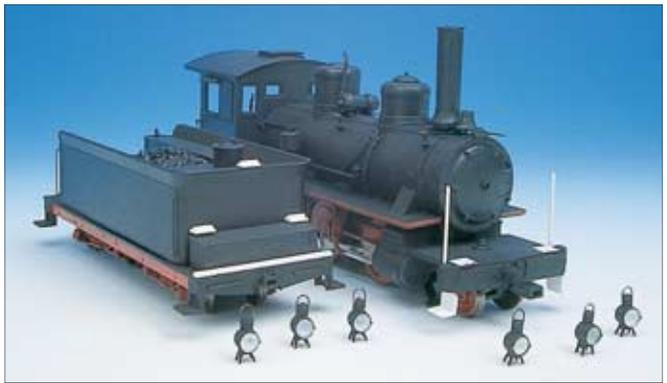
Die neuen Loklaternen liefert Addie. Probeweise wurden die asymmetrischen Vollspur-Pufferbohlen montiert und mithilfe eines OSM-Güterwagens (auf einem provisorischen Dreischiengleis) justiert.
