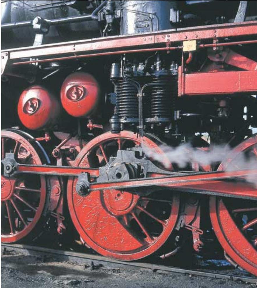
**Luftpumpe auf der Lokführerseite der 50 3708: Da der erzeugte Luftdruck zum Bremsen der Lokomotive und des Zuges benötigt wird, zählt die Luftpumpe zu den sicherheitsrelevanten Bauteilen der Lok und ihre Bedienung zu den unmittelbaren Aufgaben des Lokführers. Bei der Baureihe 50 ordneten DB und DR die Pumpen vorzugsweise in der Mitte des Umlaufs an.**
