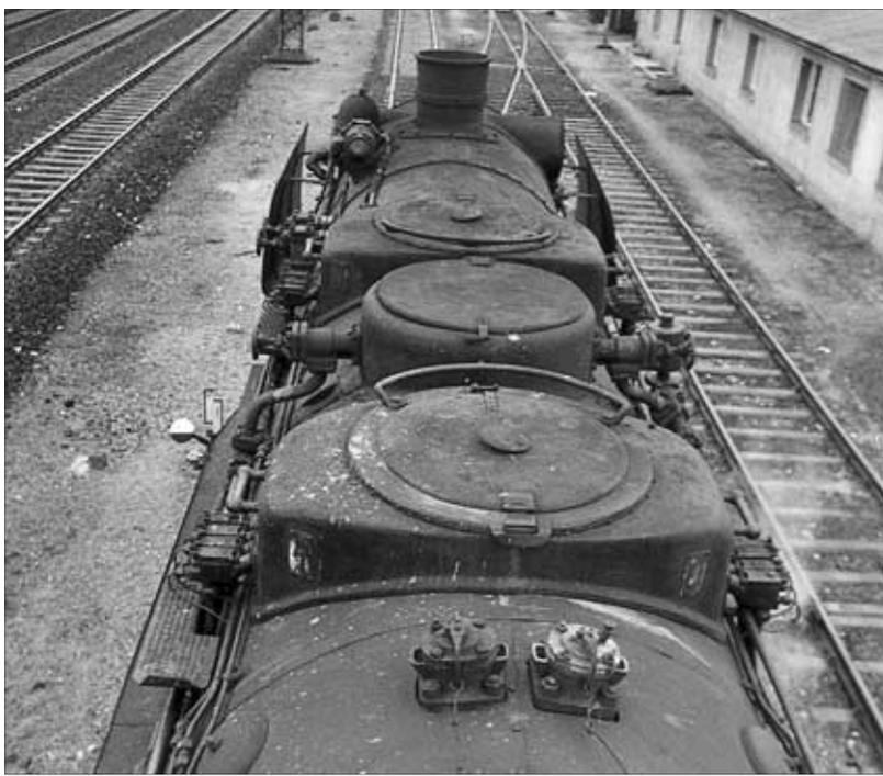
**Links:** Dieser Dampfentnahmestutzen an einem DB-Neubaukessel sitzt auf der linken Seite des Langkessels unmittelbar hinter dem Windleitblech. Wie an der Dampfleitung zum Turbogenerator ersichtlich, dient der Stutzen zur Dampfversorgung der Hilfseinrichtungen des Kessels.
