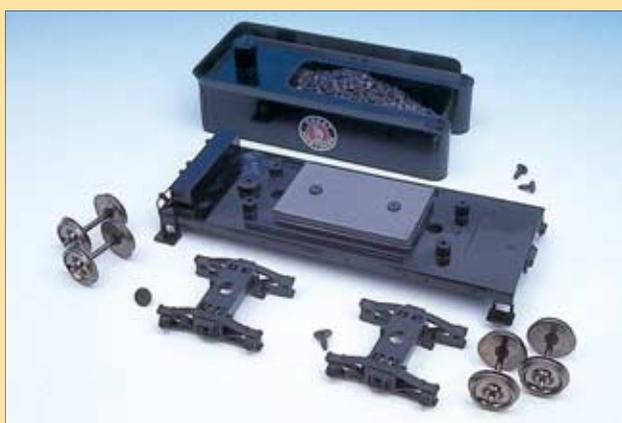
Die Baugruppen der Lok. Der Antrieb bleibt unverändert. Links die Teile des zerlegten Tenders. Im Bild unten wird der Fußboden des Führerhauses abgetrennt. Nur die Rastnase unterhalb der Feuerbüchse bleibt zur Justierung des Kessels auf dem Fahrwerk erhalten.
