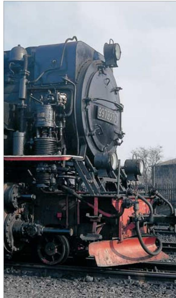
**An Tenderlokomotiven sind die Luftpumpen aus Platzgründen vor dem Wasserkasten montiert, wie hier an der Harzer Neubauschmalspurlok 99 7223. Fotos: Leikra**
