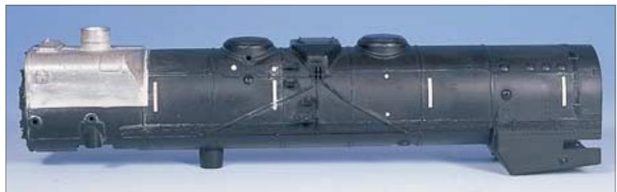
Oben: An beiden Kesselseiten müssen nach dem Entfernen der Ansteckteile so gut wie alle Öffnungen verspachtelt werden.
