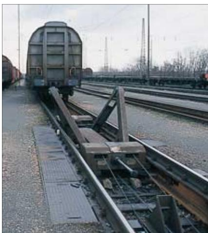
In der Einfahrgruppe eingetroffen, werden die Wagen von dieser speziellen Prellbockbauart VVP 500 gesichert.
