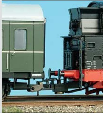
Der Decoder versorgt die Kupplung mit Strom – die Entkopplungsplatte hebt sich.
