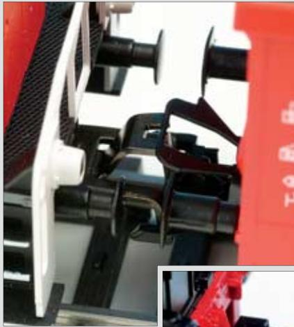
Links: Die alte Telexkupplung hebt mit einer elektrisch betätigten Zunge den Kupplungsbügel über den Kuppelhaken der Lok.
