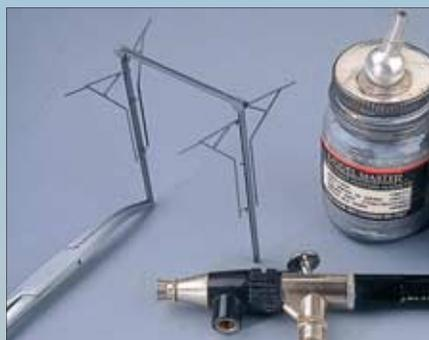
Links: Die Nachbildungen der Knotenbleche aus 0,3 mm starkem Polystyrol werden nach dem Grundieren mit Sekundenkleber festgeklebt.
