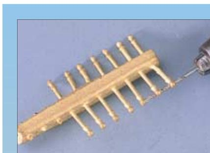
Vor der Montage werden die Griffstangenhalter am besten mit einem 0,4 mm großen Spiralbohrer nachgebohrt und auf einen dünnen Messingdraht gefädelt.
