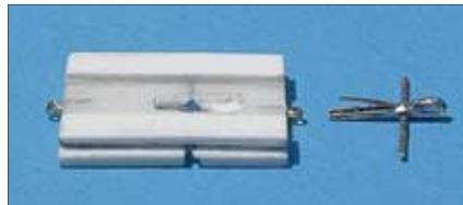
Die Gleitschienen des Transportschlittens von unten gesehen. Daneben der Mitnehmer nebst Achse und Stützfeder.
