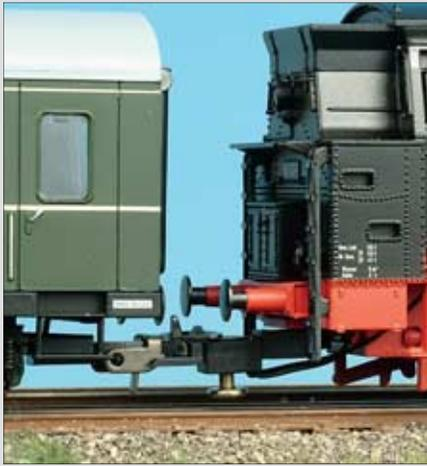
Die Spule der Kreis-Kupplung ist ausgeschaltet und der Bügel des Waggons eingehakt.
