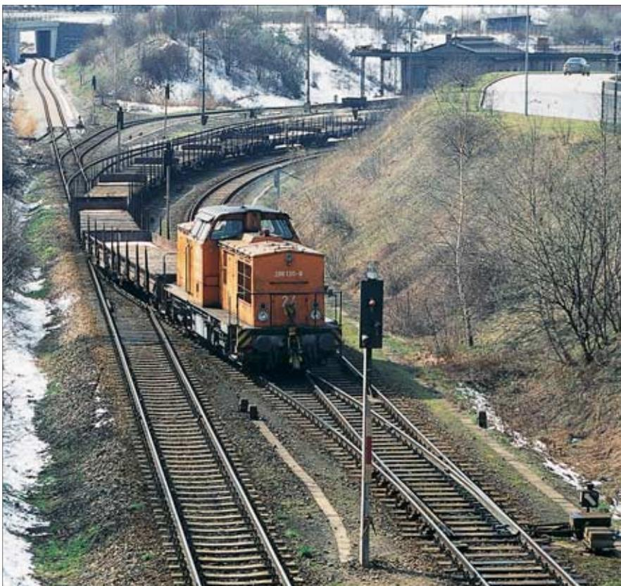
beiden Nebengleise. Um nun aber das Hauptgleis mit seinen Zugfahrten zu sichern, installierte man innerhalb der Gleisverbindung eine im einfachsten Falle handbetätigte, mithin mechanische Gleissperre. Da innerhalb dieser Bahnanlagen Züge weder begannen noch endeten und auch nicht kreuzten, war die Anzahl der Weichen und der angeschlossenen Nebengleise im Hinblick auf die Einordnung der Bahnanlage als „Haltestelle“ im Prinzip ohne Belang.
