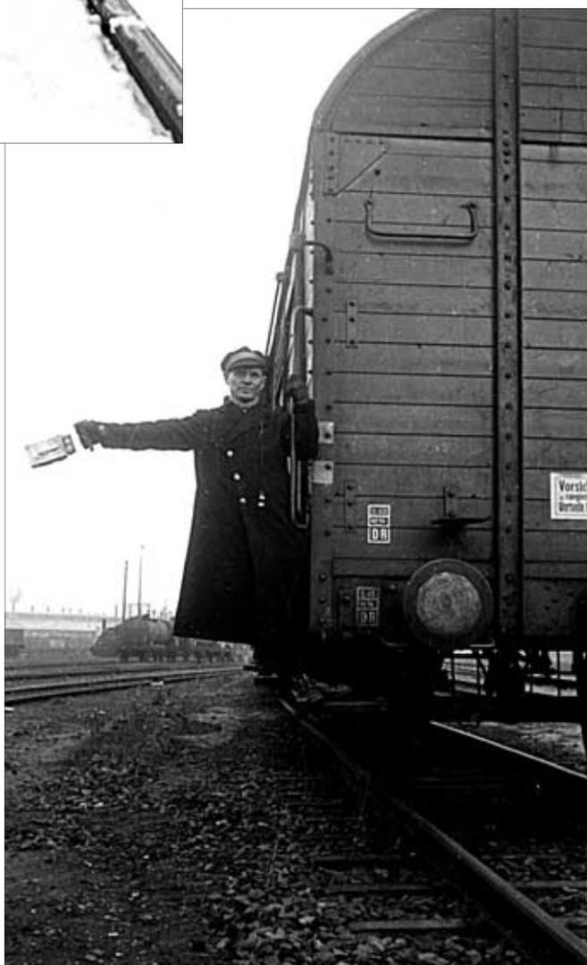
von oben nach unten. Die Bedeutung des Signales hat sich im Laufe der Jahre gewandelt. 1935 galt „Wegfahren“ nur für einzeln fahrende Lokomotiven, bei Rangierabteilungen bedeutete es „Ziehen“. Das alte, bis 1935 gültige **Signal 31** bedeutete „Vorziehen“, wobei dies für einzeln fahrende Lokomotiven als Auftrag mit dem Schornstein voran zu fahren galt.
