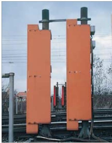
Dann ist es so weit: Die beiden holzbeladenen Wagen rollen den Eselsrücken herunter. Dabei passieren sie mehrere Sensoren wie diese Lichtschranke, die während der Dunkelphasen über Achszähler die vorgegebenen Daten auf Plausibilität überprüft.
