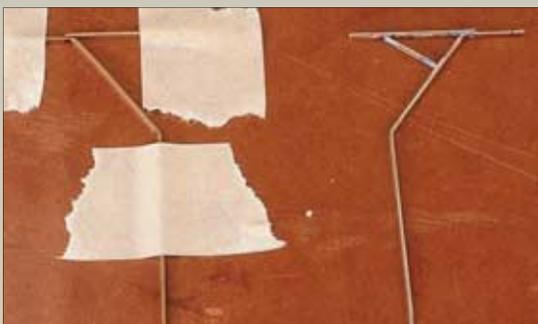
Das Zusammenlöten der Schablonen erfolgte wieder auf einem flachen Hartfaserklotz, der einigermaßen hitzebeständig ist. Hier können die feinen Messingprofile akkurat ausgerichtet und mit etwas Papierklebeband fixiert werden.
