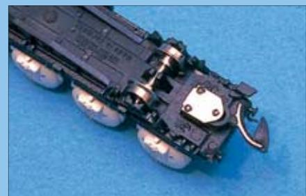
Mit Sekundenkleber wird der Magnetanker direkt auf der Unterseite der Z-Kupplung befestigt.
