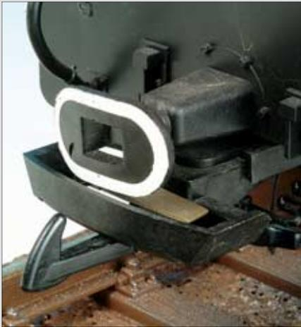
Eine Platte im Kupplungsbügel drückt eingekuppelte Haken herunter.
