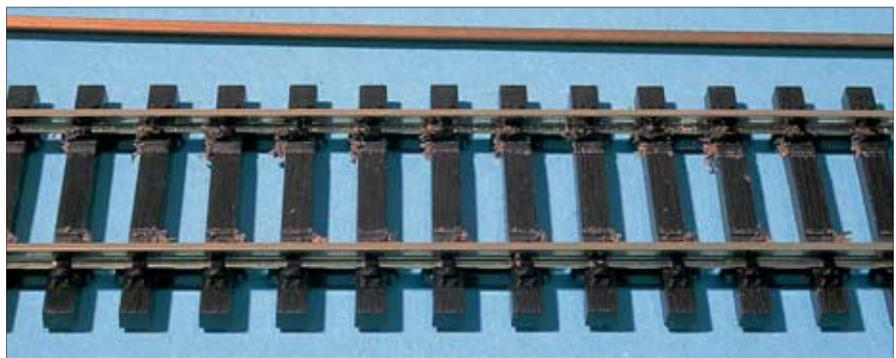
Um die U-Führungsschienen möglichst weit nach außen zu rücken zu können, wurden die Schienenplatten gekürzt.
