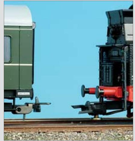
Die Lok rückt ab und der Decoder schaltet die Rangierkupplung aus.
