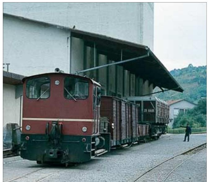
Das dazu erforderliche Triebfahrzeug kann die Fahrzeuggruppe (die ja keinen „Zugverband“ darstellt) sowohl ziehen als auch schieben oder „drücken“, wie der Eisenbahner sagt. Befindet sich die Lok in der Mitte zweier Fahrzeuggruppen (was man auch im Modell getrost so arrangieren kann), spricht man von einer geschobenen bzw. gedrückten Fahrzeuggruppe mit angehängten Fahrzeugen.
