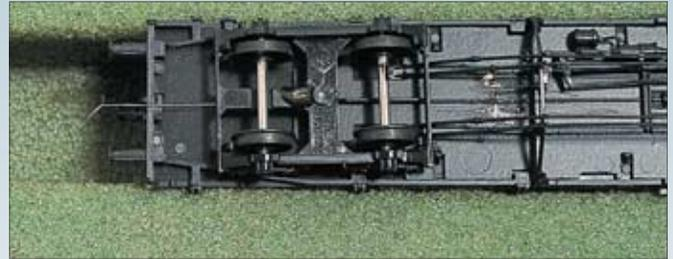
derpuffern können natürlich enger gekuppelt werden; hier ist die Ebene der eingedrückten Puffer das entscheidende Maß, aber je mehr Federweg man nutzt, desto eher werden insbesondere leichtere Fahrzeuge weggeschoben, bevor sich die Kupplung eingehakt hat, gerade, wenn die Puffer verhältnismäßig starke Federn haben wie z.B. die Liliput-Federpuffer.
