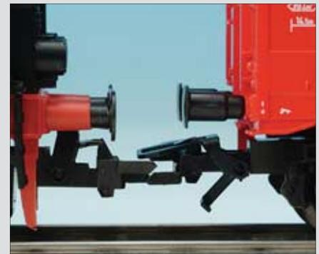
lungskopf für den Kurzkupplungsbetrieb ausgelegt. Auch sie drückt bei Betätigung eine Zunge nach oben, die den eingekuppelten Kupplungsbügel über das Niveau der Haltehakens hebt.
