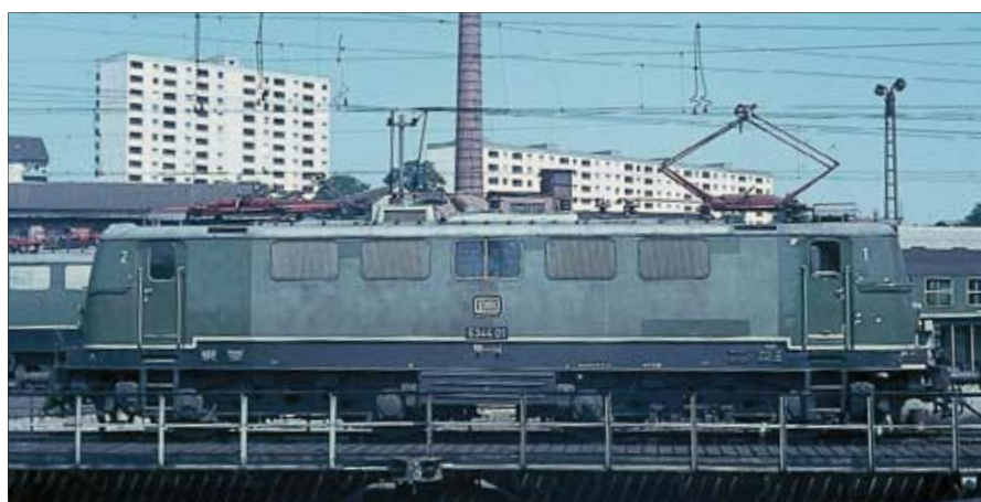
Noch keine Mehrsystemlok, aber die Basis für weitere Entwicklungen war die E 244 für die Höllentalbahn mit 50-Hertz-Wechselspannung. Foto: C. Bellingrodt/MIBA-Archiv Unten: Eine kuriose Einzelgängerin – die E 344 01 entstand aus dem Fahrwerk der E 244 21 und den Motoren der E 244 22. Foto: Oesterling/Archiv Michael Meinhold
