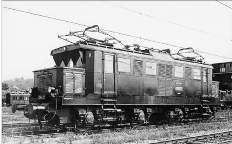
Noch keine Mehrsystemlok, aber die Basis für weitere Entwicklungen war die E 244 für die Höllentalbahn mit 50-Hertz-Wechselspannung. Foto: C. Bellingrodt/MIBA-Archiv Unten: Eine kuriose Einzelgängerin – die E 344 01 entstand aus dem Fahrwerk der E 244 21 und den Motoren der E 244 22. Foto: Oesterling/Archiv Michael Meinhold
