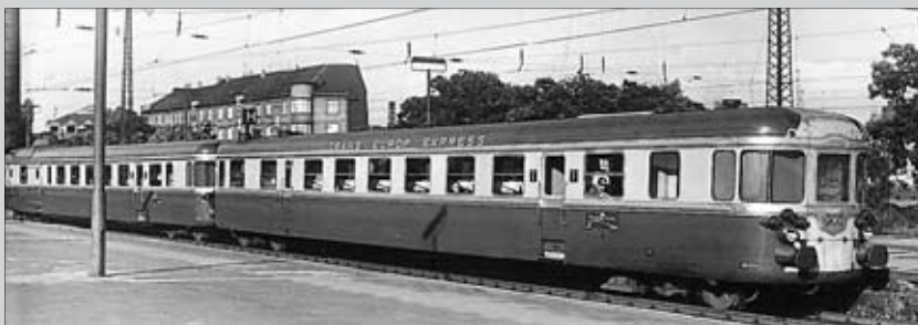
Nach der Zwischenlösung der umgebauten RGP 825 beschaffte die SNCF die X 2771 bis 2781 nebst Steuerwagen X 7771 bis 7779 als Neubaufahrzeuge.
