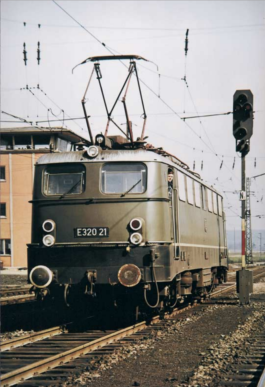
Die von Krauss-Maffei und SSW gebaute Versuchslok E 320 021 für den grenzüberschreitenden Verkehr nach Frankreich. Der gegenüber der Regelausführung des DBS 54 deutlich schmalere Pantograph ist hier gut zu erkennen. Foto: Sammlung Brian Rampp
