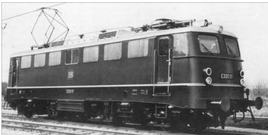
Oben: Die E 320 01 unterscheidet sich in ihren Hauptabmessungen durch eine um 50 mm geringere LüP und einen um 225 mm niedrigeren Lokkasten von der E 10. Foto: MIBA-Archiv
