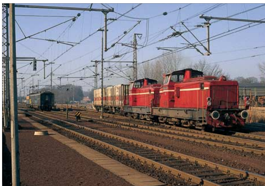
Unten: NS-1145 mit Güterzug an der Grenze bei Gildehaus, 7.3.1992. Gut zu erkennen: die Oberleitung mit dem an Auslegern befestigten Verstärkungsseil. Fotos: Rolf Köstner
