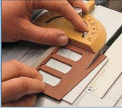
Auf der Proxxon-Tischkreissäge werden die Teile exakt rechtwinklig bearbeitet – wichtig für den geraden Verlauf der Wand!
