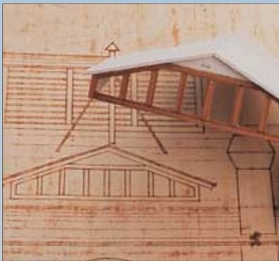
Eine Dachgaube bringt Licht in die Schmiede. Sie ist aus feinen Leisten und 1-mm-Polystyrol-Platten verleimt.
