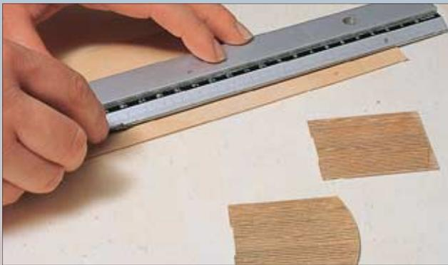
Die Schuppentore werden aus 1 mm dünnem Birken-Sperrholz gefertigt. Die Bretterfugen werden mit einem Trennwerkzeug aus dem Schneiderbedarf eingeritzt.
