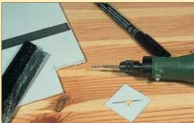
Die Podestplatte für den Kran entsteht aus einer Kunststoffplatte. Die Bohrung nimmt den Drehzapfen des Krans auf.
