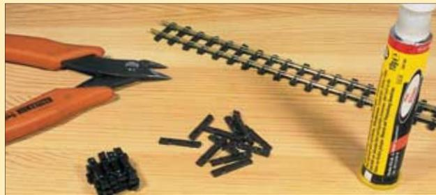
Aus nicht benötigten Schwellenbändern gewinnt man einzelne Schwellen, entfernt das Kleinen und türmt sie zu Blöcken auf.
