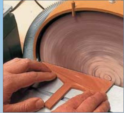
Feinkörniges Schleifpapier auf der Teller-schleifmaschine von Proxxon gibt der Kante eine präzise Schärfe.
