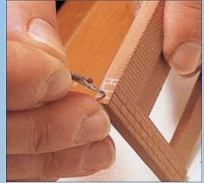
Nach dem Abgießen erhalten die äußeren Wandteile an den Kanten noch eine Mauerfugenstruktur eingritz.
