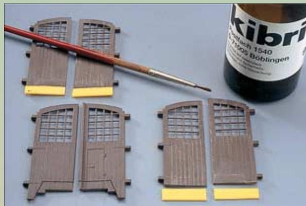
Die Tore wurden nach unten mit einem Kunststoffstreifen verlängert, sodass sie bis zur Schienenoberkante reichen, und anschließend mit feinen Balsastreifen beklebt. Unten: Das Einfärben erfolgte mit stark verdünnter Lackfarbe.
