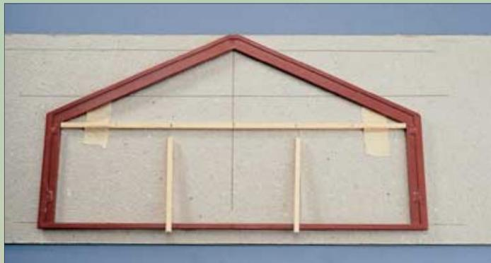
Der Originaldachträger wird mit einem Längsträger und zwei Stützen aus hölzernen Vierkanteleisten ergänzt. Die Leisten werden zuerst exakt rechtwinklig ausgerichtet und dann mit Klebeband fixiert.
