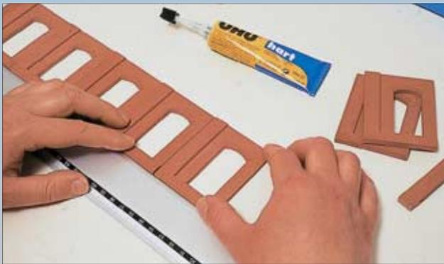
Mit Uhu-Hart werden die Teile der Seitenwand aneinander geklebt. Ein Aluminiumlineal bildet quasi die „Maurerrichtschnur“ und sorgt für gleiche Höhenlage der Elemente.
