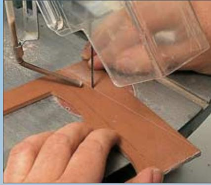
Mit einer Dekupiersäge wird der überflüssige Teil der Wand abgetrennt. Dies gilt auch für den Pfeiler in der Mitte.
