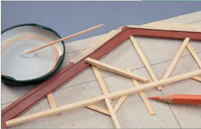
Geklebt wurde hier mit Weißleim. Bei den diagonalen Streben wurde ein Holzstreifen untergelegt, damit das Ganze beim Beschweren mit Eisenstäben plan liegen bleibt.
