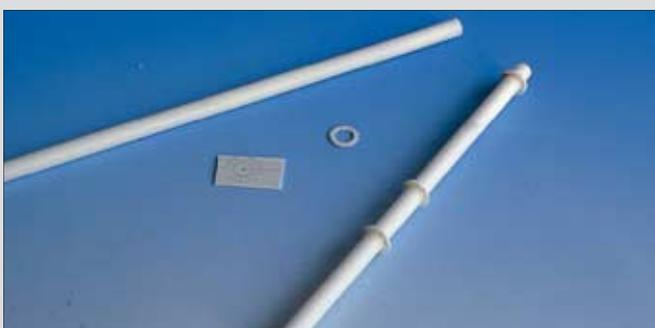
**Der Blechschlot besteht aus dem Kunststoff-Rohrstück (hinten) und den aus Plattenresten (Mitte) zugeschnittenen Flanschen.**
