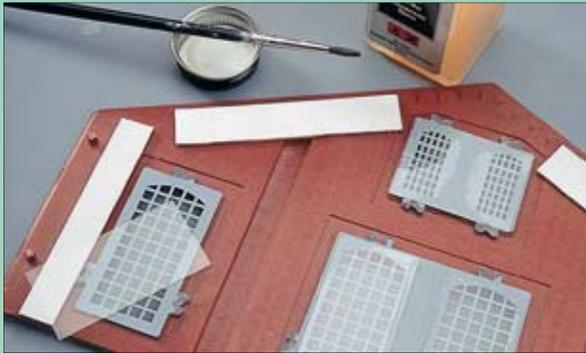
Für die Fenster wurde dünne Folie verwendet, wie sie den meisten Faller-Bausätzen beiliegt. Sie ist nicht so dick wie die in dem Bausatz vorhandenen Fensterteile. Gelebt wurde hier mit Klarlack.
