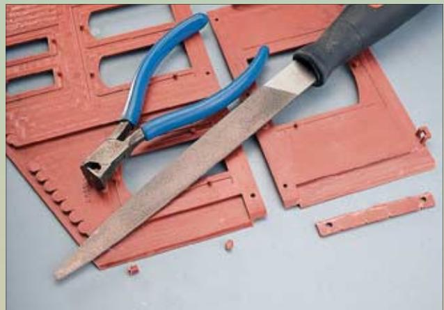
Mit einer Feile und feinem Schleifpapier werden die Kanten begradigt. Eventuell mit Klebstoff gefüllte Fugen lassen sich mit einer Reißnadel nachgravieren.
