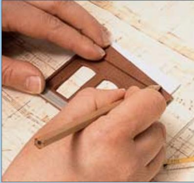
In gleicher Weise entstehen die Seitenwände: Aus Kibri-Wandteilen werden passende „Rohlinge“ angezeichnet.
