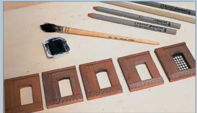
Das Einfärben der Mauern erfolgt in mehreren Schritten (von links nach rechts): gegossenes Mauerteil, Auslegen der Fugen, Einfärben der Ziegel, Setzen von Lichtern, Altern.
