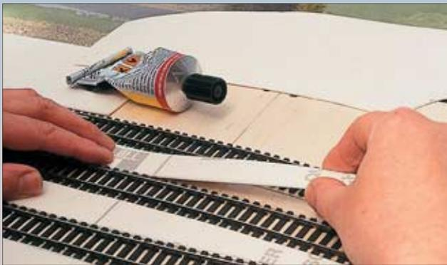
Im Bw-Gelände reichen Sand und Schotter oft bis an die Schienenoberkante heran. Zur Auffütterung der Zwischenräume wurden daher Streifen von PVC-Fußbodenresten verlegt.
