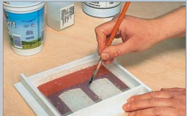
Bei Anrühren der Abformmasse mit dem Vernetzungsmittel entstehen unweigerlich Blasen. Mit einem Pinsel wird daher sorgfältig darauf geachtet, dass keine Blasen direkt am Urmodell haften.
