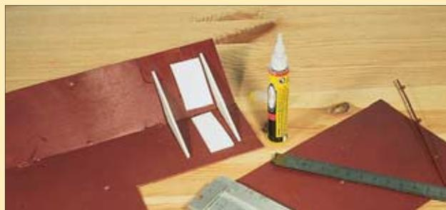
Das abnehmbare Dach besteht aus strukturierten Kunststoffplatten, die mit binderartigen Teilen (weiße Dreiecke) zusammengehalten werden.
