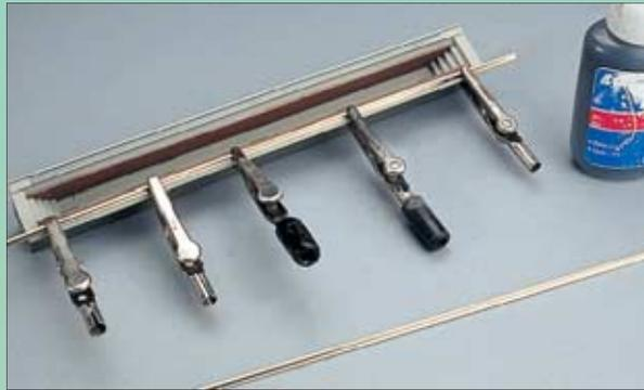
Etwas Sekundenkleber verklebt die Schienenprofile ausreichend mit dem Kunststoff. Das dem Bausatz beiliegende Profil wurde gegen ein Code-83-Gleisprofil getauscht, das erheblich schlanker wirkt.
