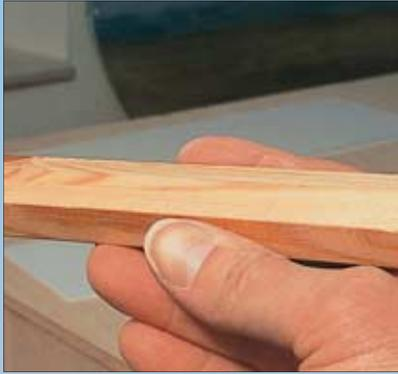
Die Firstpfette ist im Winkel der Dachneigungen gefräst. So können die Dachplatten flächig aufgeklebt werden.
