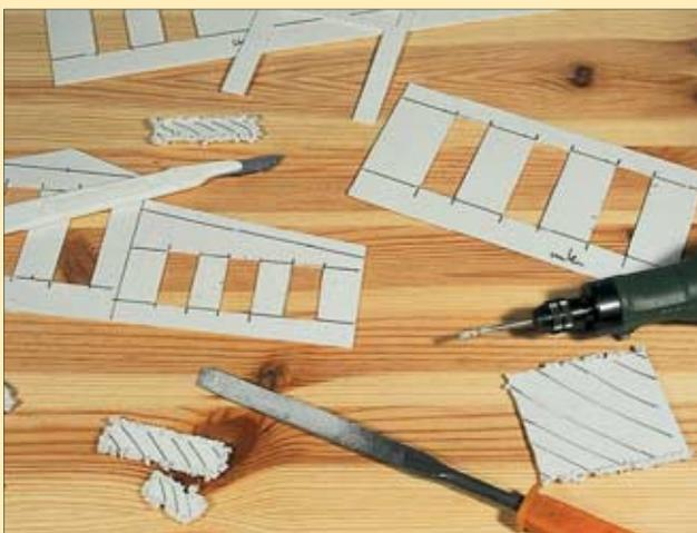
Nach dem Anzeichnen der Wandformen auf strukturierten Kunststoffplatten schneidet man sie mit Messer und Fräse zu. Glatte, gerade Kanten erreicht man durch sorgsames Befeilen.
