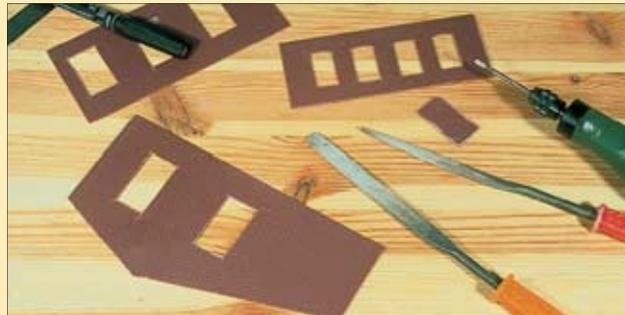
Die Wandteile werden aus Strukturplatten zugeschnitten. Fenster- und Türöffnungen entstehen grob mit der Fräse. Mit Feilen werden sie danach geglättet.
