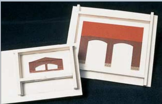
Die fertigen Urmodelle werden in Formkästen aus Kunststoffleisten eingelegt. Bei den Kästen genügen eine Höhe von ca. 2 cm und ein Abstand von ca. 1,5 cm zu den Urmodellen.
