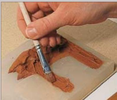
Ebenso muss beim Einfüllen der Masse in die fertige Form auf Blasenfreiheit geachtet werden. Dann erst wird die Form mit einem Spachtel glatt abgezogen.
