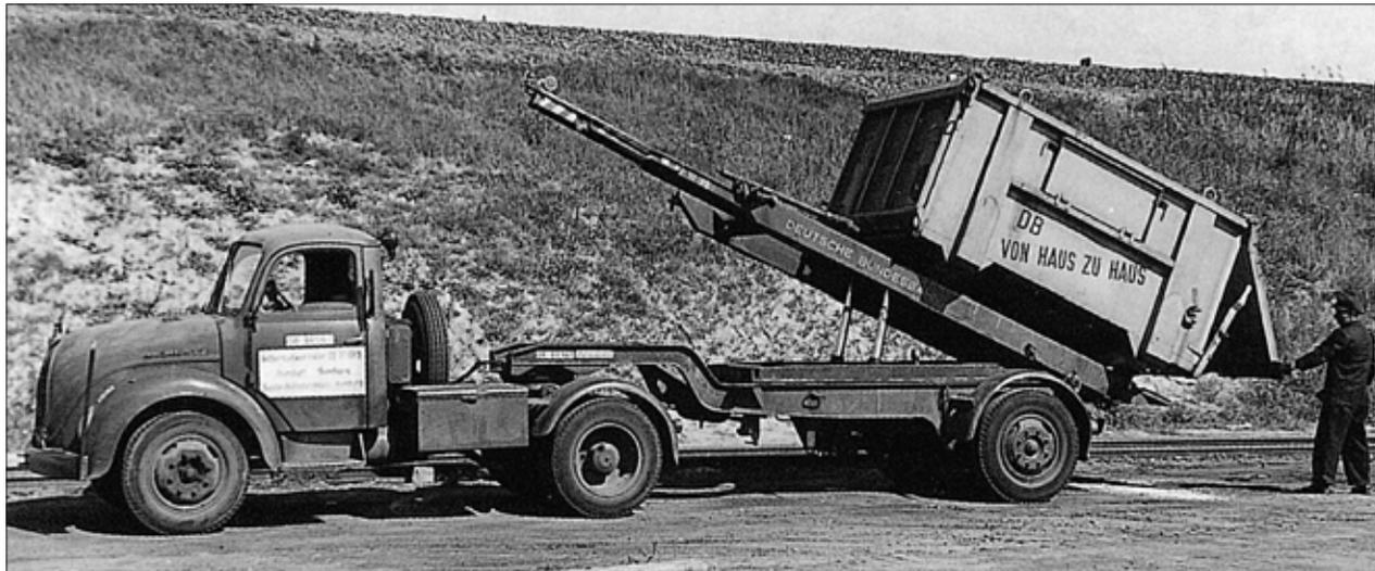
ge Eigengewicht des Fahrzeugs von nur 6 t führte jedoch dazu, dass der Wagen nur mit aufgesetzten Behältern verkehren durfte.
