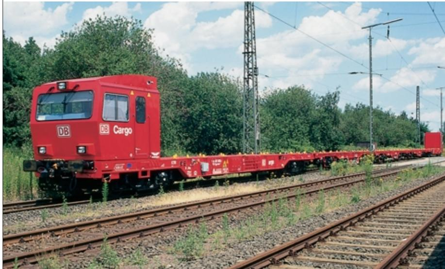
Selbst angetriebene Transporteinheiten wie der „CargoSprinter“ basieren auf Containertragwagen, die motorisiert und mit Führerhäusern ausgestattet wurden. Unten: Problemlos können die dieselgetriebenen Züge auch direkt unter Containerkräne fahren, um beladen zu werden.
