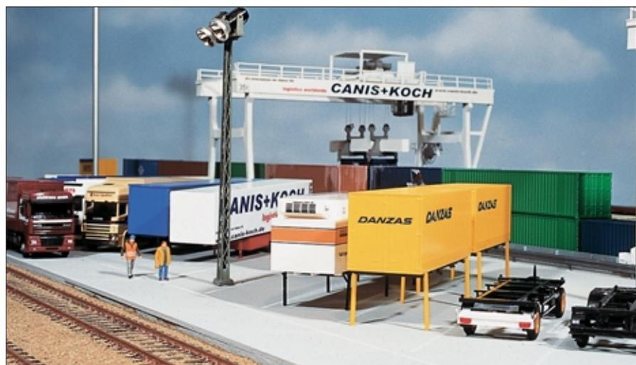
Lager- und Parkflächen für Container und Sattelaufleger sollten auf keinem Terminal fehlen. Wechselbrücken sind nicht stapelbar, stehen aber auf Stützfüßen, die von den Chassis der LKW-Zugmaschinen unterfahren werden.
