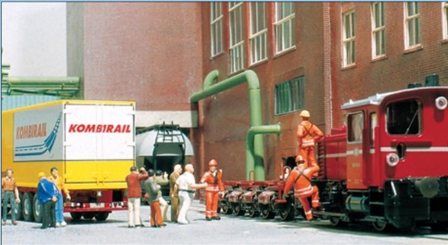
Für das Zusammenstellen des Trailerzuges beim Kombirail-System wird als Erstes ein Enddrehgestell mit einer Lok bereitgestellt.
