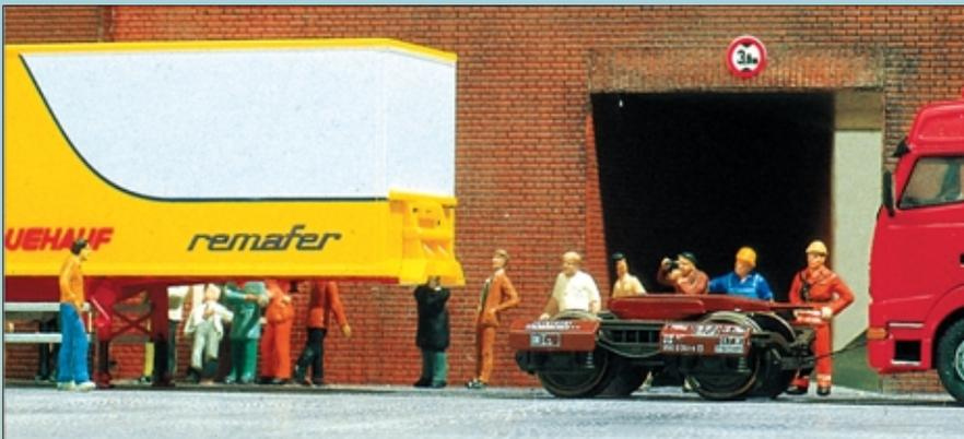
Links: Nachdem die Stützfüße heruntergekurbelt wurden, kann die Zugmaschine absatteln und die Achsen des Trailers an den Unterboden durch Entleeren der Luftfederungsbalgen angelegt werden.
