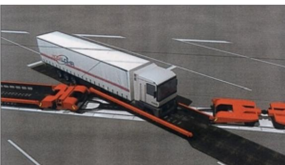
Oben: Beim ModaLohr-System können die Ladeflächen der Taschenwagen seitlich ausgedreht werden, so dass es möglich wird, diese von außen zu befahren. Nach dem Wiedereindreuen ruht der Auflieger dann zwischen den Drehgestellen. Grafik: Lohr
