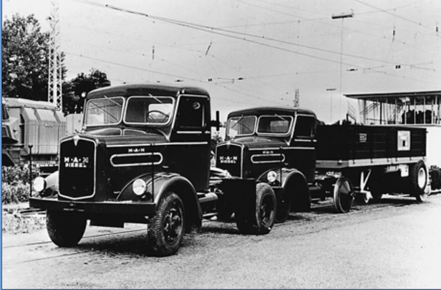
Früher Versuch: 1953 wird auf der Verkehrsausstellung in München ein Zweiwege-Sattelschlepper gezeigt. Vorn die Straßenfahrt-Zugmaschine, dahinter das Schienenfahrzeug.
