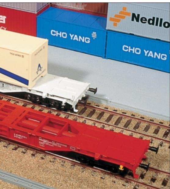
Sechssachsige Tragwagen mit Jacobsdrehgestell (rechts oben) gibt es bei Roco mit unterschiedlichen Eigentumsbezeichnungen im H0-Sortiment. Auch in TT gibt es eine breite Palette an Tragwagen von Tillig, die unterschiedlich beladen sind (unten).
