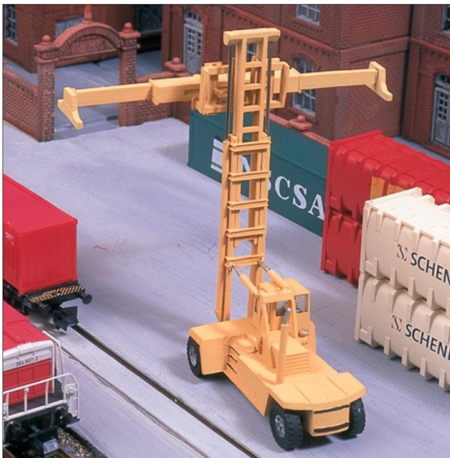
Die Hubstangen am oberen Ende des Hydraulikliftes bestehen aus Federstahldraht.
