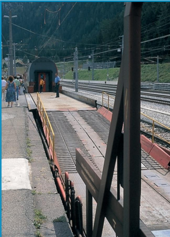
Der Autotransportzug ist in Mallnitz eingetroffen. Die Autos verlassen über den Rampenwagen und den Auf- und Abfahrtswagen den Zug. Am Zugende der Doppelstockwagen für die Autopassagiere, denn diese dürfen während der Fahrt durch den Tunnel nicht mehr in ihren Fahrzeugen bleiben.
