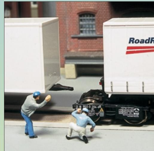
Oben: Der nächste Auflieger wird mit dem Heck auf ein festgebremstes Zwischendrehgestell geschoben. Der so aufgegleiste Trailer wird dann mit dem Heck an den zuvor aufgegleisten Trailer geschoben, sodass die Kupplungszunge in den Kupplungsmund im Heck des Aufliegers auf dem Zwischendrehgestell greift.
