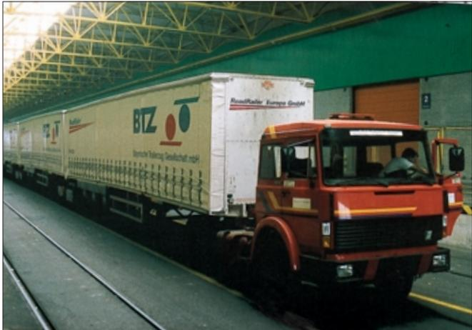
Ein Kühlaufleger der BTZ. Von einem normalen Sattelaufleger unterscheidet er sich vor allem durch den verstärkten Rahmen, der ihn für den Eisenbahnbetrieb tauglich macht. Oben rechts: Die einzelnen Auflieger werden rückwärts mit einer Sattelzugmaschine auf die Drehgestelle geschoben und zu einem Zug zusammengestellt. Fotos: BTZ
