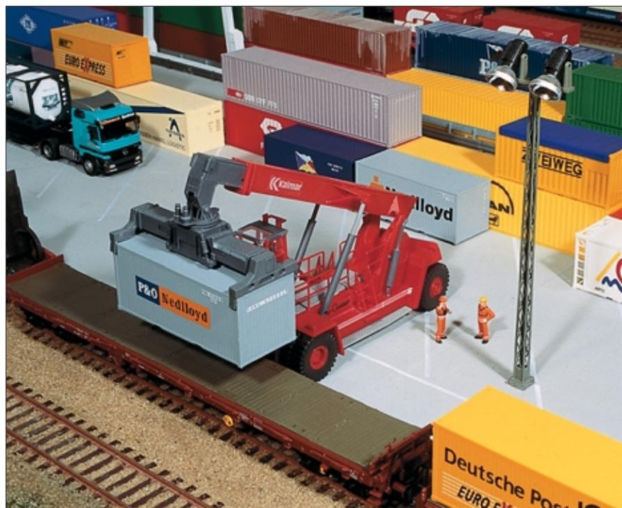
Mobile Umschlaggeräte sind die Alternative zu großen Kränen. Sie sind ebenfalls mit „Spreadern“ ausgerüstet und lassen sich auf die verschiedenen Containergrößen und -formen einstellen. Sie fahren zur Beladung seitlich an Tragwagen heran.
