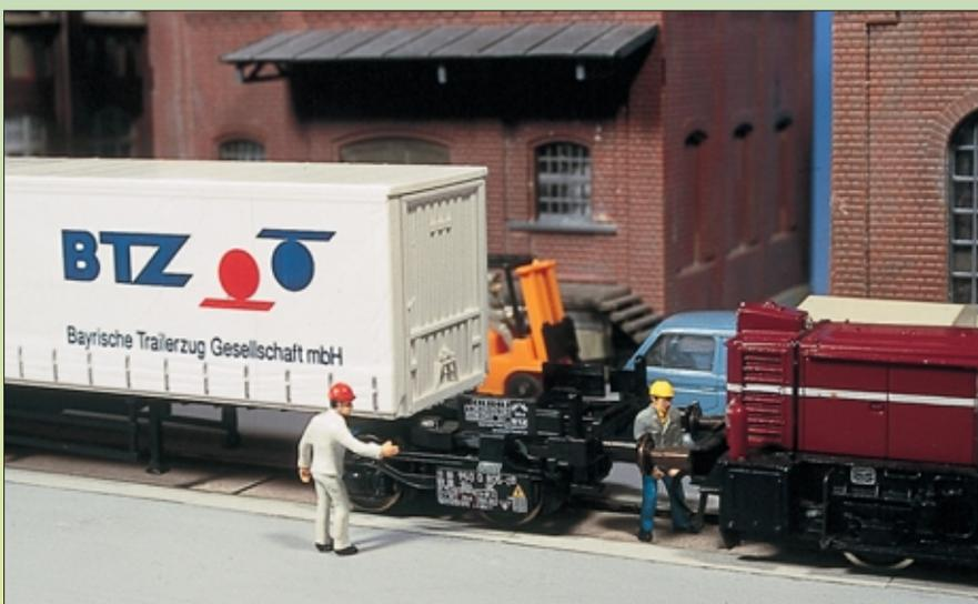
Nachdem unter die Frontpartie des im Zugverband als Erster laufenden Trailers ein Enddrehgestell geschoben wurde und alle Brems- und elektrischen Leitungen angeschlossen wurden, kann der Zug von einer Lokomotive geholt werden.
