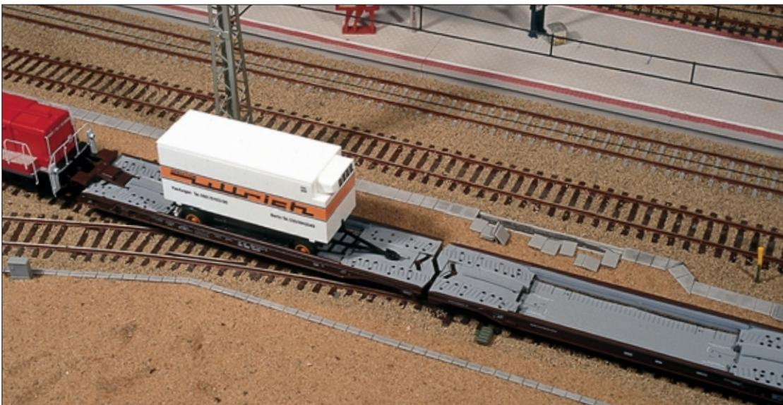
Niederflur-Wippenwagen, wie das H0-Modell von Roco (oben), können auch Container aufnehmen, wenn sie mit speziellen Ladebrücken ausgerüstet sind.
