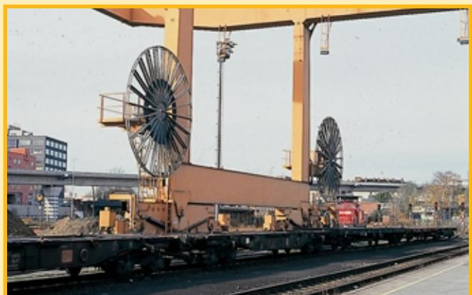
Die Antriebe für die Fortbewegung der Kräne sind recht groß und ruhen auf mehreren Rädern. Über große Kabeltrommeln wird die Stromversorgung gewährleistet. Das Karussell über dem Container (links) enthält den Antrieb und ermöglicht eine Bewegung um 360 Grad.
