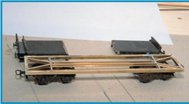
Das Fahrwerk des Auf- und Abfahrwagens entsteht aus Messingprofilen.
