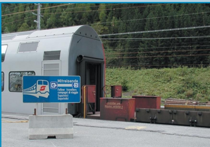
Zudem wurden die Doppelstockwagen wegen der ungewissen Zukunft der Autoschleuse nicht auf die automatische Kupplung umgebaut, sodass auch noch Rangierpersonal zum Ab- und Anhängen der Zuglok erforderlich ist. Dieser erhebliche Mehraufwand hat die Taktdauer der Autoschleuse auf ca. eine Stunde verlängert, während früher in Spitzenzeiten im Abstand von 15 Minuten gefahren werden konnte.
