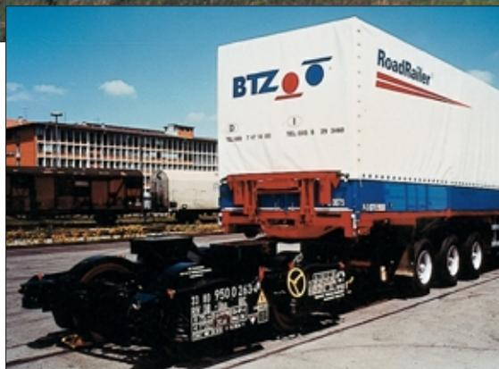
Bimodale Trailer werden auf die Drehgestelle einer Zugmaschine geschoben. Hier ist das Heck eines Trailers mit dem Kupplungsmund und dem hochgeklappten Unterfahrerschutz vor einem Zwischendrehgestell zu sehen. Spezielle Enddrehgestelle, die mit normalen Zug- und Stoßeinrichtungen ausgestattet sind, stellen den Übergang zum normalen Bahnbetrieb her (unten). Foto: BTZ
