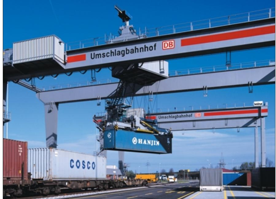
Containerkräne können erhebliche Ausmaße annehmen, wenn sie mehrere Gleise, Lade- und Fahrspuren sowie Lagerflächen überspannen müssen. Auf dem Bild ist deutlich zu erkennen, wie der Container an seinen oberen Eckbeschlägen angehoben wird. Wechselbehälter und Sattelaufleger müssen über Greifzangengeschirre von unten angehoben werden, wenn sie vertikal umgeschlagen werden sollen. Fotos: DB AG
