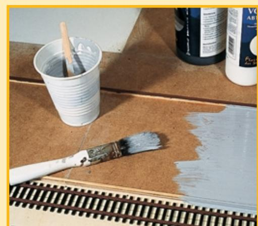
Spalten zwischen den Untergrund-Holzplatten wurden verspachtelt und glatt geschliffen. Graue Farbe macht dann aus der Holzoberfläche eine Betonimitation.
