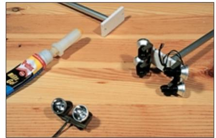
Die Scheinwerfer bekommen neue Masten aus Aluminiumrohr. 2-mm-Polystyrolplättchen bilden die Halterung für die Traversen der Doppelstrahler, welche in kleine Bohrungen eingeklebt werden.
