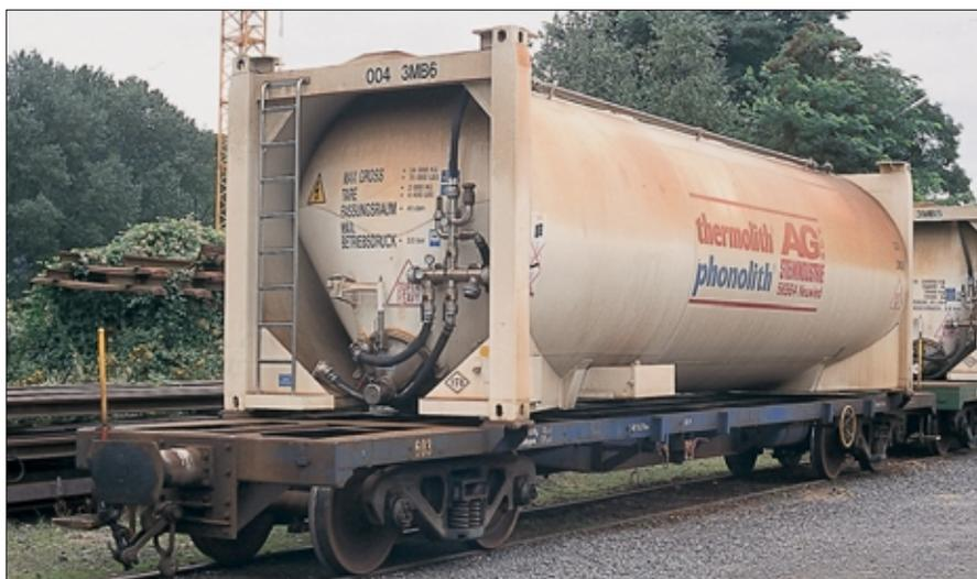
Containertransport auf Schmalspurgleisen findet im Brohltal statt. Das in einem Steinbruch gewonnene Thermolith wird in Spezialcontainer gefüllt und nach Brohl gefahren. Der Umschlag auf den LKW erfolgt in Brohl mit einem mobilen Ladegerät. Foto: sk
