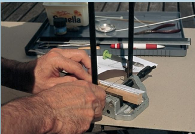
Messingprofile und vorbereitete Spantenteile auf dem 1:1-Ausdruck der per CAD-Software am PC erstellten Zeichnung. Das Ablängen der Profile erfolgt dann direkt an einer provisorischen „Schablone“ aus einer Holzleiste mit der aufgeklebten Zeichnung – simpel, aber hinreichend genau.
